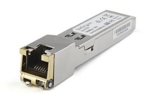
Der SFP1GTEMCST ist ein Dell EMC SFP-1G-T-kompatibles Kupfer SFP-Transceiver-Modul, das für den Einsatz mit Dell EMC™ Marken-Switches und -Routern entwickelt, programmiert und getestet wurde. Es sorgt für zuverlässige 1 GbE-Konnektivität über Kupfer-Kabel für 1000BASE-T -konforme Netzwerke mit einer maximalen Entfernung von bis zu 100m.
