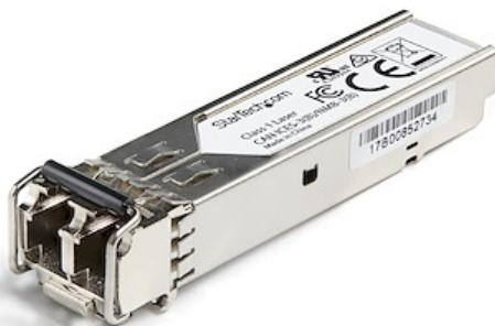
El modelo CTPSFP1GETST es un módulo transceptor SFP por cobre compatible con el modelo CTP-SFP-1GE-T de Juniper diseñado, programado y probado para su funcionamiento con routers y switches de la marca Juniper®. Ofrece conectividad confiable a 1 GbE, a través de cable de cobre, para redes compatibles con 1000BASE-T, a una distancia máxima de hasta 100 m.
