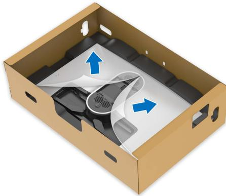
6. Schieben Sie die Laschen am Ständer in die Schlitzte an der hinteren Abdeckung des Monitors und senken Sie den Ständer ab, um ihn einrasten zu lassen.
