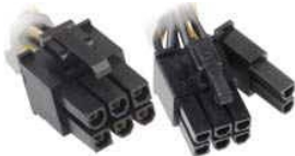
PCIe Power mit 6 und 6+2 Pins
