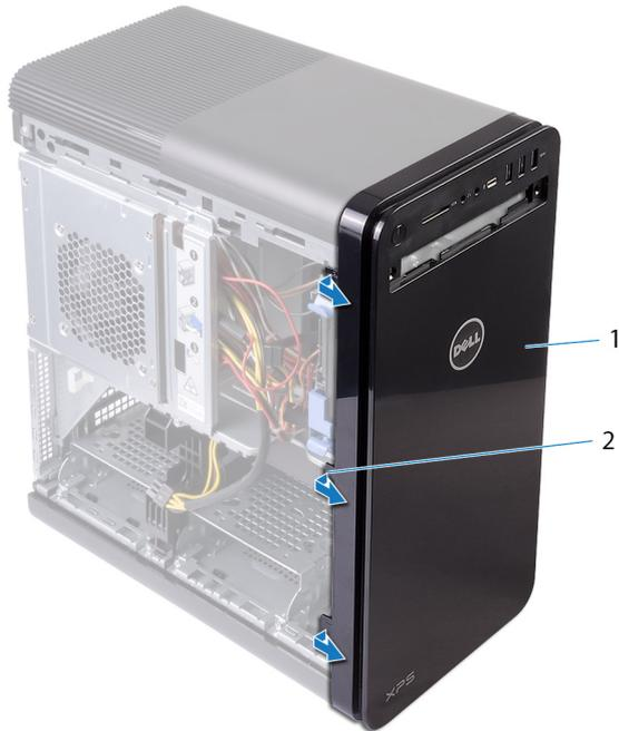
**Abbildung 3. Entfernen der Frontverkleidung**
