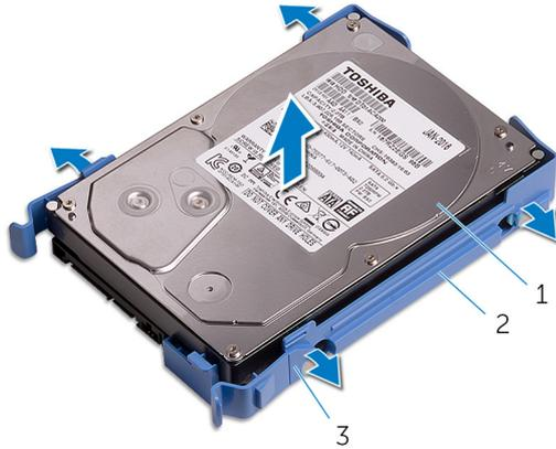
**Abbildung 14. Entfernen der Festplatte aus der Halterung**
