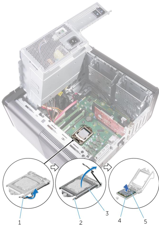
**Abbildung 36. Entfernen des Prozessors**
