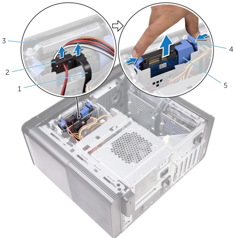
**Abbildung 13. Entfernen der Festplattenbaugruppe**
