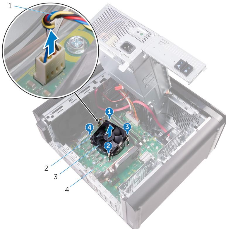
**Abbildung 33. Entfernen von Prozesslüfter und Kühlkörper**
