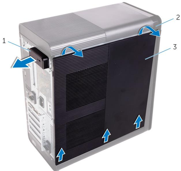
**Abbildung 1. Entfernen der rechten Abdeckung**
