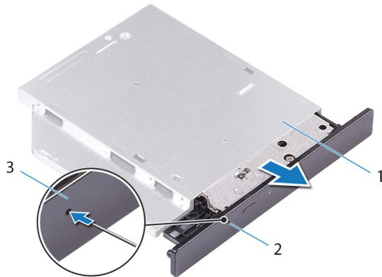
**Abbildung 8. Entfernen der Blende des optischen Laufwerks**
