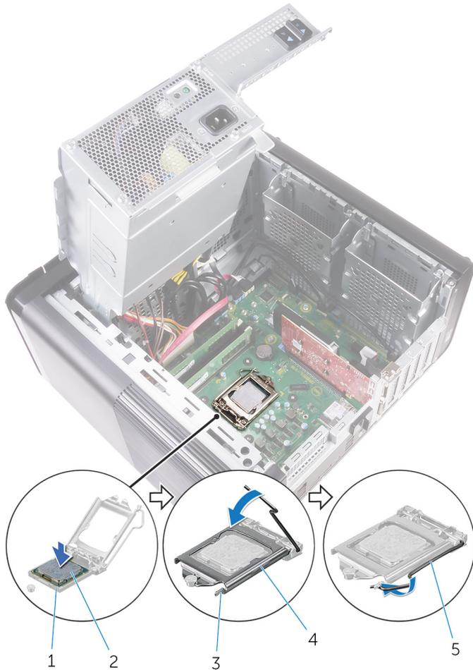
**Abbildung 37. Ersetzen des Prozessors**
