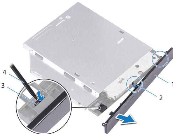
**Abbildung 9. Entfernen der Blende des optischen Laufwerks**
