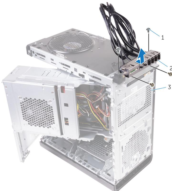
**Abbildung 28. Entfernen der USB-Leiste**
