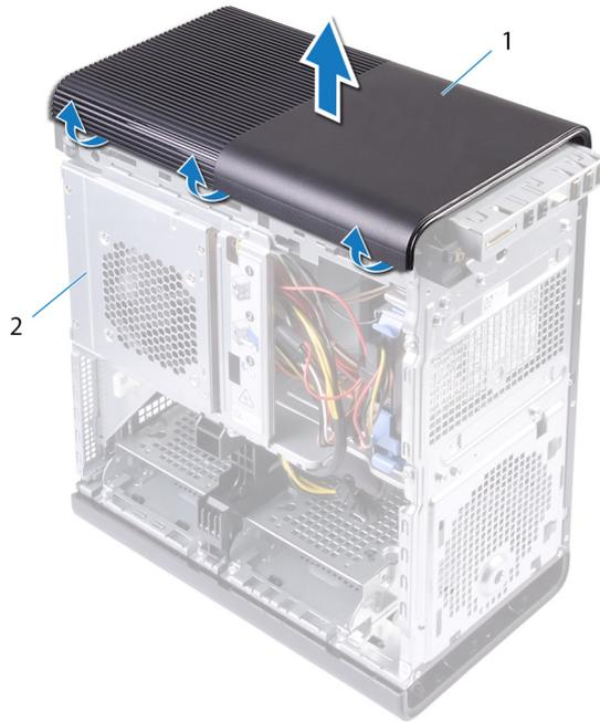
**Abbildung 10. Entfernen der oberen Abdeckung**
