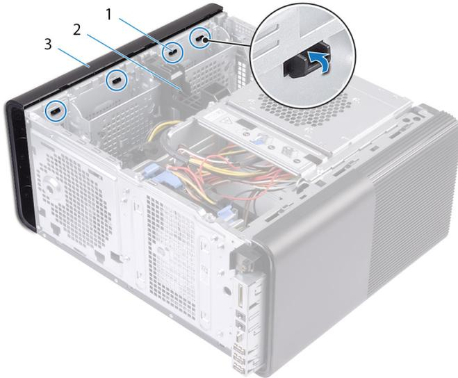
**Abbildung 11. Entfernen der unteren Abdeckung**
