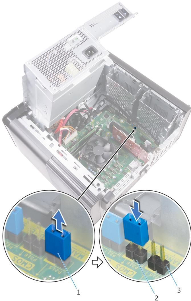
**Abbildung 43. CMOS löschen**
