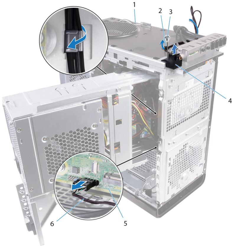
**Abbildung 26. Trennen des Kabel des Betriebsschaltermoduls**
