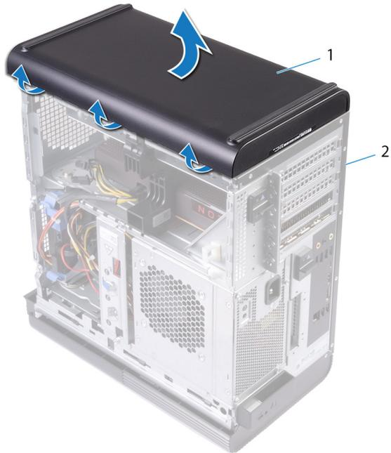
**Abbildung 12. Entfernen der unteren Abdeckung**
