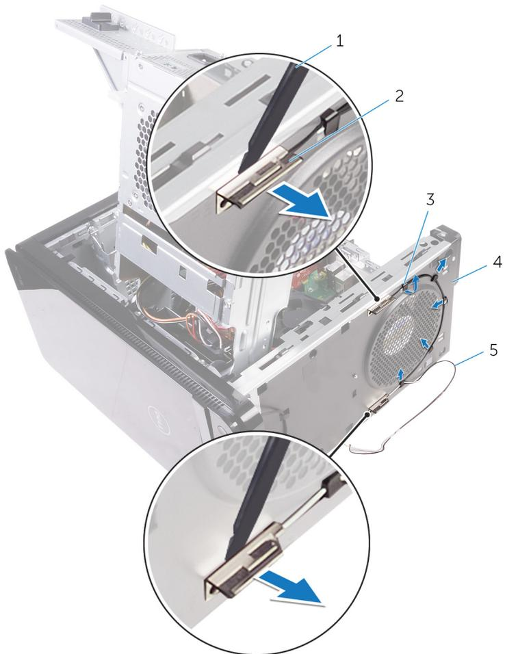
**Abbildung 41. Entfernen der Antenne**
