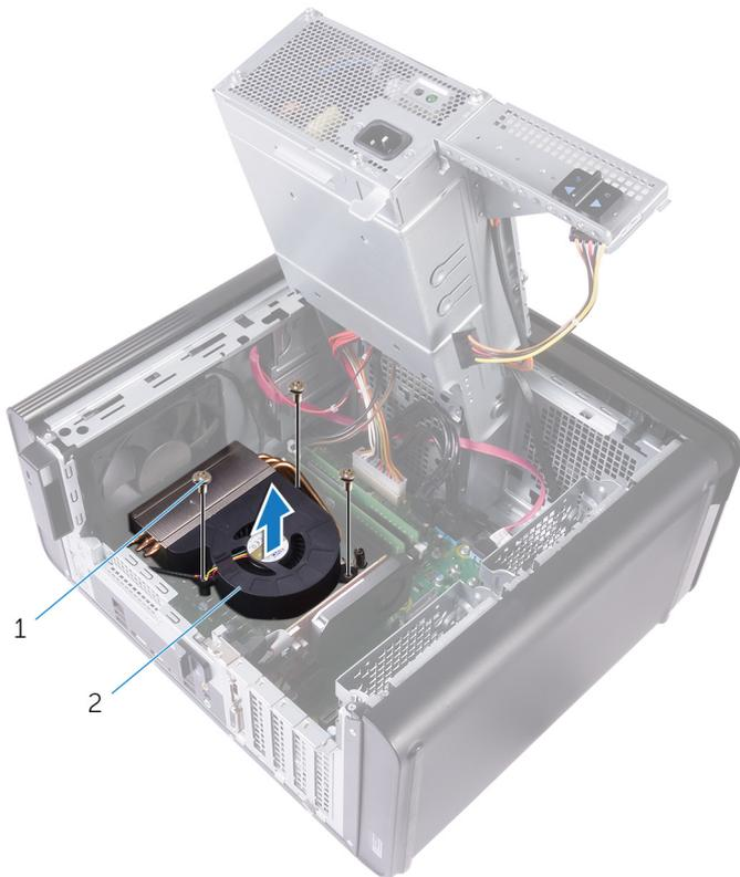
**Abbildung 29. Entfernen des Gebläses**
