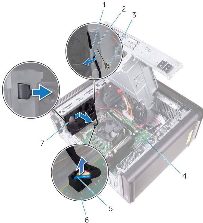
**Abbildung 34. Entfernen des Gehäuselüfters**
