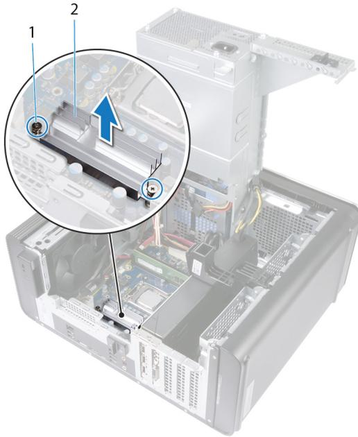
**Abbildung 32. Entfernen des VR-Kühlkörpers**
