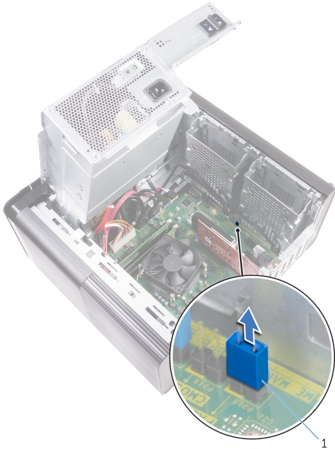
**Abbildung 44. Entfernen des Jumper-Steckers**
