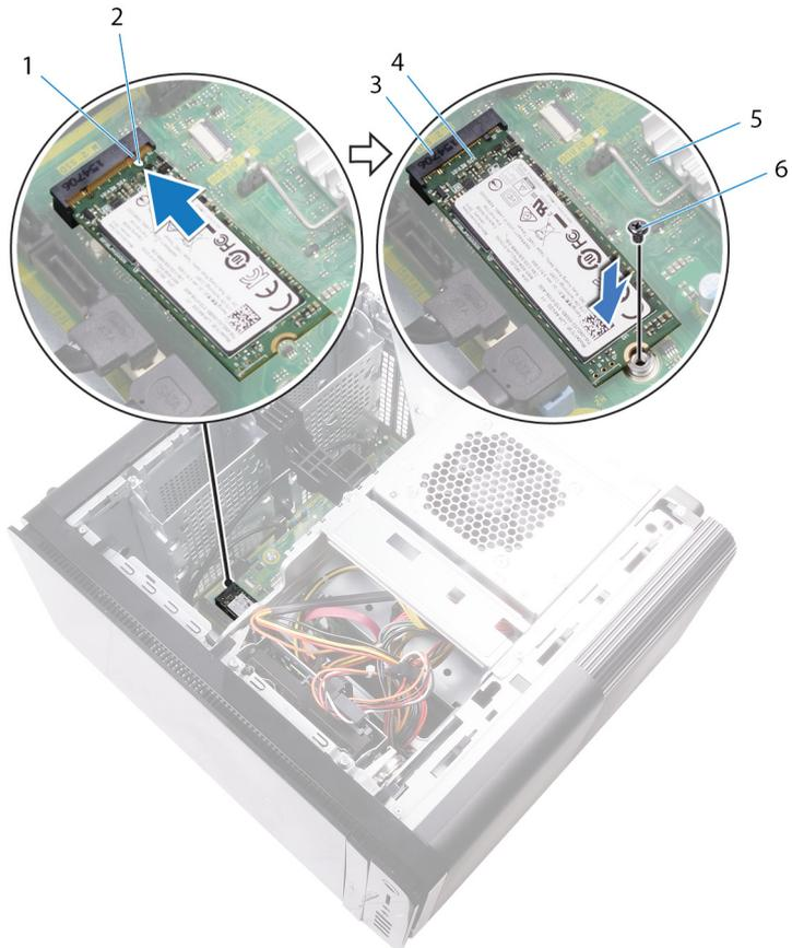
**Abbildung 16. Wiedereinbauen des SSD-Laufwerks**
