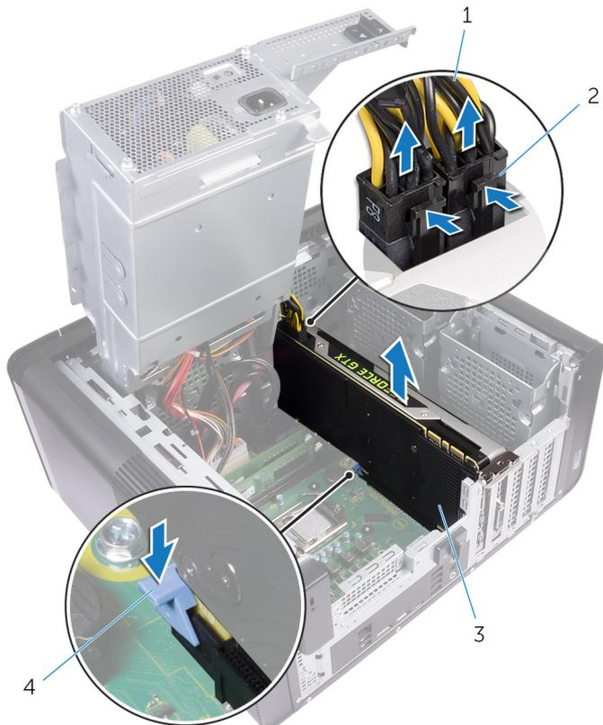
**Abbildung 23. Entfernen des Netzkabels**
