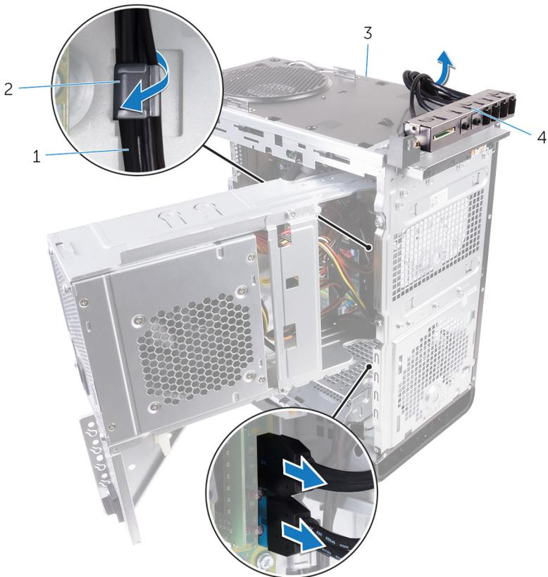
**Abbildung 27. Trennen der Kabel**
