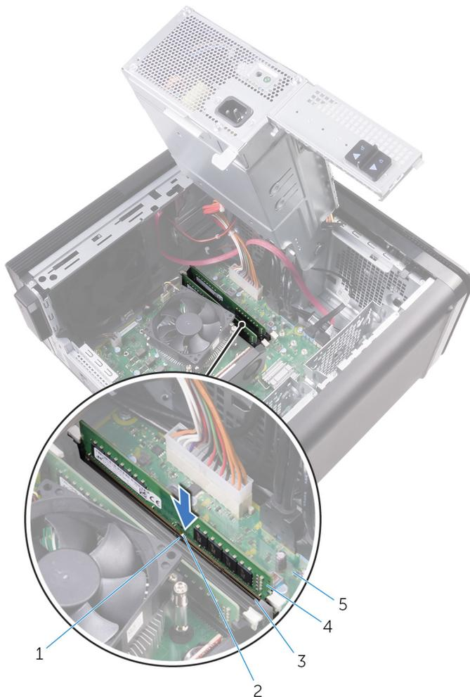
**Abbildung 25. Austauschen des Speichermoduls**
