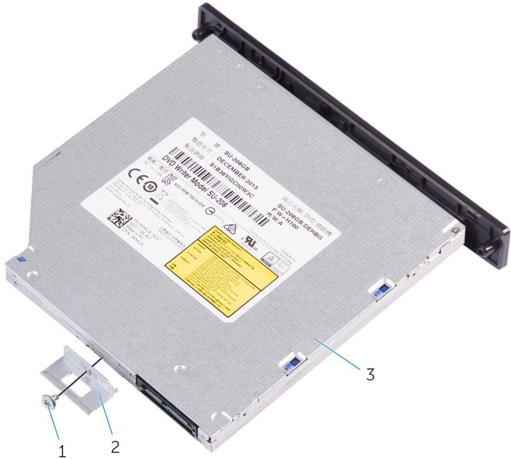
**Abbildung 7. Entfernen des optischen Laufwerks**
