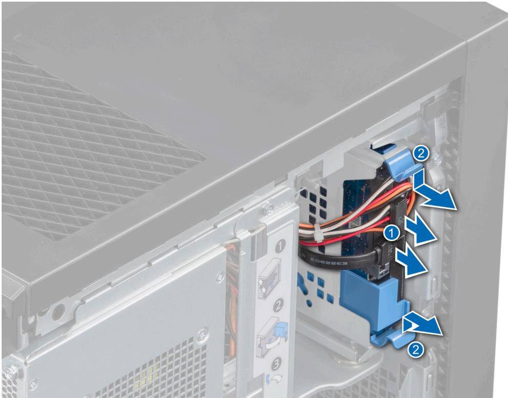
Ilustración 14. Extracción de un portaunidades de disco duro
