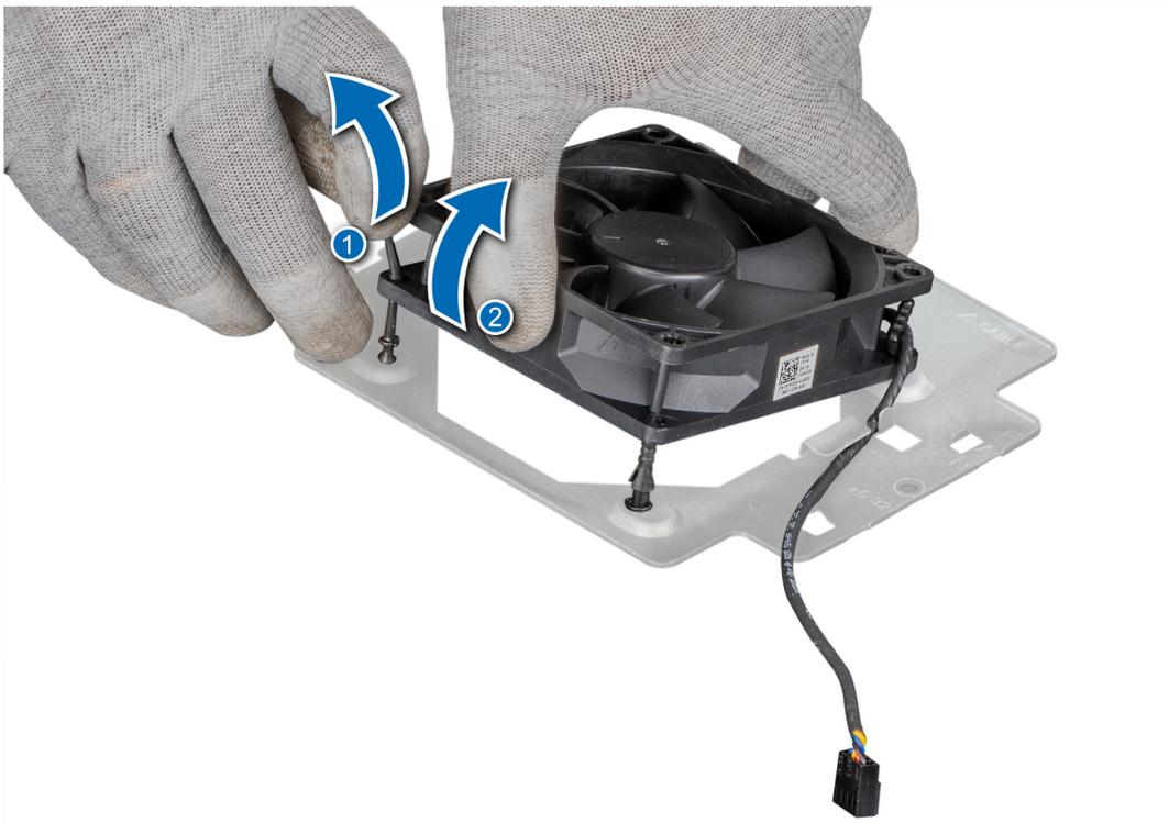
**Ilustración 38. Extracción del ventilador del sistema**
