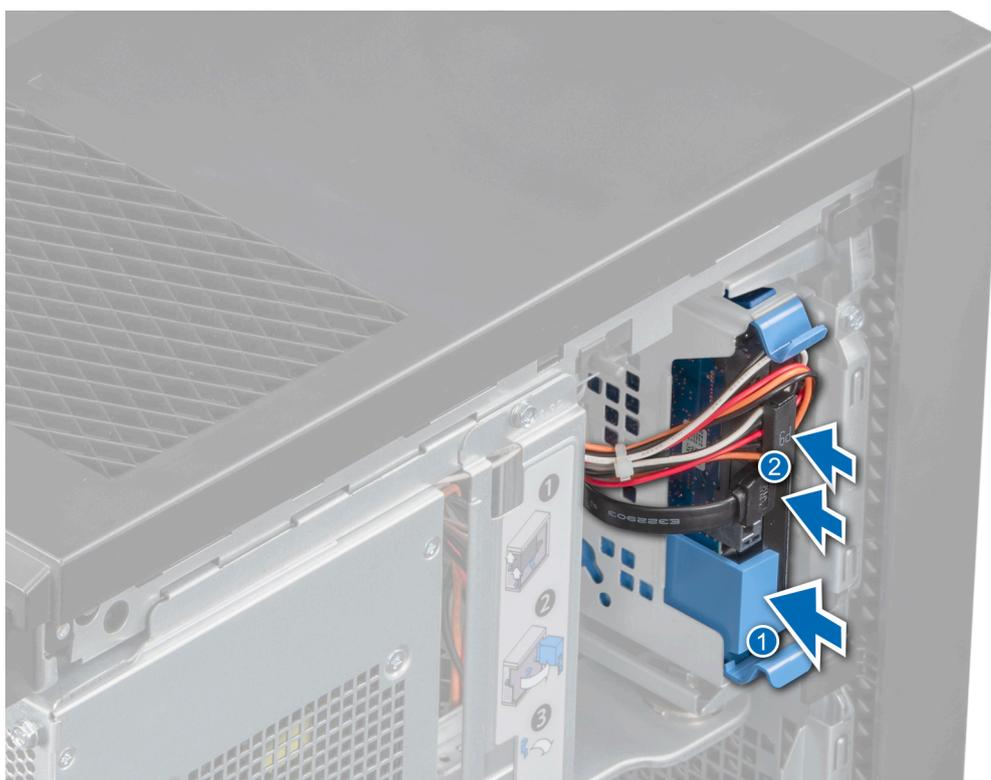
**Ilustración 15. Instalación del portaunidades de disco duro**
