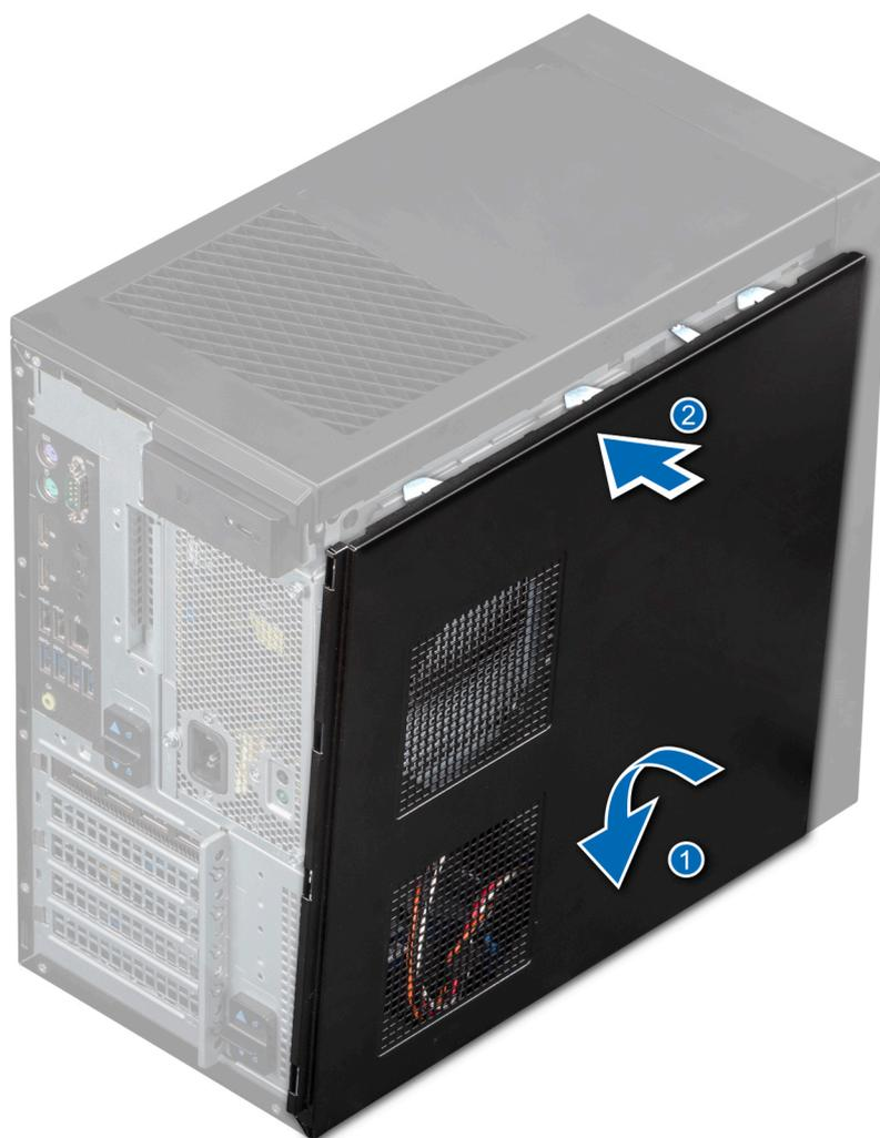
**Ilustración 11. Instalación de la cubierta del sistema**
