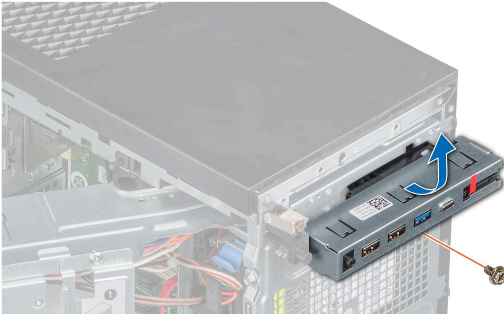
**Ilustración 52. Extracción del panel de control**
