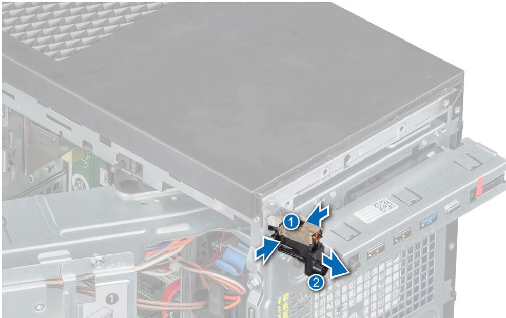
**Ilustración 54. Extracción del módulo del botón de encendido**
