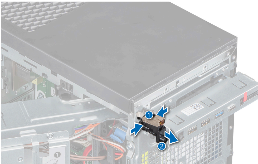
Abbildung 54. Entfernen des Betriebsschaltermoduls
