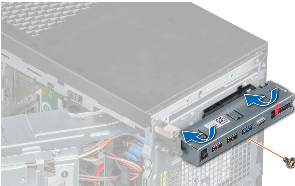
Ilustración 53. Instalación del panel de control
