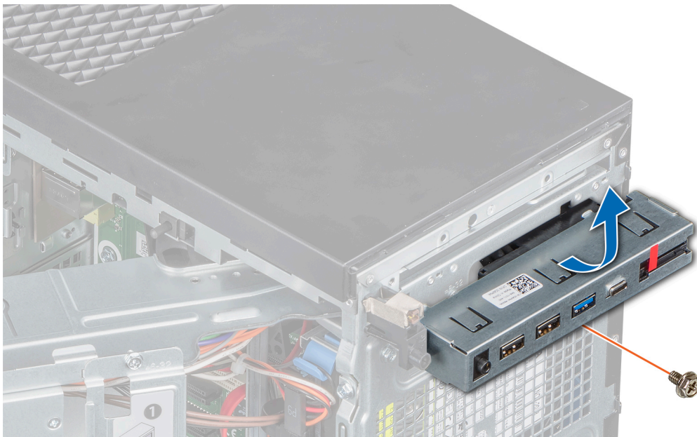
Ilustración 52. Extracción del panel de control
