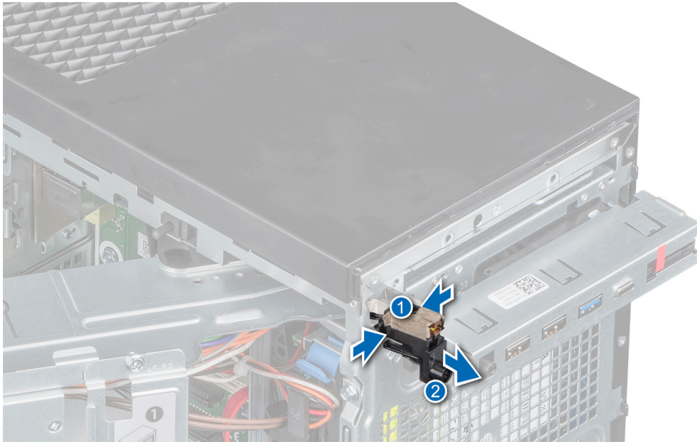
Figure 54. Retrait du module du bouton d'alimentation
