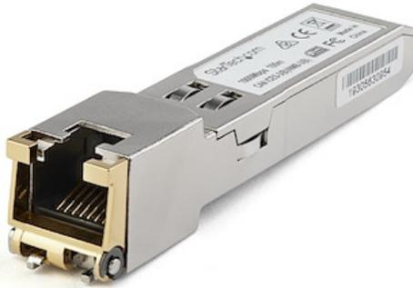
El modelo GLCTEST es un módulo transceptor por cobre compatible con el modelo GLC-TE de Cisco, diseñado, programado y probado para su funcionamiento con enrutadores y switches de la marca Cisco®. Ofrece conectividad 1GbE fiable a través de cable de cobre para redes compatibles con 1000BASE-T, con una distancia máxima de hasta 100m.
