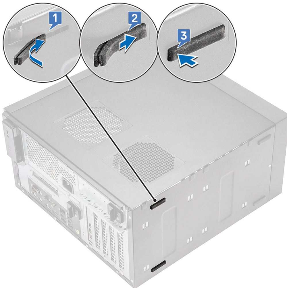
Figure 7. Installation des patins en caoutchouc arrière
