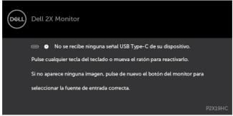
Si se selecciona la entrada HDMI o DP o USB Type-C y el cable correspondiente no está conectado, aparece un cuadro de diálogo flotante como el que se muestra abajo.
