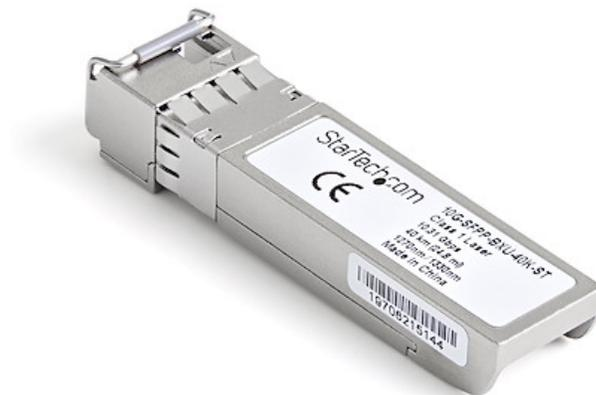
El modelo 10G-SFPP-BXU-40K-ST es un transceptor SFP+ upstream por fibra óptica compatible con el modelo 10G-SFPP-BXU-40K de Brocade, que se puede emparejar con 10G-SFPP-BXD-40K de StarTech.com. Ha sido diseñado, programado y probado para su funcionamiento con routers y switches MSA compatibles con 10GBASE-BX. El módulo transceptor SFP+ admite una distancia máxima de hasta 40 km y conectividad confiable a 10 GbE a través de cableado de fibra óptica.
