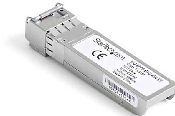
Der 10G-SFPP-BXU-40K-ST ist ein MSA-konformer Upstream Glasfaser SFP+-Transceiver, der mit 10G-SFPP-BXD-40K von StarTech.com verbunden werden kann. Er wurde für den Einsatz mit 10GBASE-BX-kompatiblen MSA-Switches und -Routern entwickelt. Das SFP+-Transceiver-Modul unterstützt eine maximale Entfernung von bis zu 40 km und sorgt für zuverlässige 10 GbE-Konnektivität via Glasfaser-Verkabelung.
