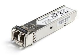
Der CTPSFP1GELXS ist ein Juniper CTP-SFP-1GE-LX -kompatibles Glasfaser SFP-Transceiver-Modul, das für den Einsatz mit Juniper® Marken-Switches und -Routern entwickelt, programmiert und getestet wurde. Es sorgt für zuverlässige 1 GbE-Konnektivität über Glasfaser-Kabel für 1000BASE-LX-konforme Netzwerke mit einer maximalen Entfernung von bis zu 10 km.
