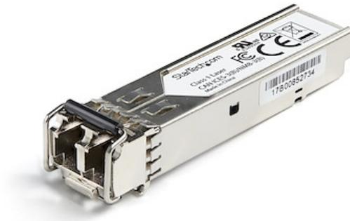
El modelo CTPSFP1GESXS es un módulo transceptor SFP por fibra óptica compatible con el modelo CTP-SFP-1GE-SX de Juniper diseñado, programado y probado para su funcionamiento con routers y switches de la marca Juniper®. Ofrece conectividad confiable a 1 GbE, a través de cable de fibra óptica, para redes compatibles con 1000BASE-SX, a una distancia máxima de hasta 550 m.
