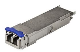
Der QSFP-40GE-LR4-ST ist ein Cisco QSFP-40GE-LR4-kompatibles Glasfaser QSFP-Transceiver-Modul, das für den Einsatz mit Cisco® Marken-Switches und -Routern entwickelt, programmiert und getestet wurde. Es sorgt für zuverlässige 40 GbE-Konnektivität über Glasfaser-Kabel für 40GBASE-LR4-konforme Netzwerke mit einer maximalen Entfernung von bis zu 10 km.
