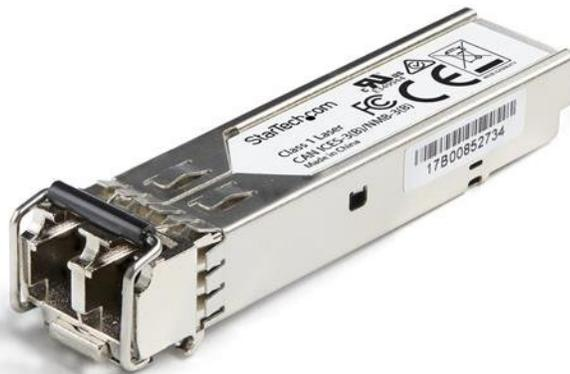
Le SFP1FEFXST est un module de transceiver SFP fibre optique compatible Juniper SFP-1FE-FX qui a été conçu, programmé et testé pour fonctionner avec des commutateurs et des routeurs de marque Juniper®. Il vous assure une connectivité de 100 MbE par câble en fibre optique, sur les réseaux compatibles 100Base-FX et sur une distance maximale de 2 km.
