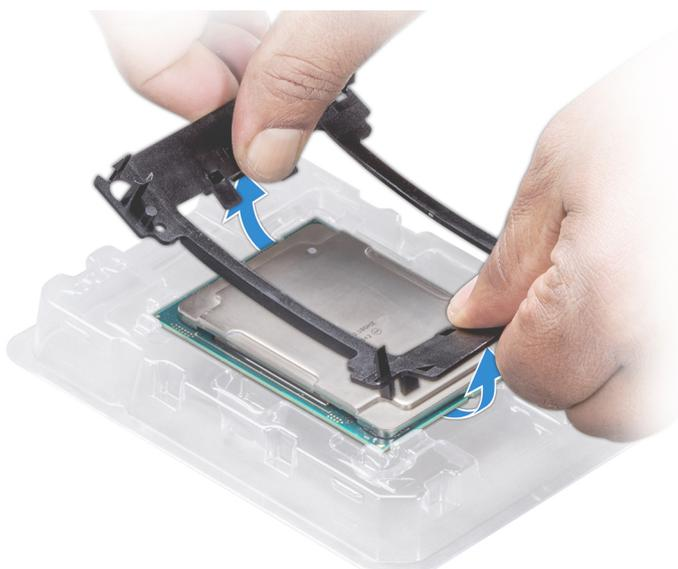
**Ilustración 57. Extracción del soporte del procesador**
