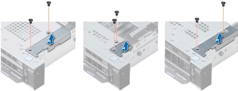
**Ilustración 128. Extracción de la cubierta de cables**
