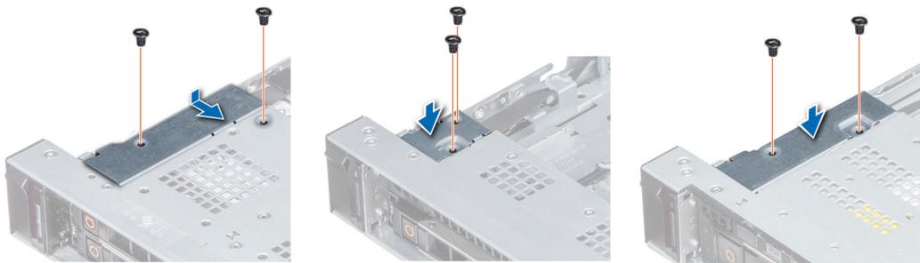
**Ilustración 127. Instalación de la cubierta de cables**
