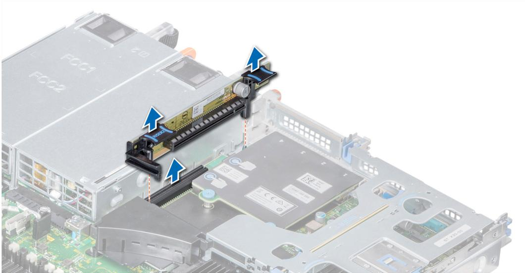
**Ilustración 64. Extracción del soporte vertical para tarjetas de expansión 2A**
