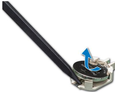
**Ilustración 109. Extracción de la batería del sistema**
