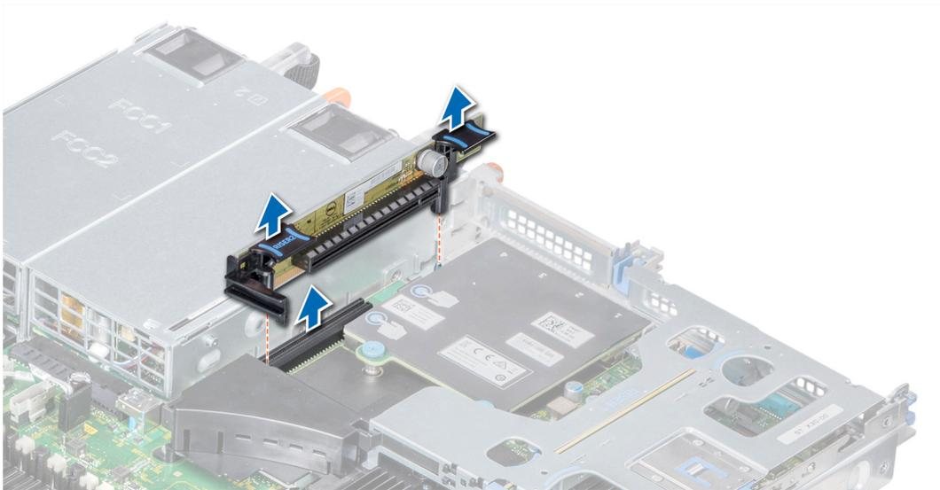
**Ilustración 22. Extracción del soporte vertical para tarjetas de expansión 2A**
