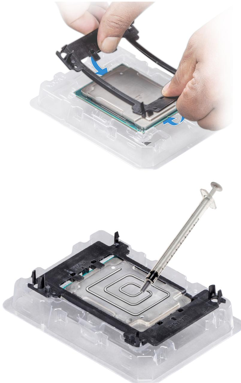
**Ilustración 59. Aplicación de la pasta térmica en la parte superior del procesador**
