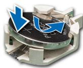
**Ilustración 110. Instalación de la batería del sistema**
