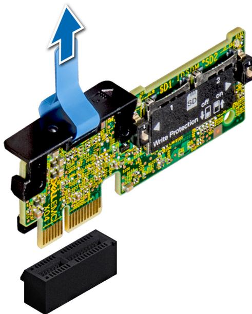
**Ilustración 81. Extracción del módulo IDSDM opcional**
