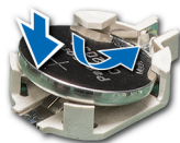
Abbildung 110. Installieren der Systembatterie
