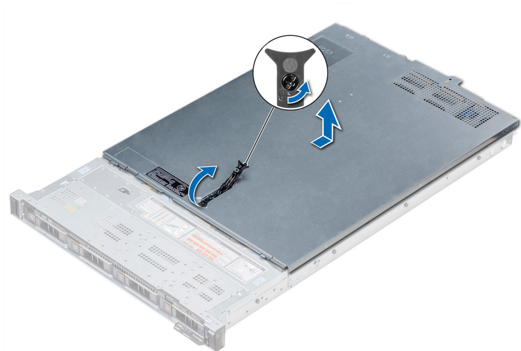
Abbildung 39. Entfernen der Systemabdeckung
