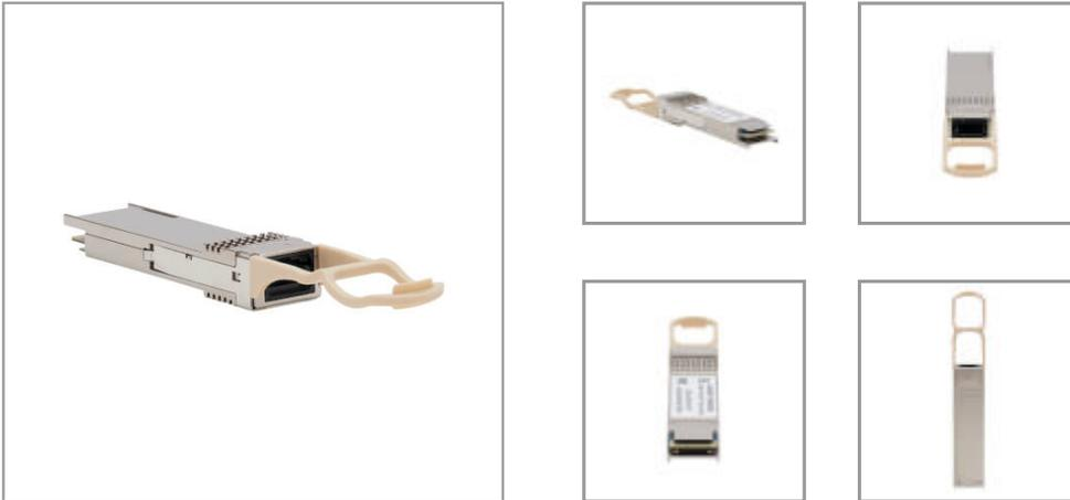
Enlaza un cable de red multimodo Ethernet Gigabit al puerto QSFP+ de un switch, ruteador o servidor.
