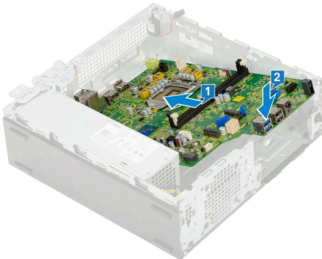
3. Remettez en place la vis unique utilisée comme support de montage pour le disque SSD M.2, l'unique vis (#6-32) de l'entretoise et les cinq vis qui fixent la carte système au système [1, 2, 3].
