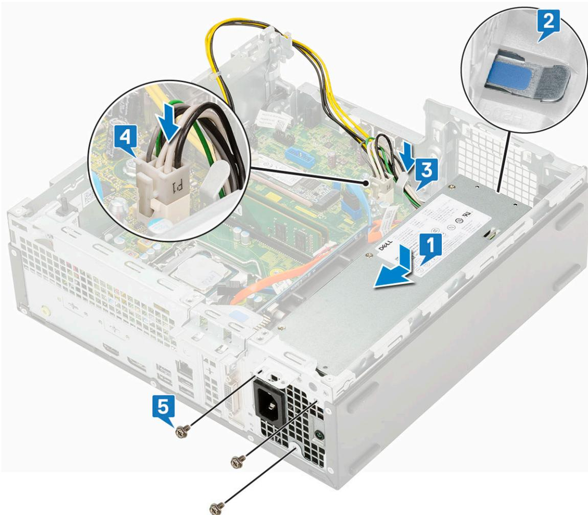
5. Acheminez le câble d'alimentation du bloc d'alimentation à travers les clips de fixation [1].
