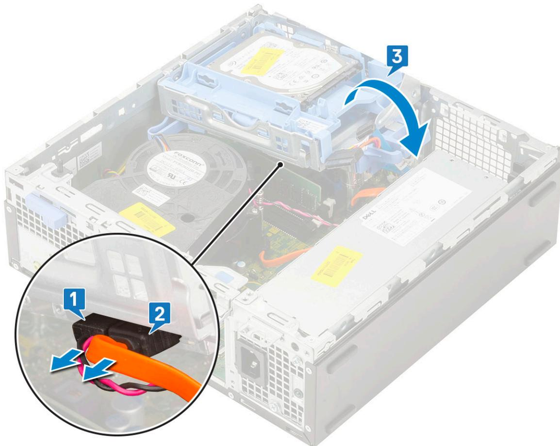
e) Appuyez sur le loquet de déverrouillage du lecteur optique [1] et retirez le lecteur optique du système [3].
