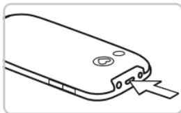
1. Inserire la batteria in modo che i contatti della batteria tocchino i contatti dorati del cellulare.
