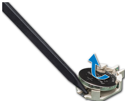
Figure 111. Retrait de la pile du système
