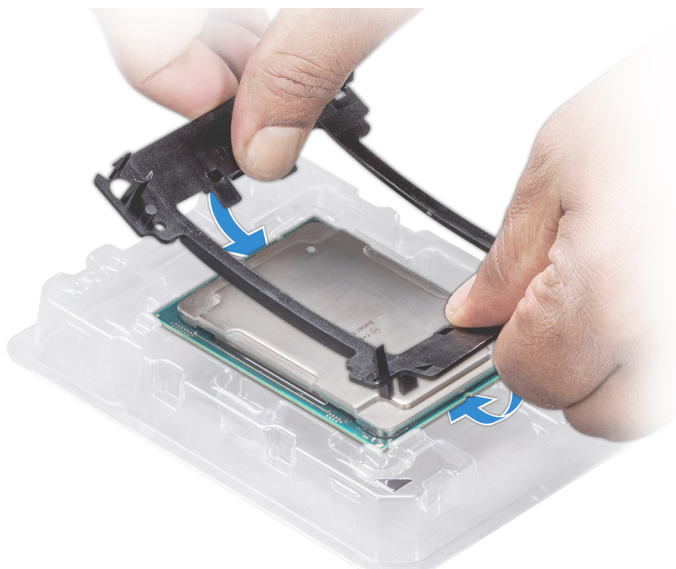
Figure 60. Installation du support de processeur
