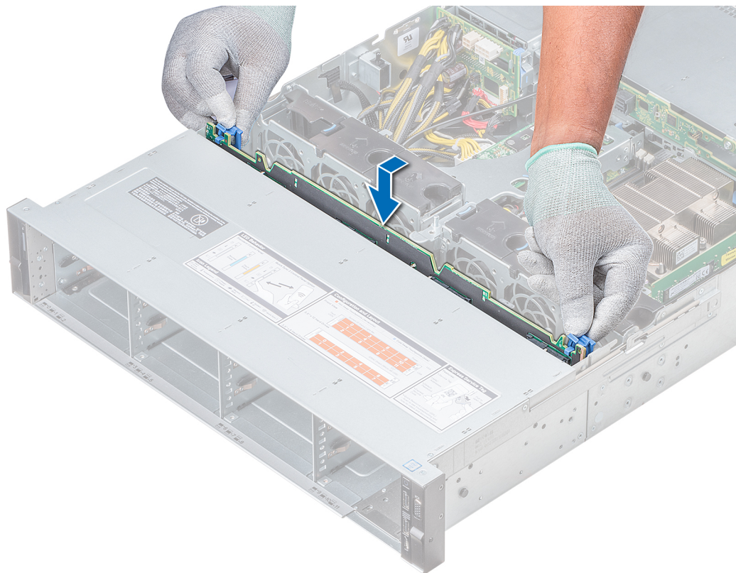
Figure 101. Installation du fond de panier
