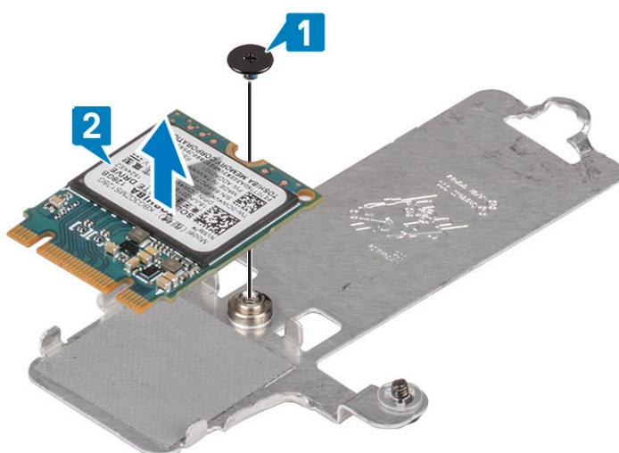
3. Alignez l'encoche du SSD avec la languette située sur l'emplacement du SSD.
