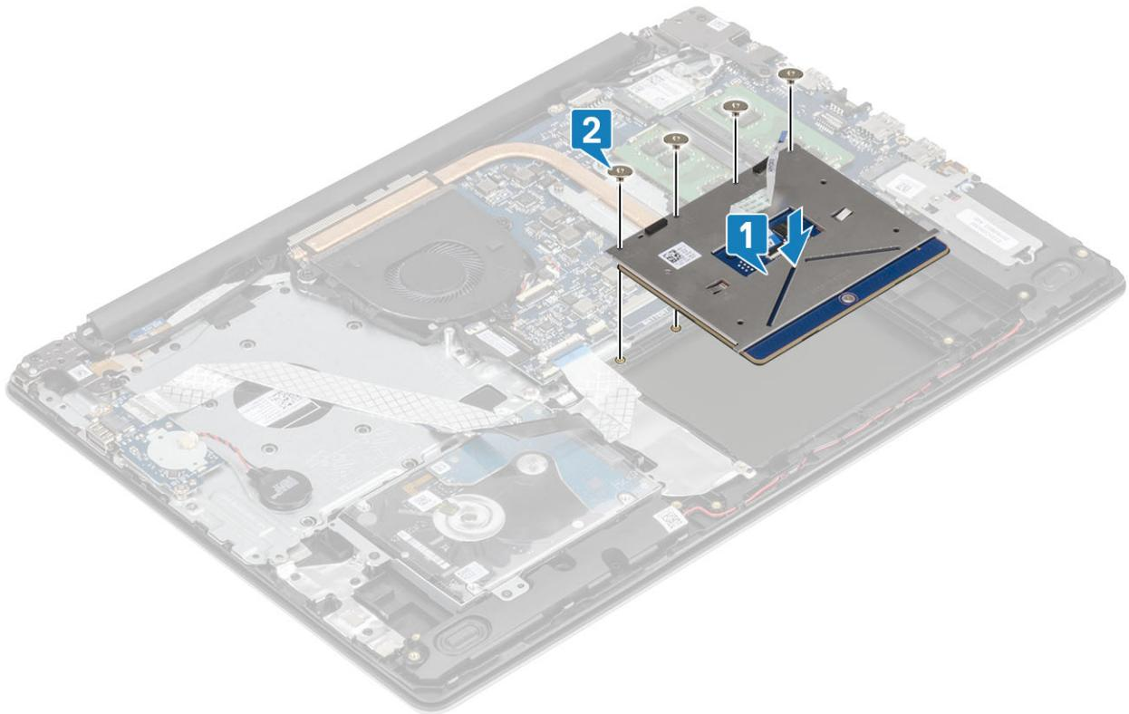
3. Placez le support du pavé tactile dans son emplacement situé sur l'ensemble repose-mains et clavier [1].
