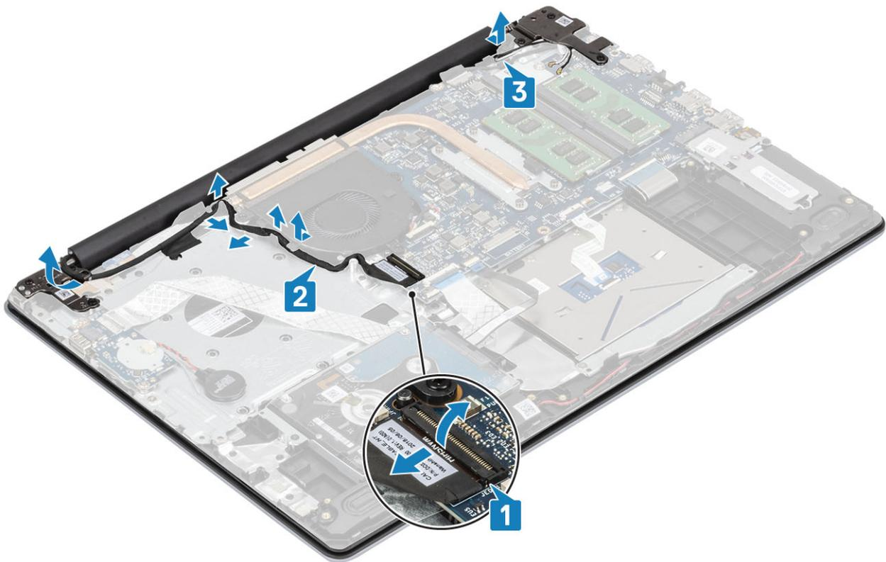
4. Retirez les cinq vis (M2,5x5) qui fixent les charnières gauche et droite à la carte système, et l'assemblage du repose-mains et du clavier [1].
