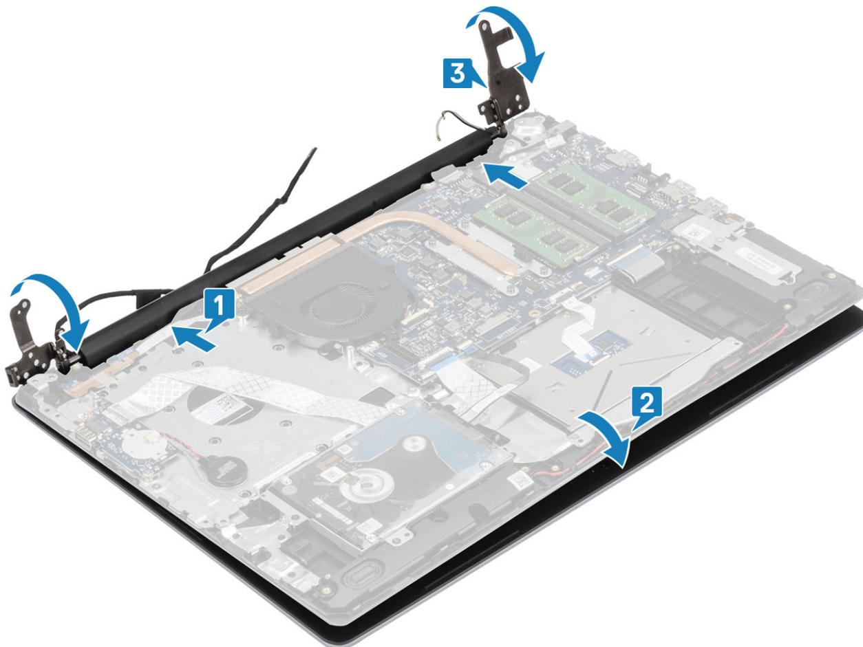
4. Remettez en place les cinq vis (M2,5x5) qui fixent les charnières gauche et droite à la carte système, et l'assemblage du repose-mains et du clavier [1].
