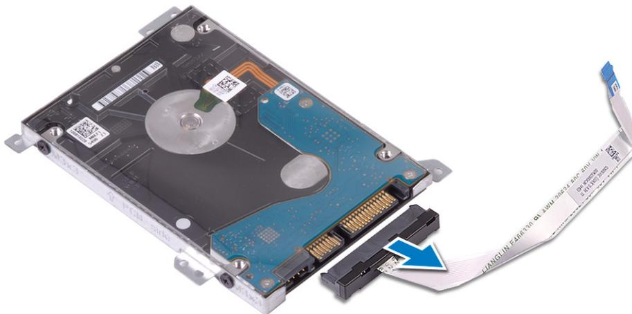
5. Retirez les quatre vis (M3 x 3) qui fixent le support du disque dur à ce dernier [1].
