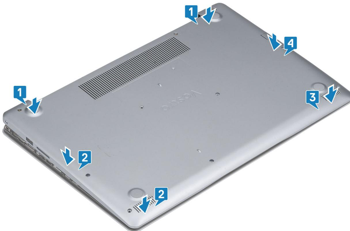
3. Serrez les trois vis imperdables et remettez en place la vis unique (M2x4) qui fixe le cache de fond à l'ensemble repose-mains/clavier [1, 2].
