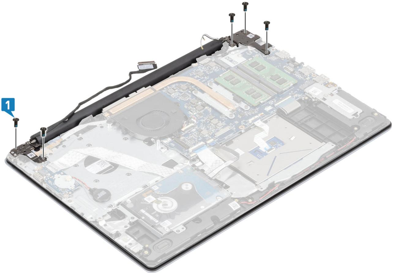
5. Acheminez le câble de l'écran dans les guides d'acheminement situés sur l'assemblage de repose-mains et de clavier. [1].
