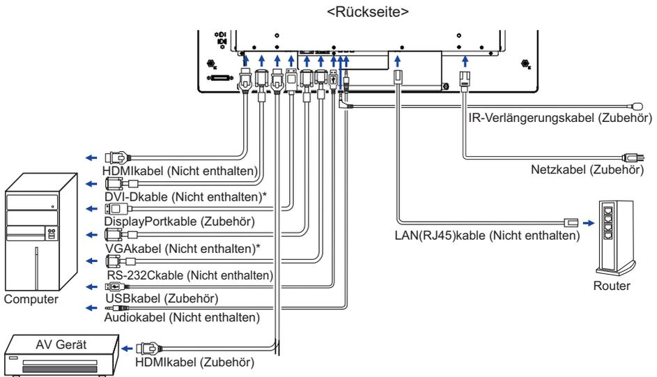
\* Das Kabel ist nicht im Lieferumfang enthalten. Wenn ein qualitativ niedriges Kabel verwendet wird, kann dies elektromagnetische Störungen verursachen. Bitte kontaktieren Sie das iiyama Support Center in Ihrem Land, wenn Sie den Monitor über den VGA oder DVI-Eingang anschließen wollen.
