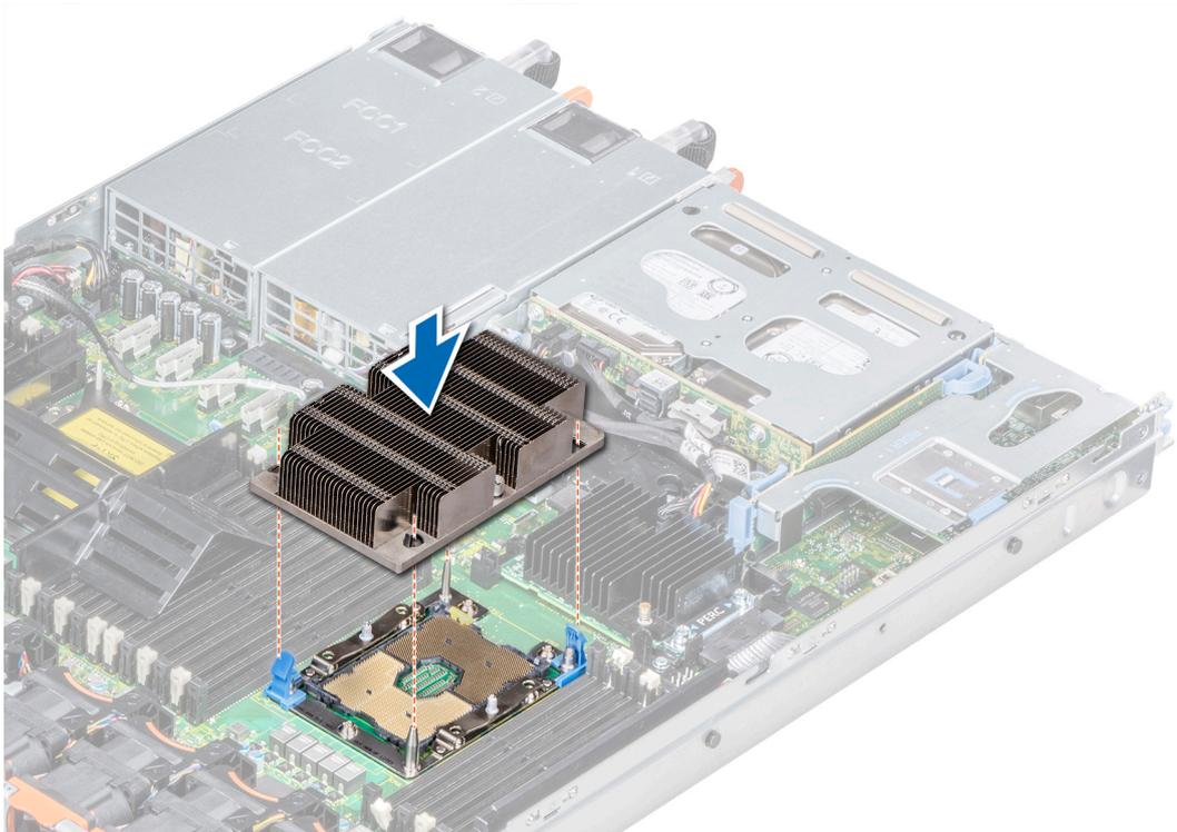
Figure 50. Installation du module processeur et dissipateur de chaleur
