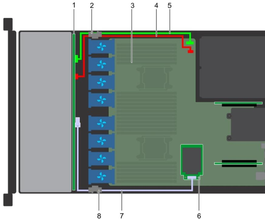
**Figure 91. Acheminement des câbles : backplane de 4 disques de 3,5 pouces avec carte mini PERC**
