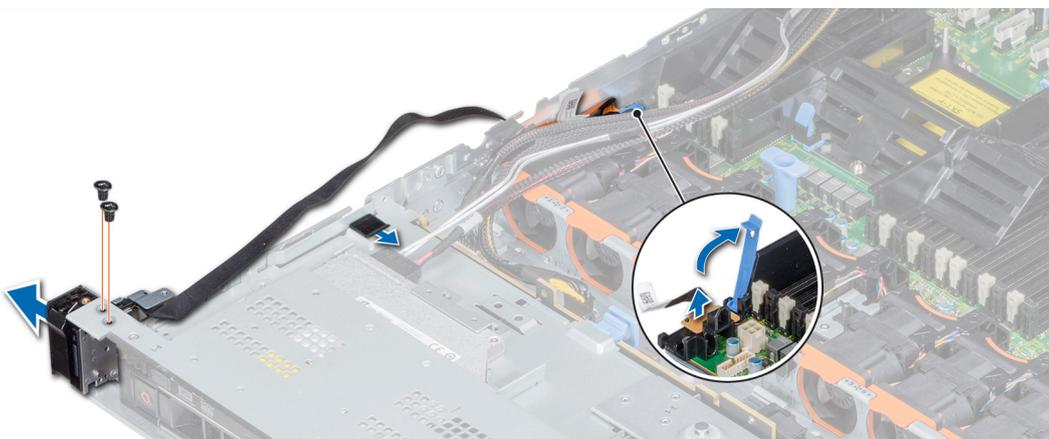
Figure 114. Retrait du panneau de commande de gauche
