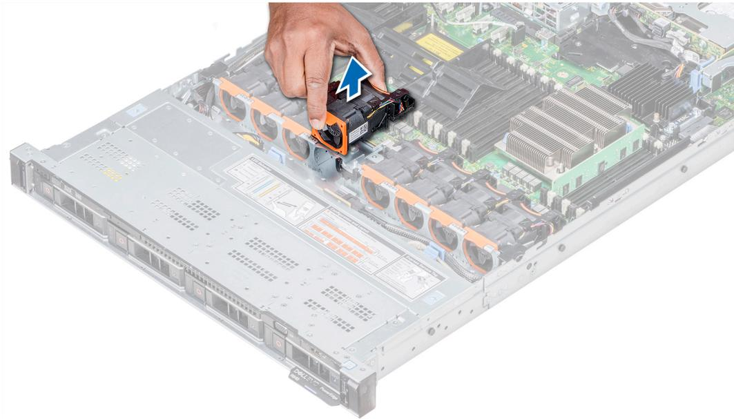
Figure 37. Retrait du ventilateur de refroidissement
