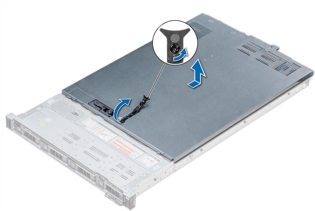
Figure 22. Retrait du capot du système
