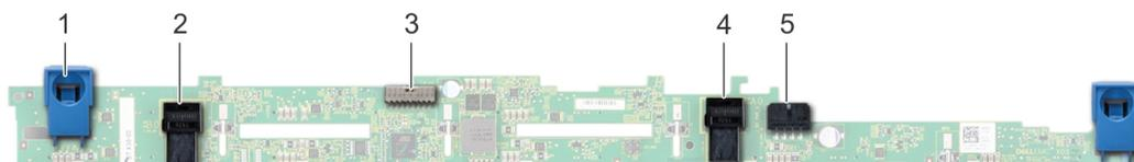
**Figure 81. Fond de panier à 8 disques de 2,5 pouces**
