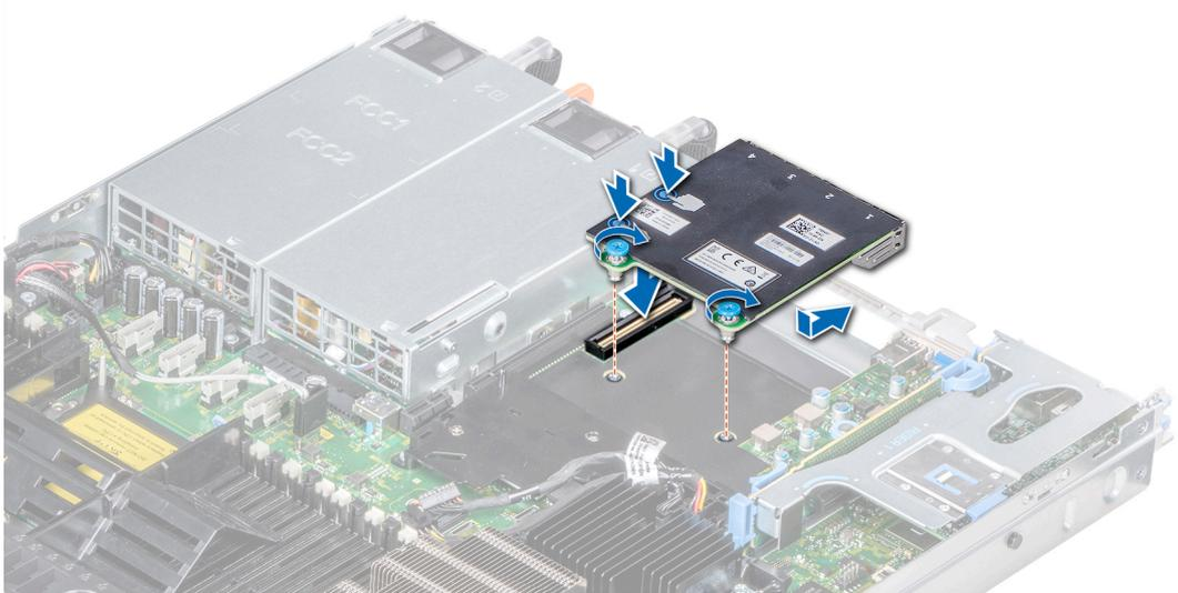
Figure 75. Installation de la carte fille réseau
