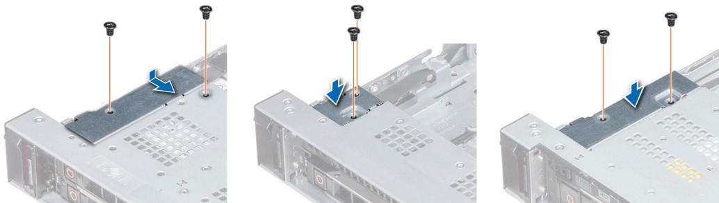
**Figure 116. Installation du cache-câbles**
