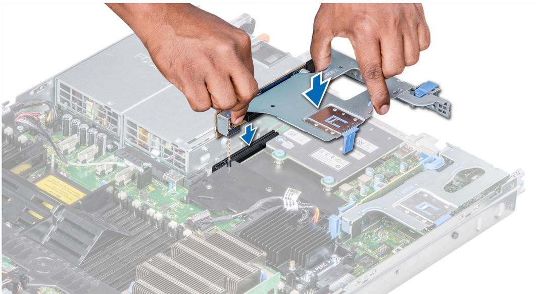
Figure 58. Installation de la carte de montage d'extension 2B
