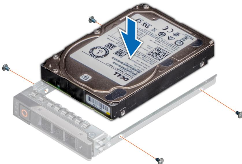
Figure 29. Installation d'un disque dans son support
