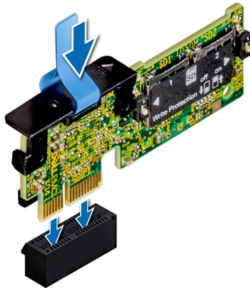
Figure 71. Installation du module IDSDM (en option)
