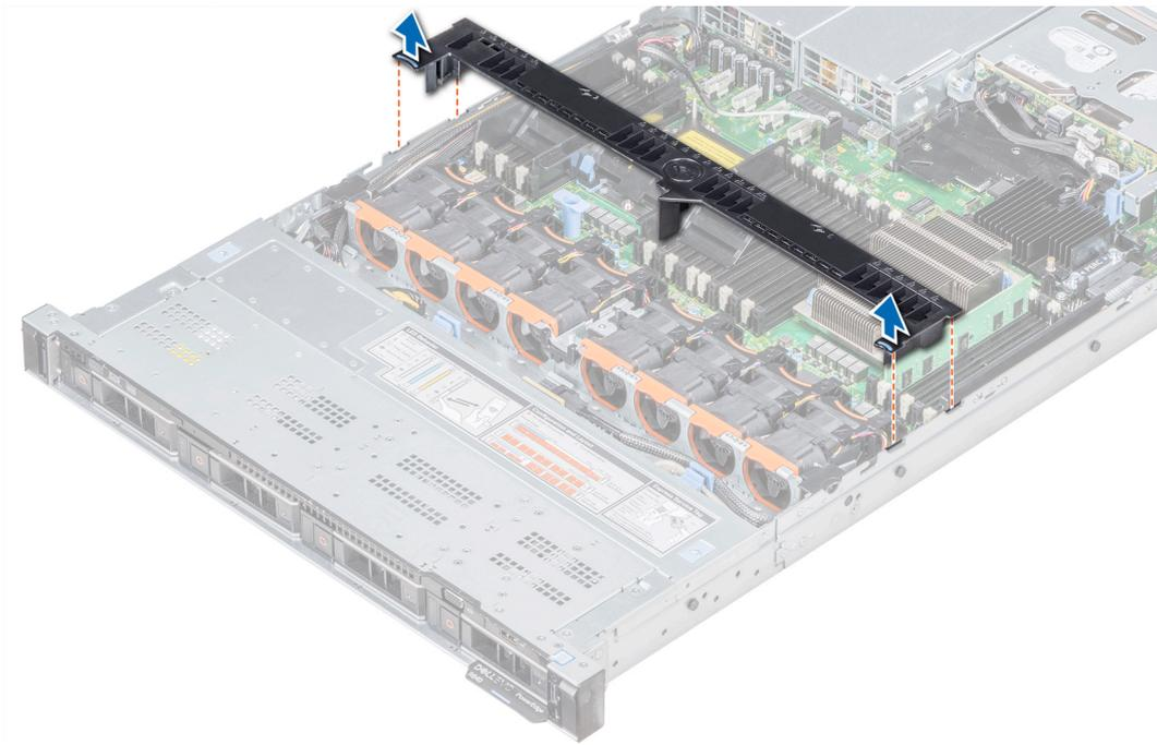
Figure 35. Retrait du carénage d'aération
