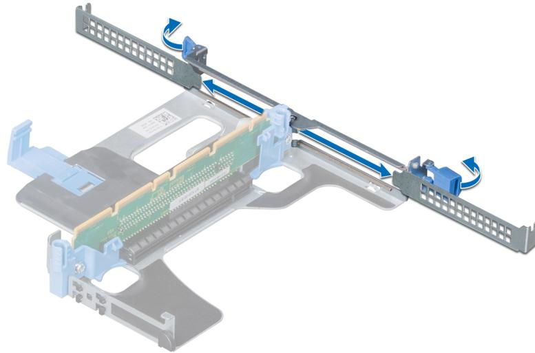
**Figure 64. Retrait de la plaque de recouvrement métallique sur la carte de montage 1A**
