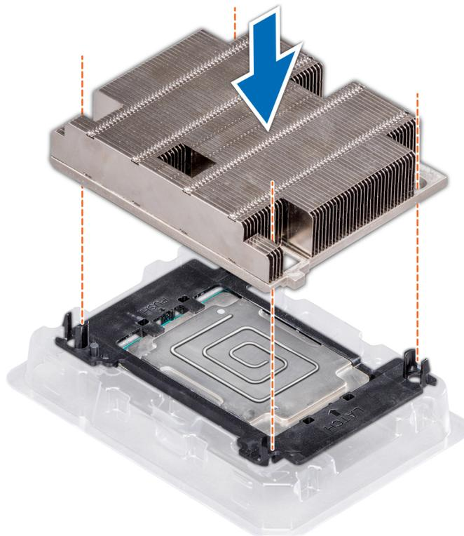
Figure 49. Installation du dissipateur de chaleur sur le processeur
