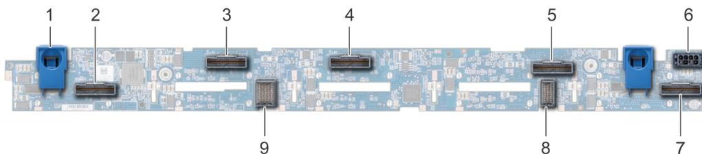
**Figure 82. Fond de panier à 10 disques de 2,5 pouces**
