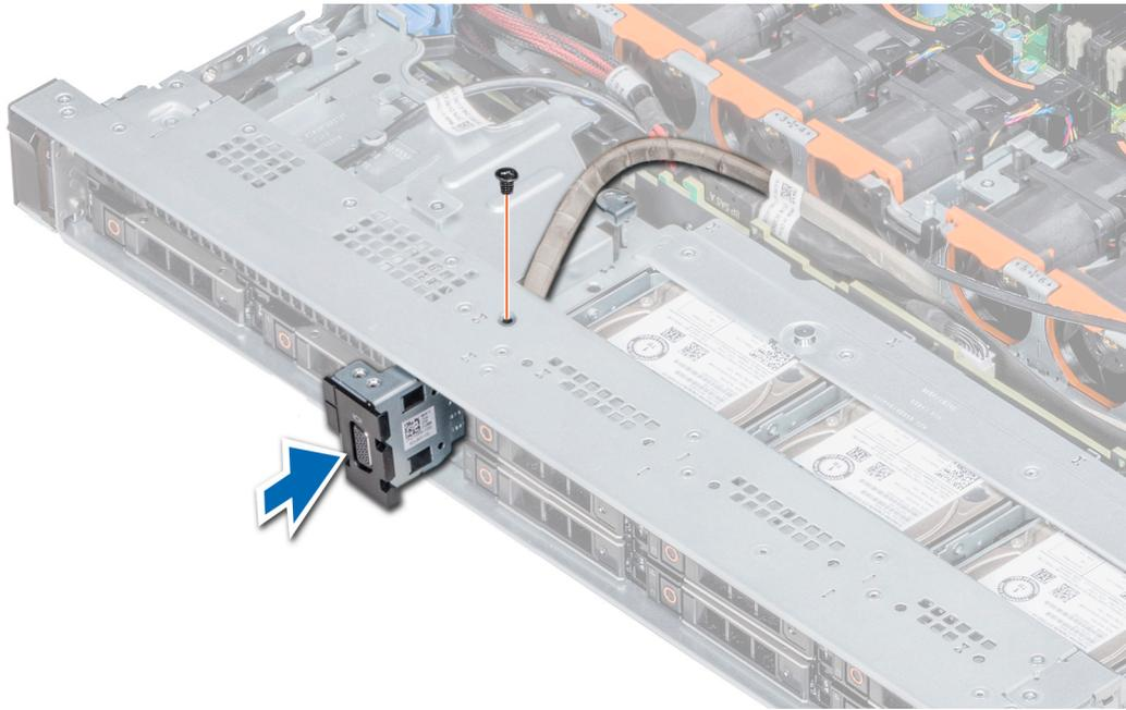
Figure 103. Installation du module VGA
