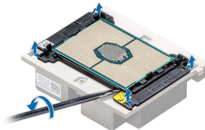
**Figure 45. Pliage du support de processeur**
