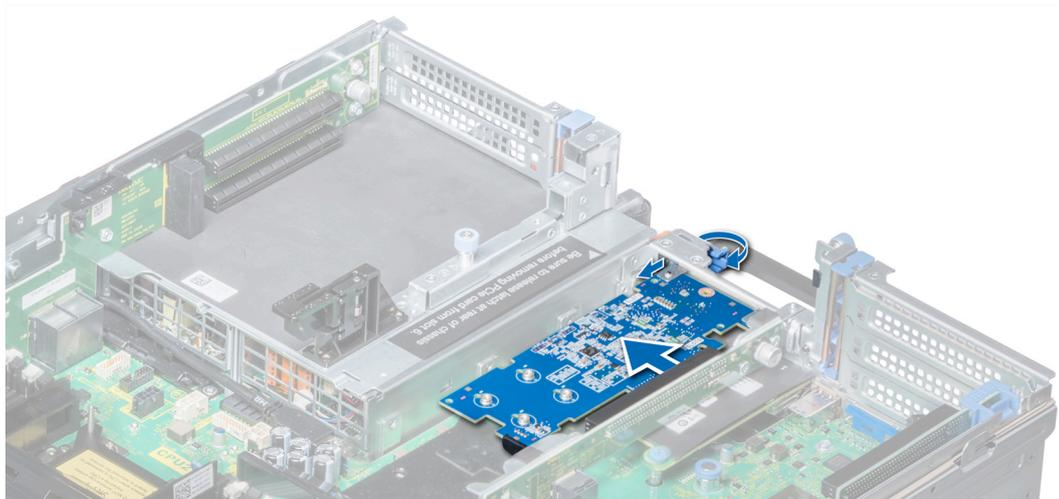
Figure 60. Retrait de la carte d'extension hors de la carte de montage pour cartes d'extension 2B
