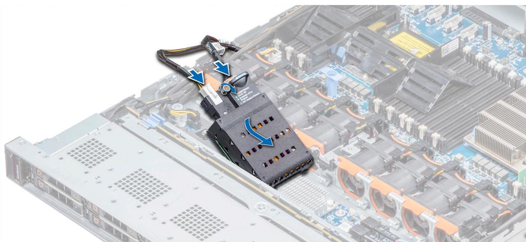
Figure 43. Installation de la batterie NVDIMM-N
