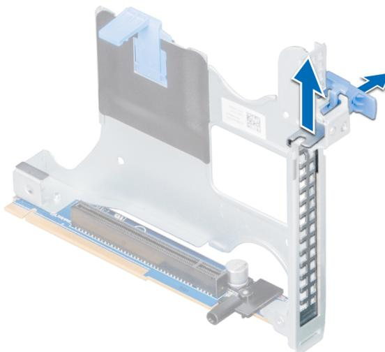
Figure 63. Retrait de la plaque de recouvrement métallique sur la carte de montage 2B
