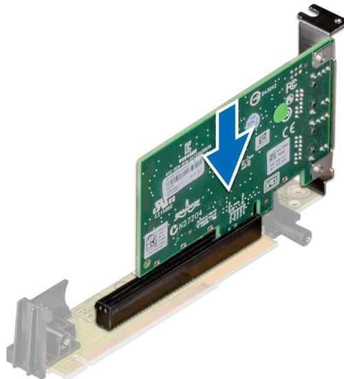
Figure 67. Installation d'une carte d'extension dans la carte de montage 2A
