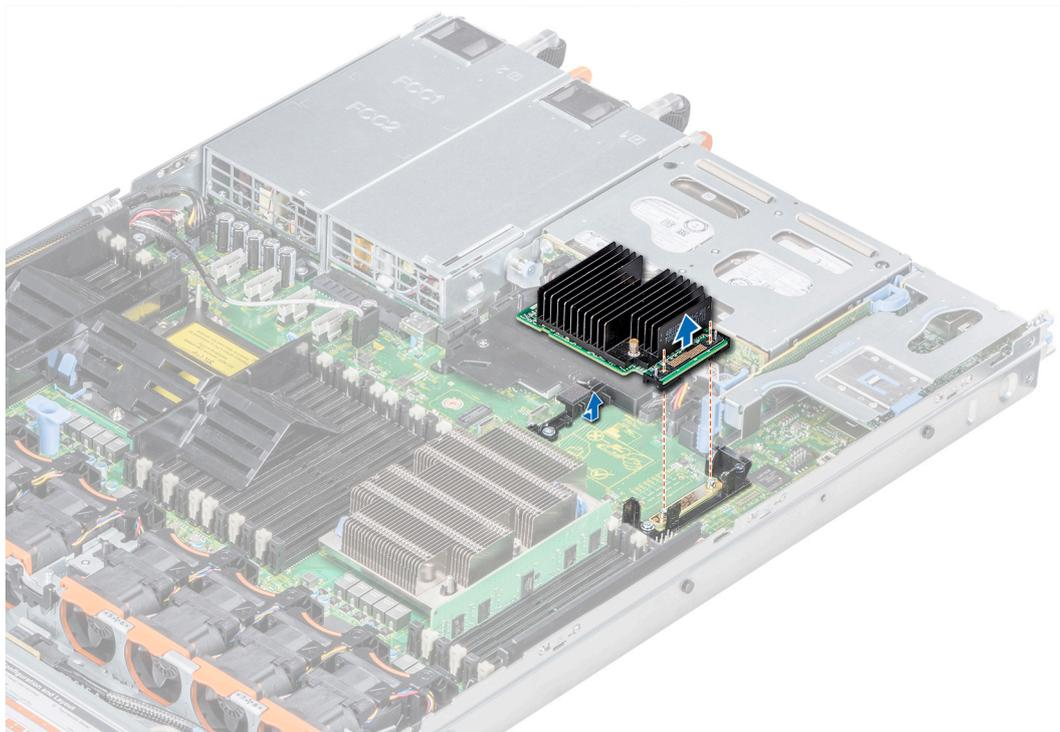
Figure 77. Retrait de la carte contrôleur de stockage intégrée
