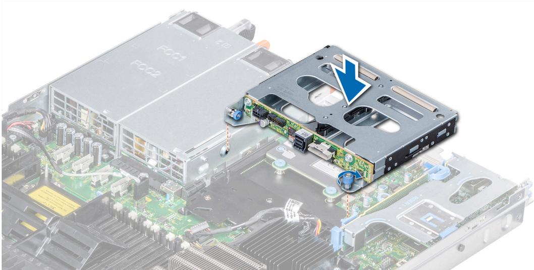
Figure 97. Installation du bâti des disques arrière
