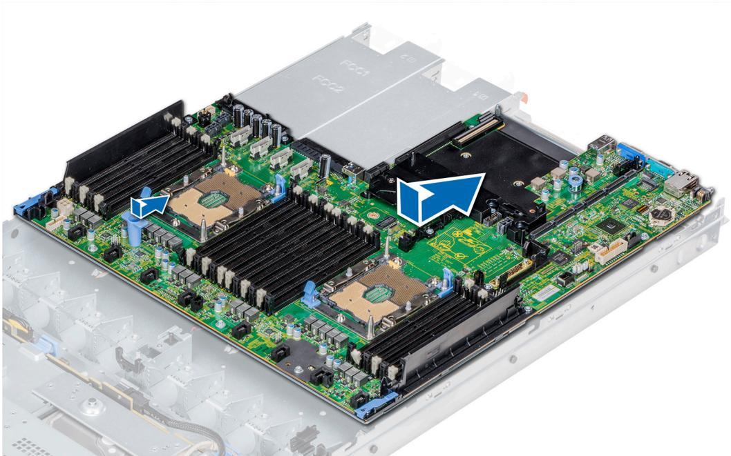
Figure 111. Installation de la carte système
