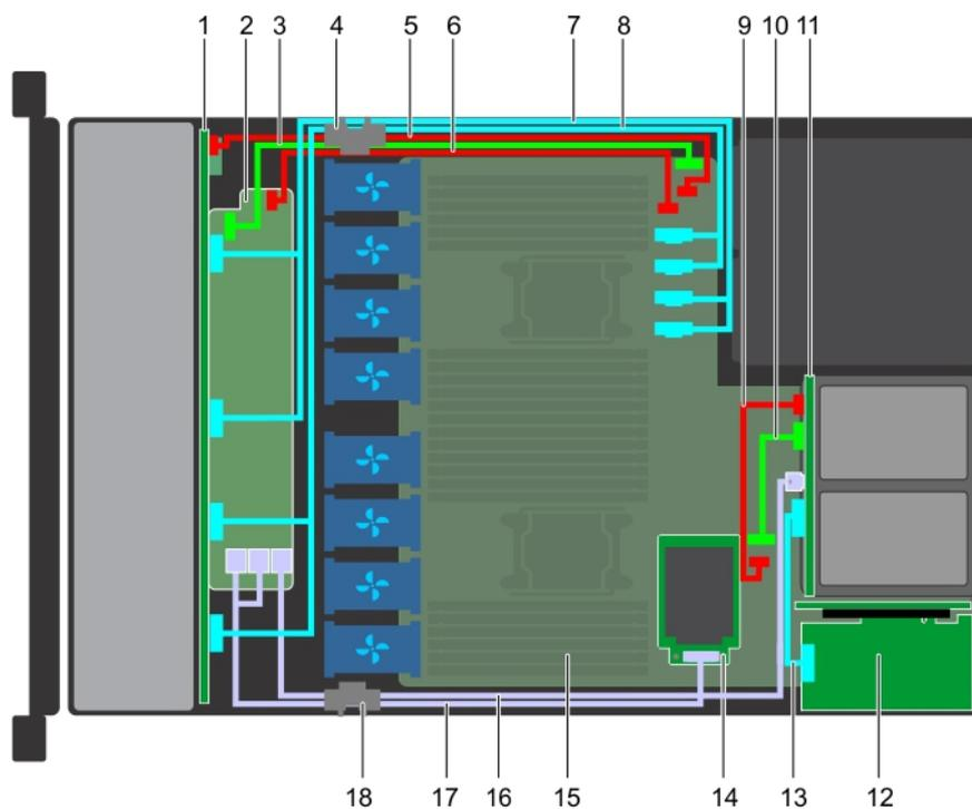
**Figure 88. Acheminement des câbles : backplane doté de 10 disques de 2,5 pouces et backplane doté de 2 disques arrière de 2,5 pouces avec carte mini PERC**
