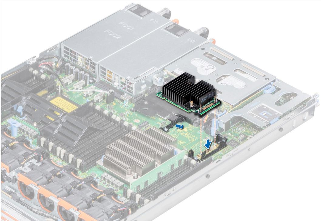
**Figure 78. Installation de la carte contrôleur de stockage intégrée**
