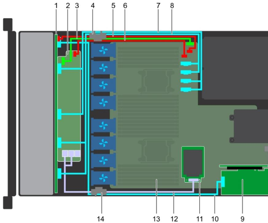
**Figure 90. Acheminement des câbles : backplane de 10 disques de 2,5 pouces avec technologie NVMe**
