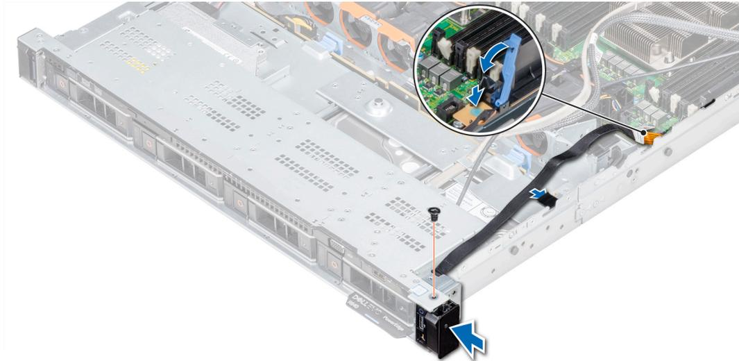
**Figure 119. Installation du panneau de commande droit**
