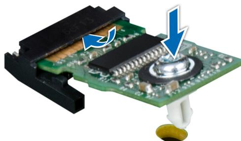
Figure 112. Installation du module TPM
