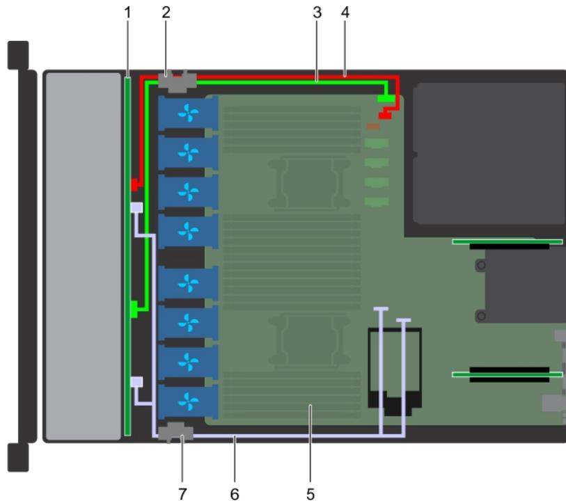
**Figure 93. Acheminement des câbles : backplane de 8 disques de 2,5 pouces avec disque SATA intégré**
