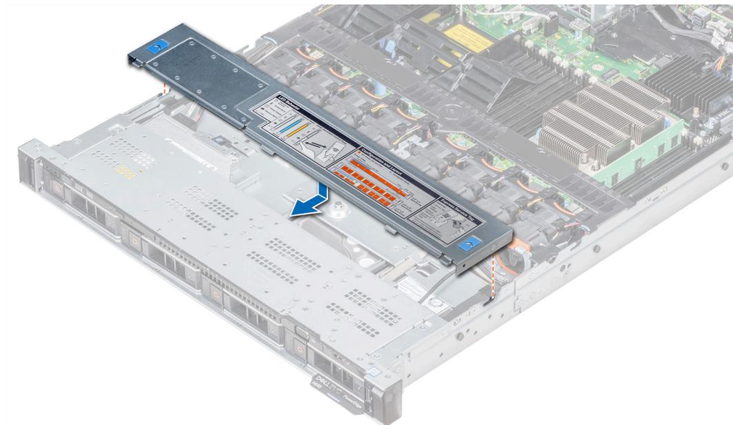
Figure 31. Installation du cache de fond de panier
