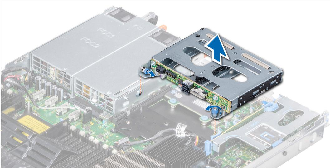
Figure 96. Retrait du bâti de disque arrière
