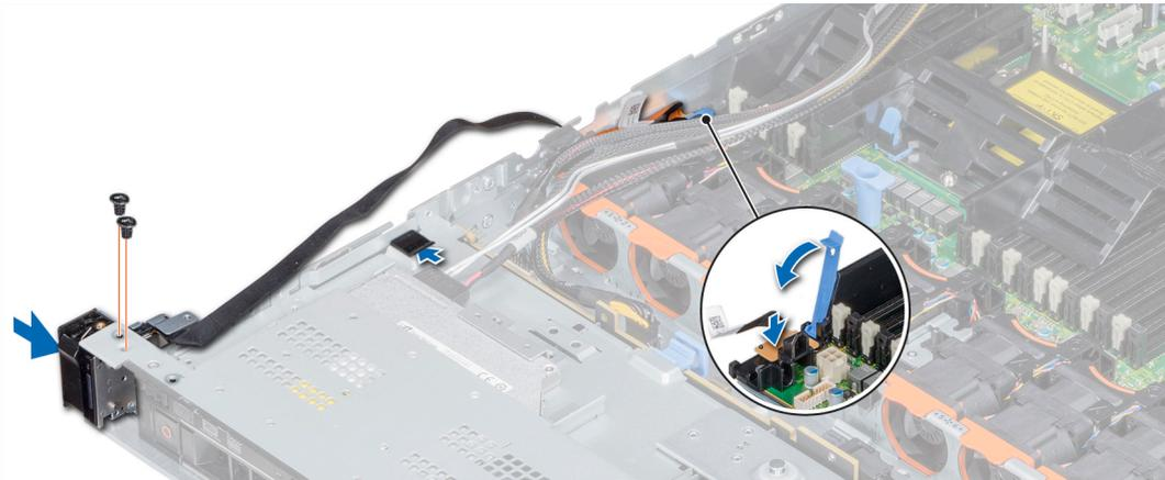
**Figure 115. Installation du panneau de commande gauche**
