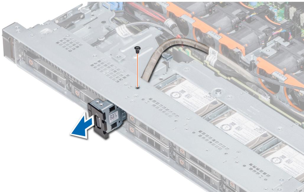
Figure 102. Retrait du module VGA
