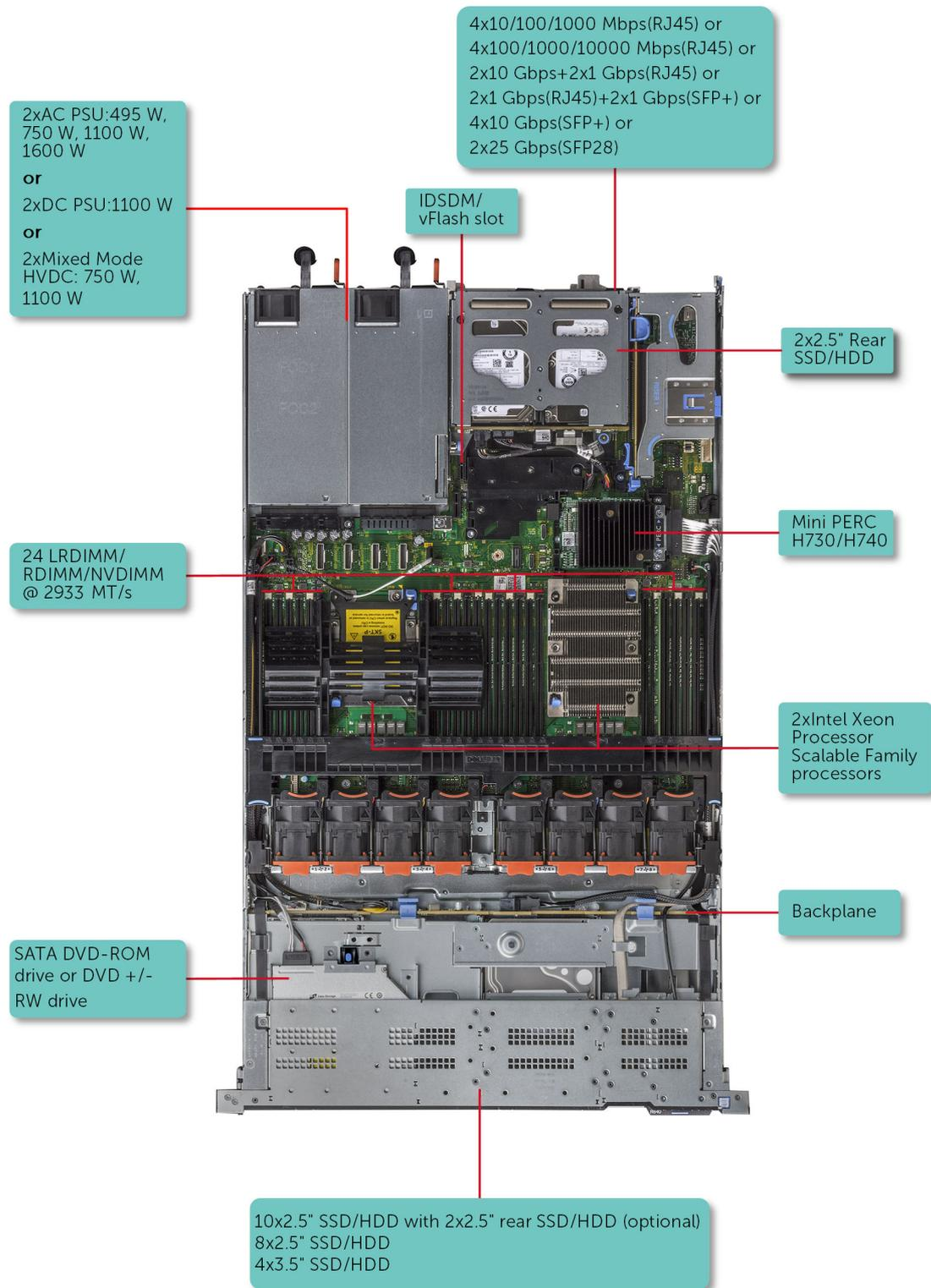
Figure 1. Configurations prises en charge pour le système PowerEdge R640
