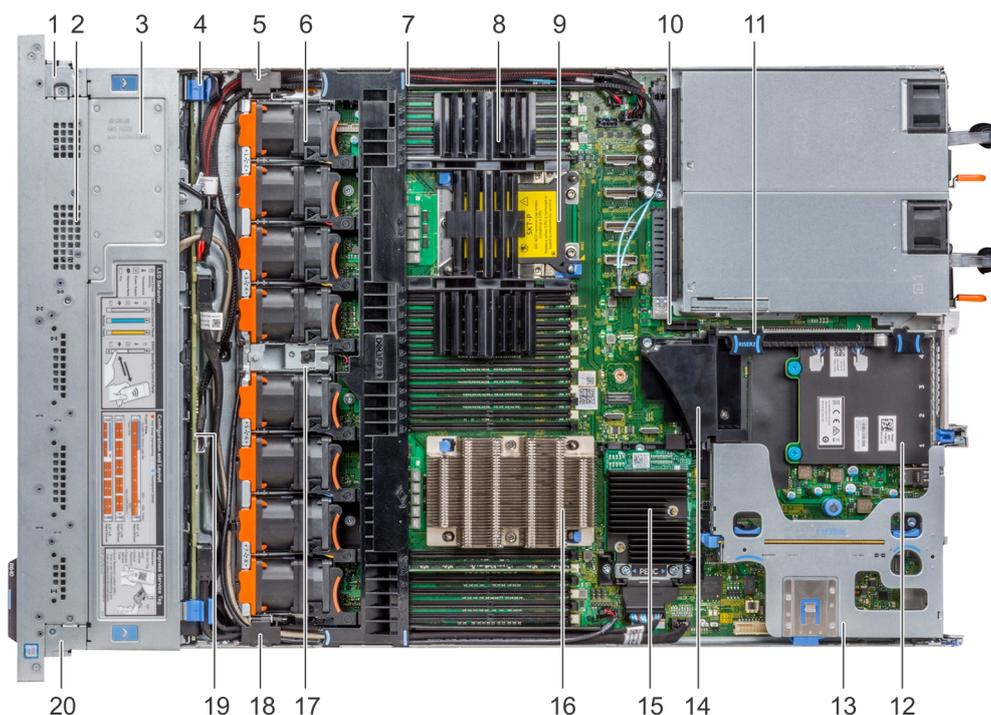
Figure 34. Intérieur du système : 3 cartes de montage d'extension PCIe
