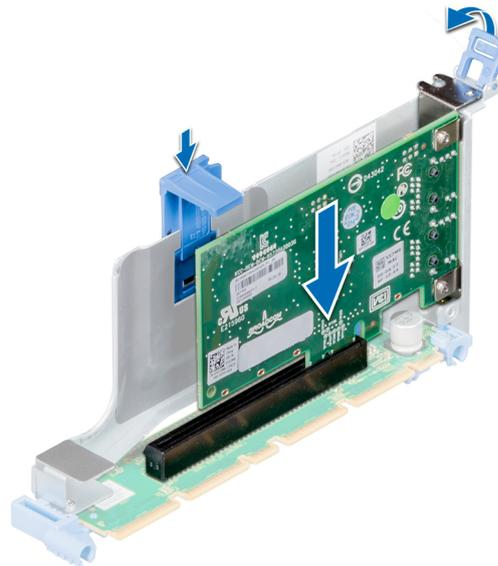
**Figure 65. Installation d'une carte d'extension dans la carte de montage 1B**
