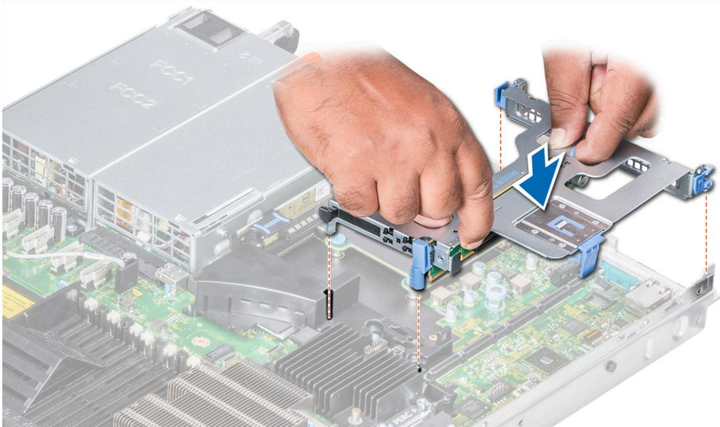
Figure 55. Installation de la carte de montage d'extension 1A
