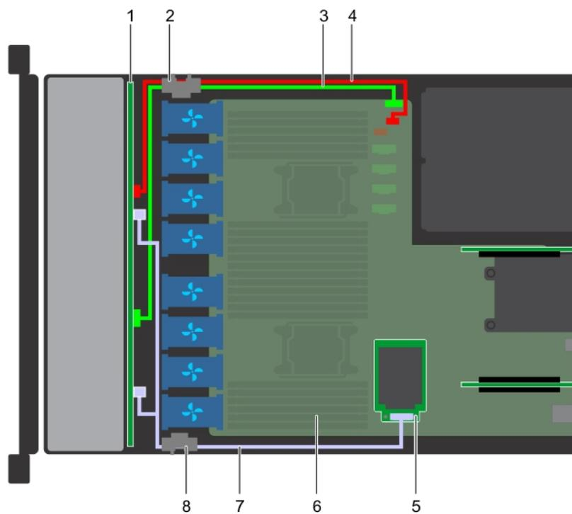
**Figure 92. Acheminement des câbles : backplane de 8 disques de 2,5 pouces avec carte mini PERC**
