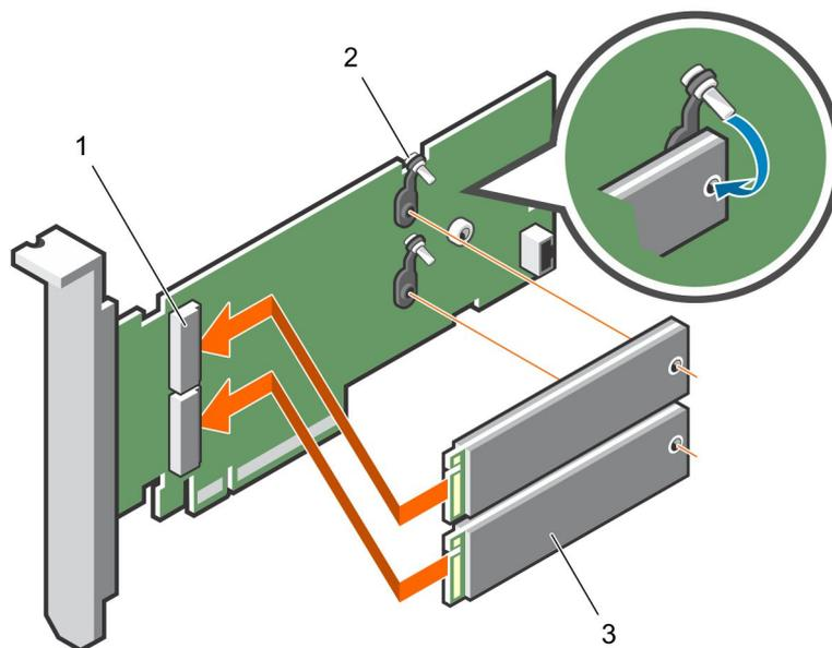
**Figure 69. Installation du module SSD M.2**
