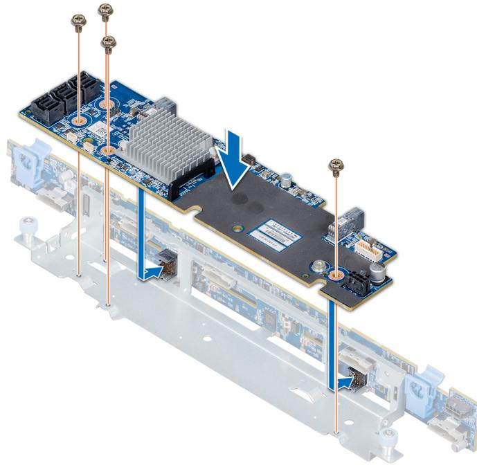
Figure 95. Installation de la carte du module d'extension SAS
