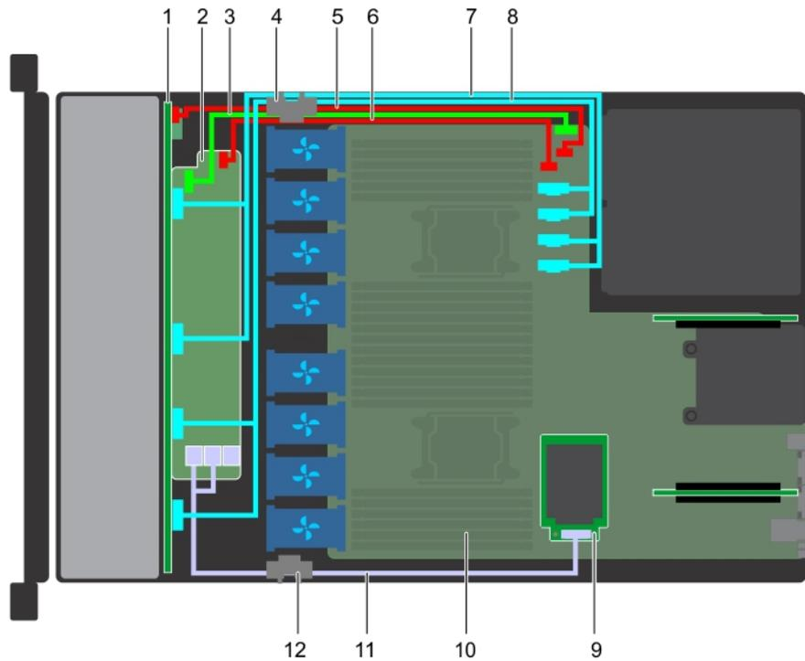
**Figure 89. Acheminement des câbles : backplane de 10 disques de 2,5 pouces avec carte mini PERC**
