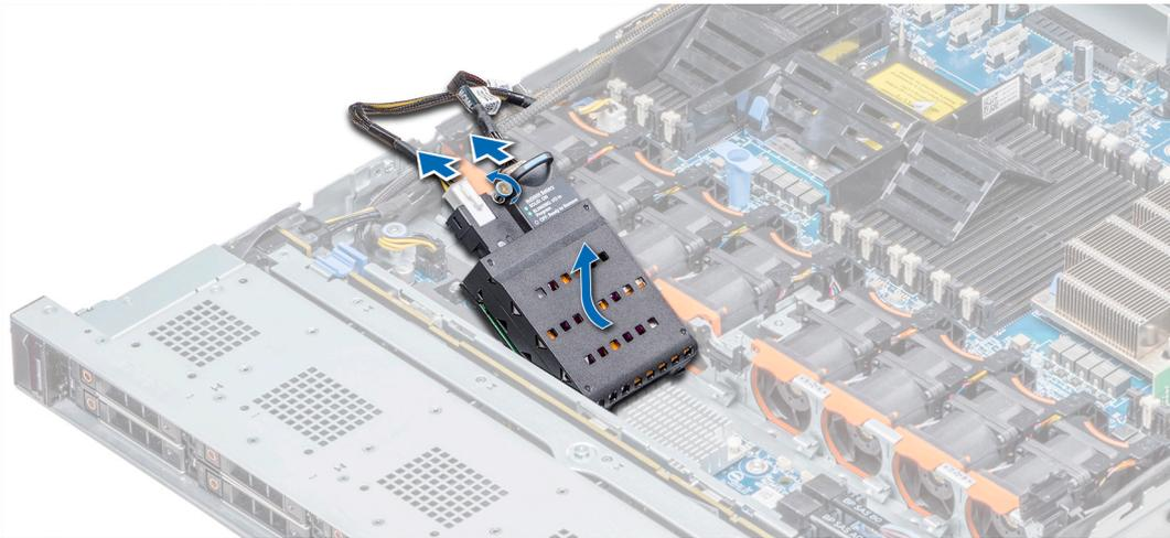
Figure 42. Retrait de la pile du module NVDIMM-N
