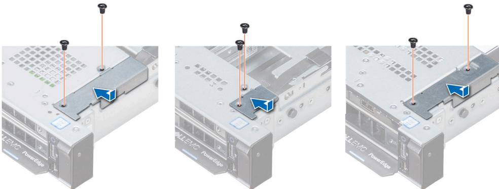
**Figure 120. Installation du cache-câbles**
