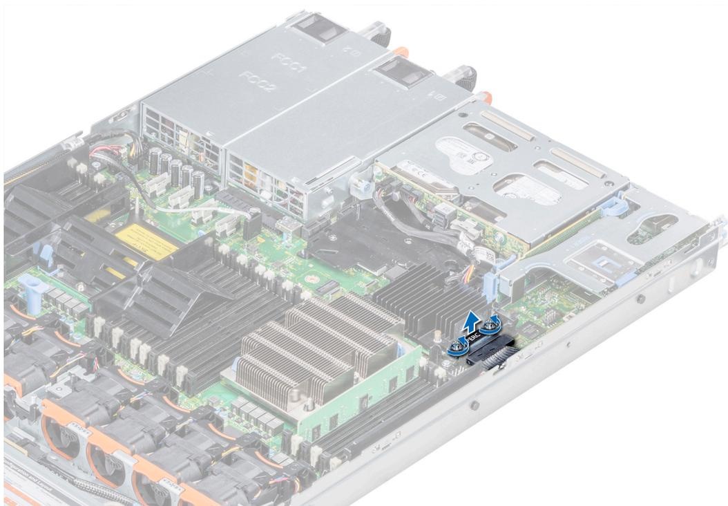
**Figure 76. Retrait du câble du contrôleur de stockage intégré**
