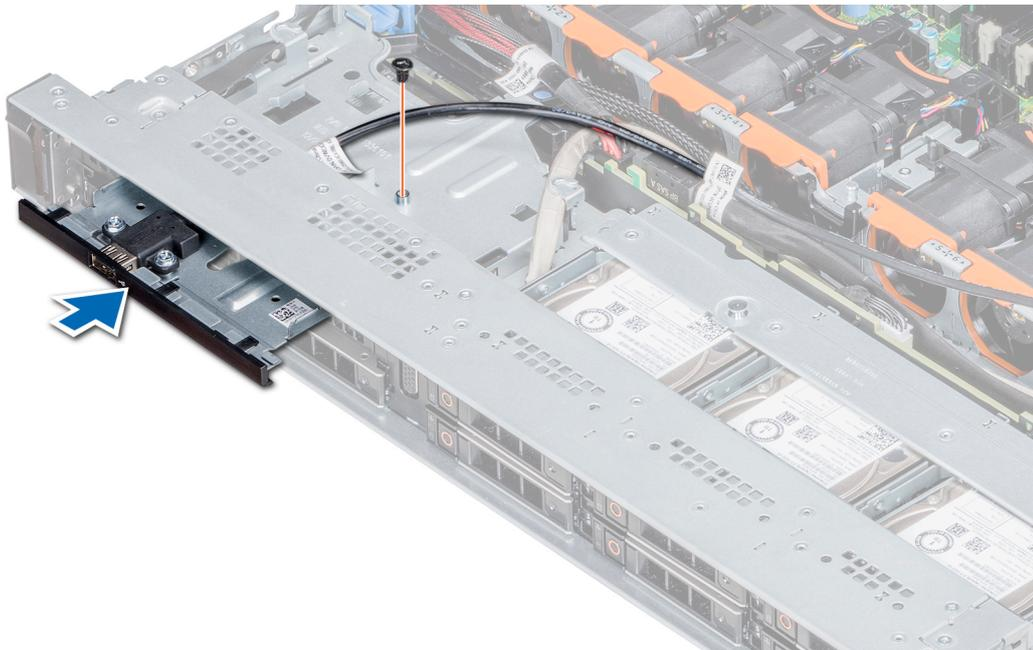
Figure 101. Installation du module USB
