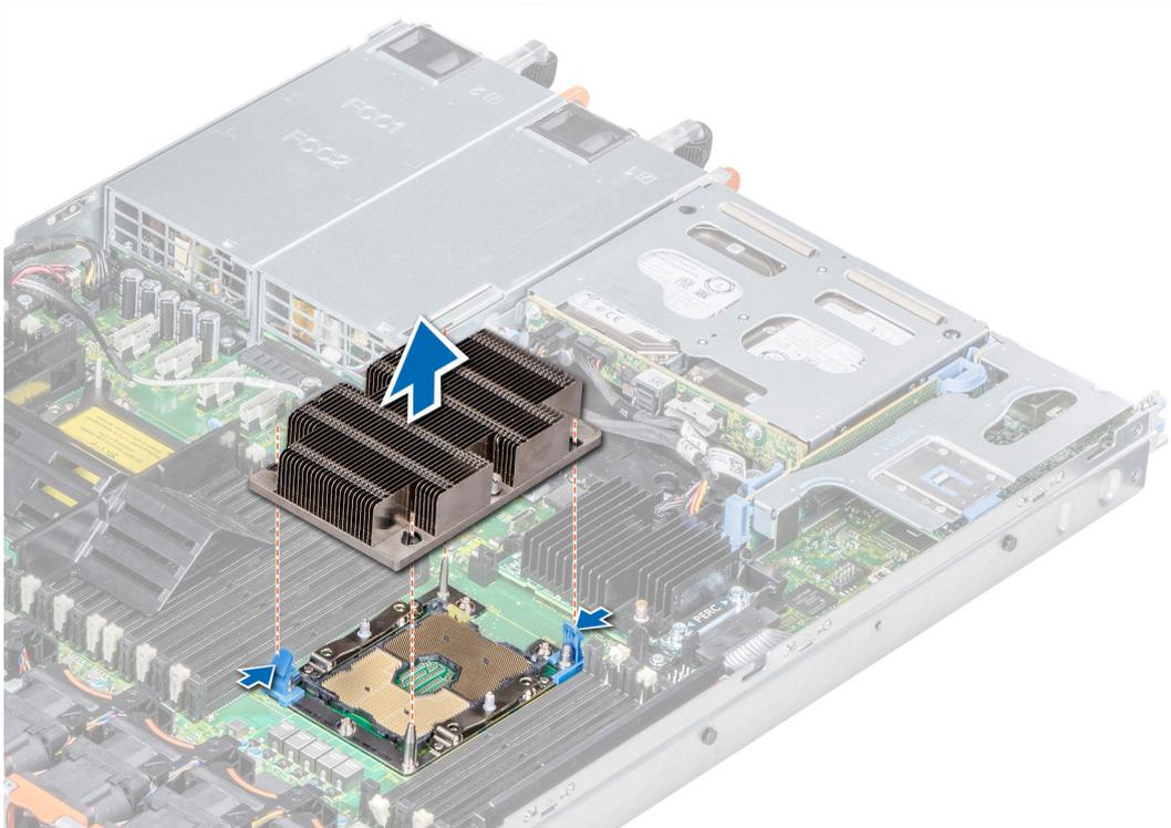
Figure 44. Retrait du module du processeur et du dissipateur de chaleur
