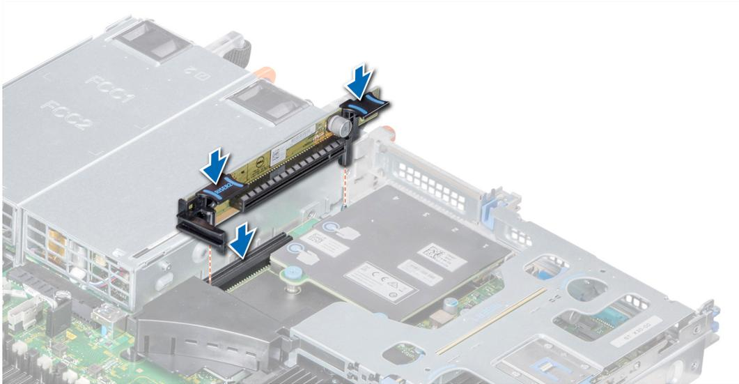
Figure 57. Installation de la carte de montage d'extension 2A
