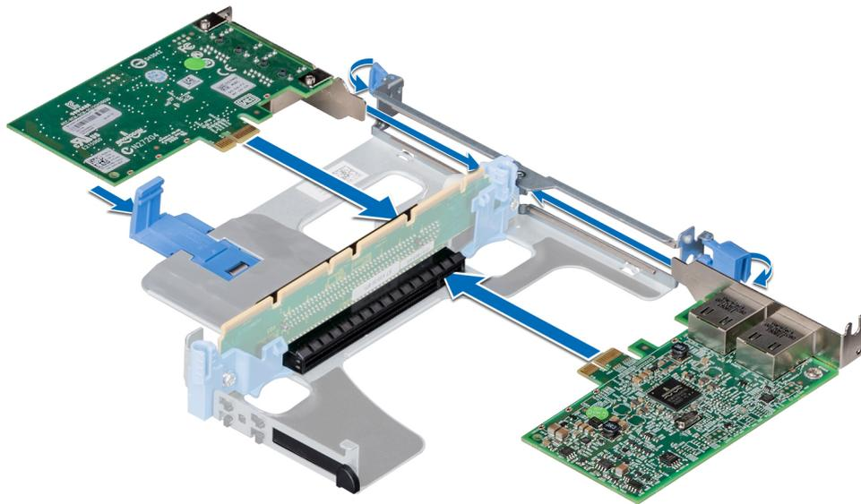
Figure 66. Installation de cartes d'extension dans la carte de montage 1A
