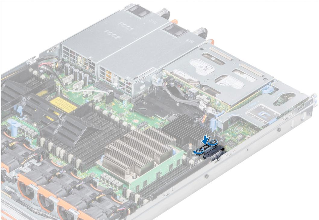
**Figure 79. Installation du câble de la carte contrôleur de stockage intégrée**
