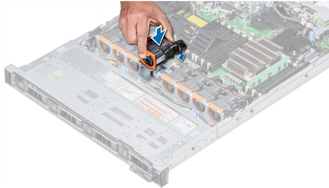
**Figure 38. Installation du ventilateur**
