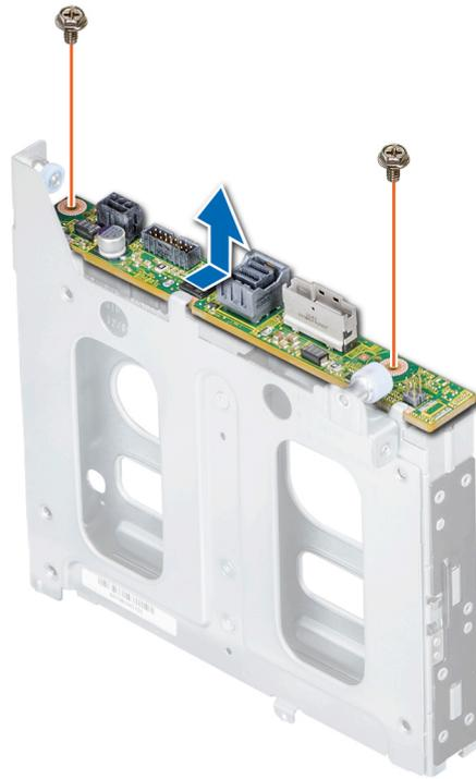
Figure 85. Retrait du backplane arrière des disques de 2,5 pouces
