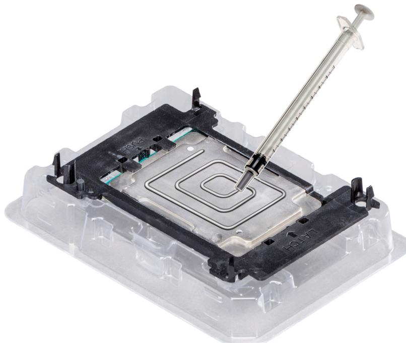
**Figure 48. Application de graisse thermique sur la partie supérieure du processeur**
