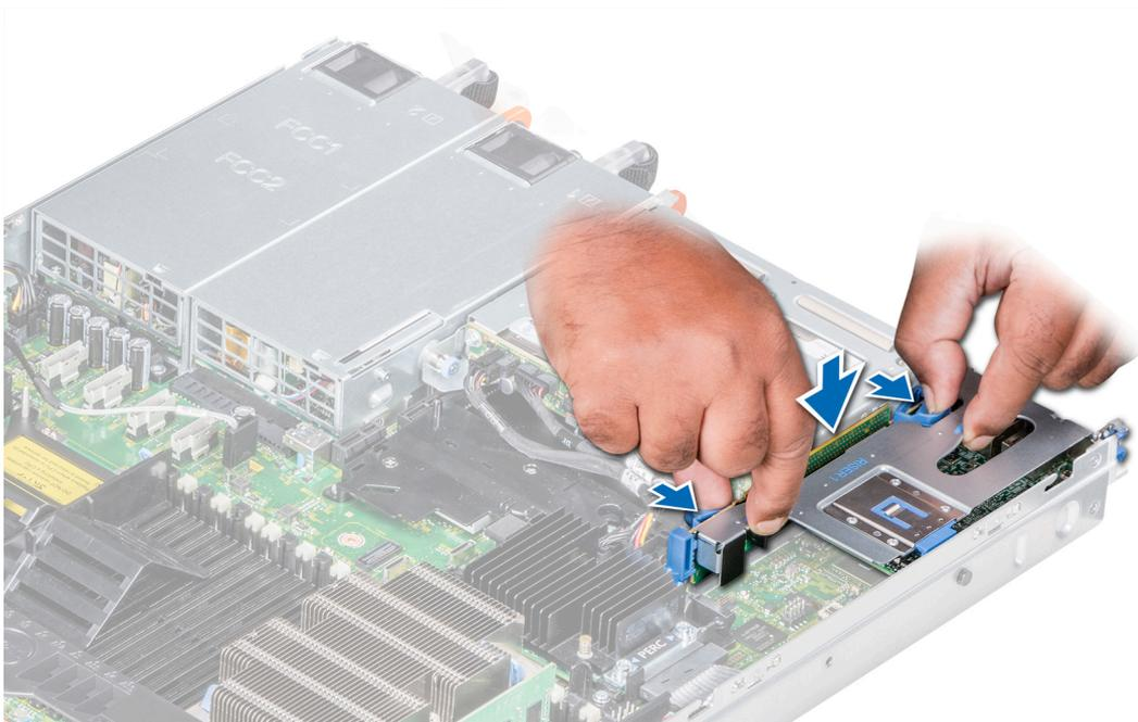
Figure 56. Installation de la carte de montage d'extension 1B
