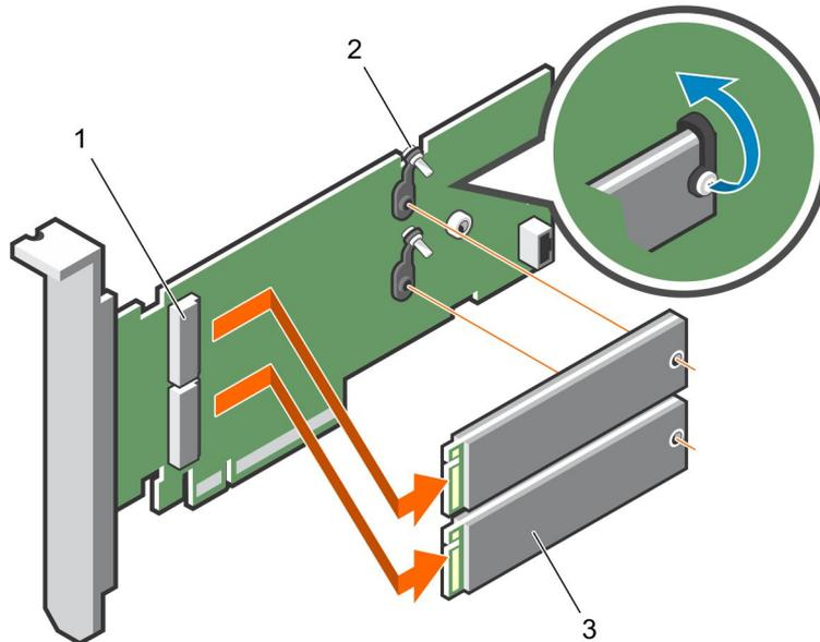
Figure 68. Retrait du module SSD M.2
