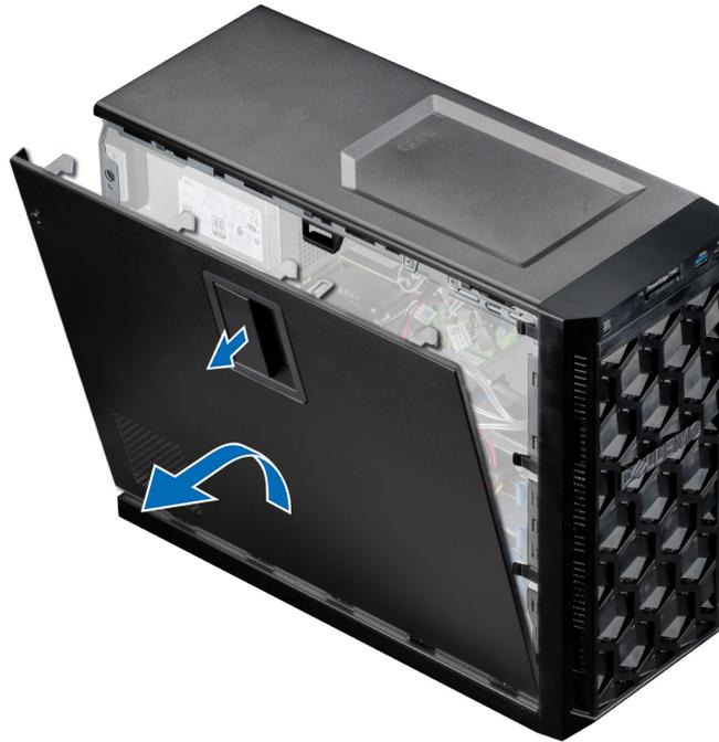
Abbildung 9. Entfernen der Systemabdeckung
