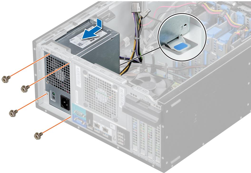
Abbildung 45. Installieren des Netzteils
