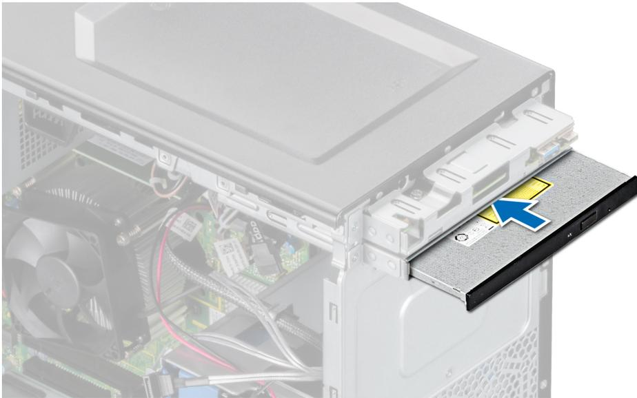
Abbildung 22. Installieren des optischen Laufwerks
