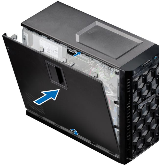
Abbildung 10. Installieren der Systemabdeckung
