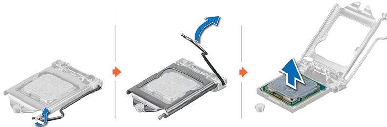
Abbildung 39. Entfernen des Prozessors
