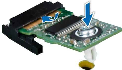
Abbildung 53. Installieren des TPM-Moduls
