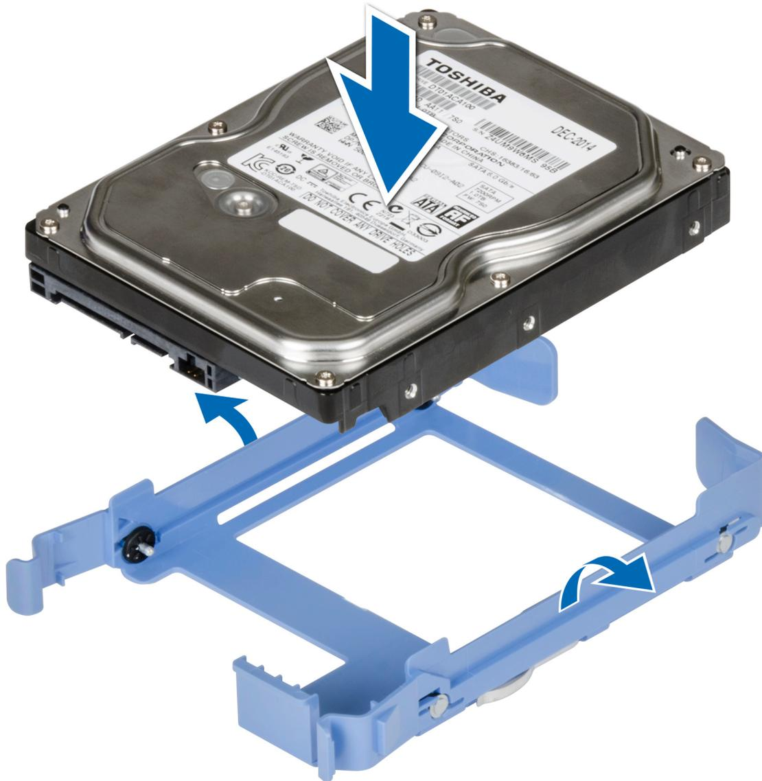
Abbildung 16. Einsetzen eines Laufwerks in den Laufwerksträger
