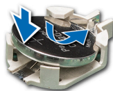
Abbildung 99. Installieren der Systembatterie
