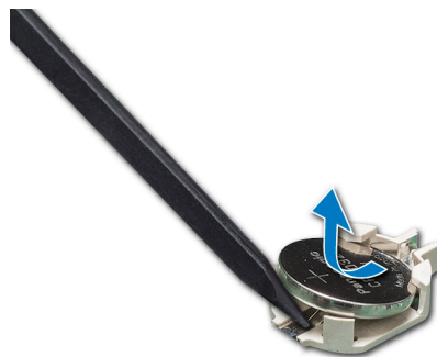
Abbildung 98. Entfernen der Systembatterie
