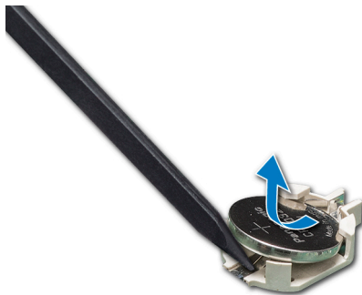
Abbildung 97. Entfernen der Systembatterie
