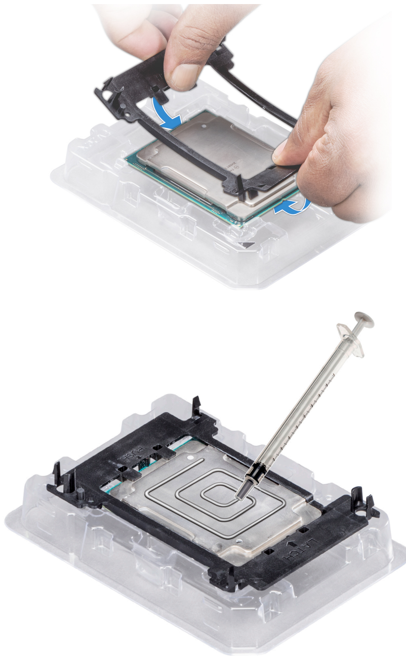
Abbildung 43. Auftragen von Wärmeleitpaste auf der Oberseite des Prozessors
