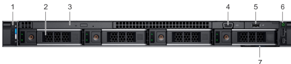
Abbildung 3. Vorderansicht eines Systems mit 4 x 3,5-Zoll-Laufwerk
