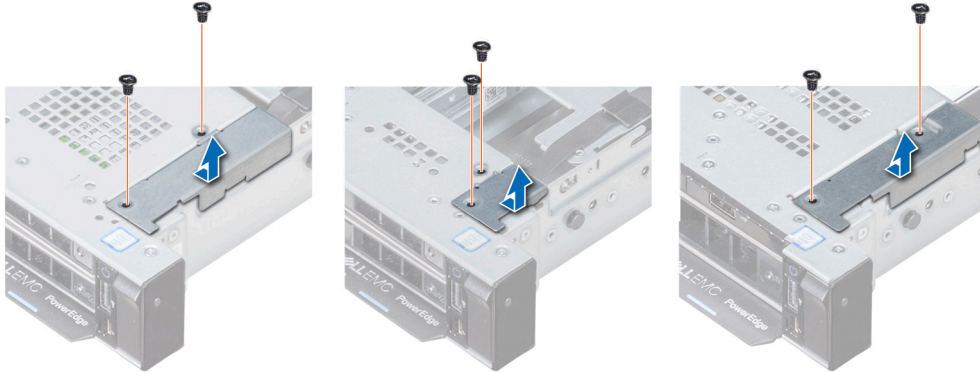
Abbildung 116. Entfernen der Kabelabdeckung
