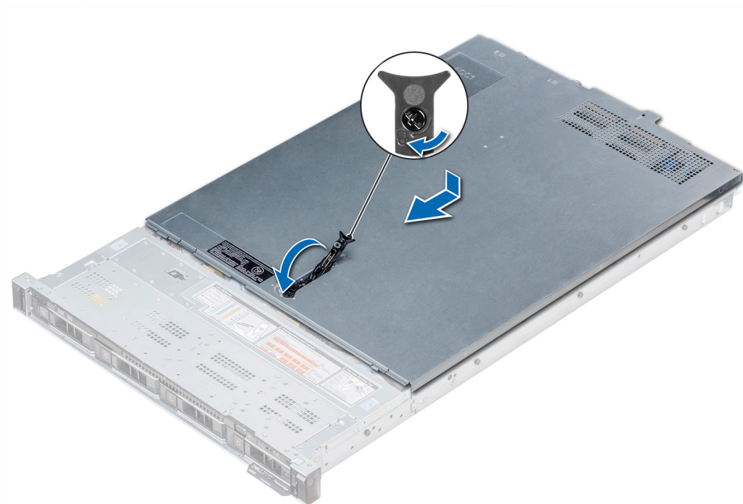
Abbildung 23. Installieren der Systemabdeckung
