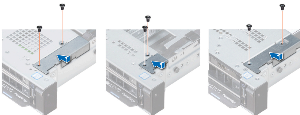
Ilustración 120. Instalación de la cubierta de cables
