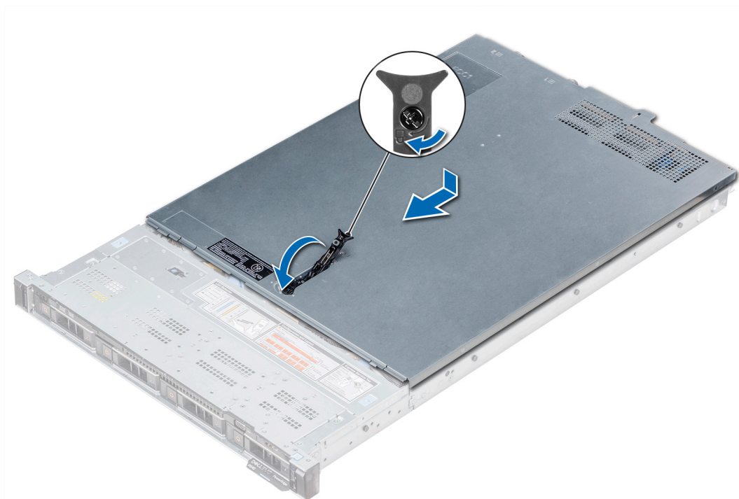
Ilustración 23. Instalación de la cubierta del sistema
