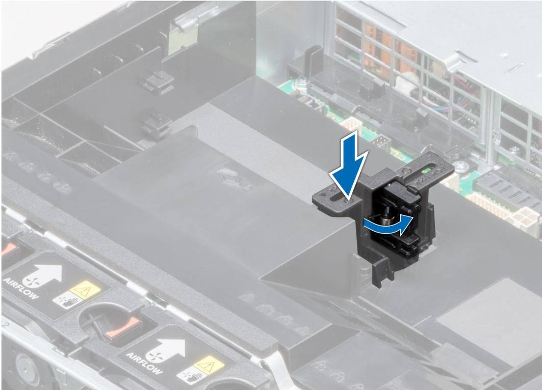
**Figure 65. Ouverture du loquet du support de carte PCIe**
