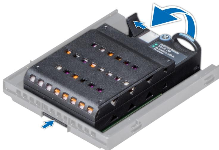
Figure 44. Retrait de la pile du NVDIMM-N du support
