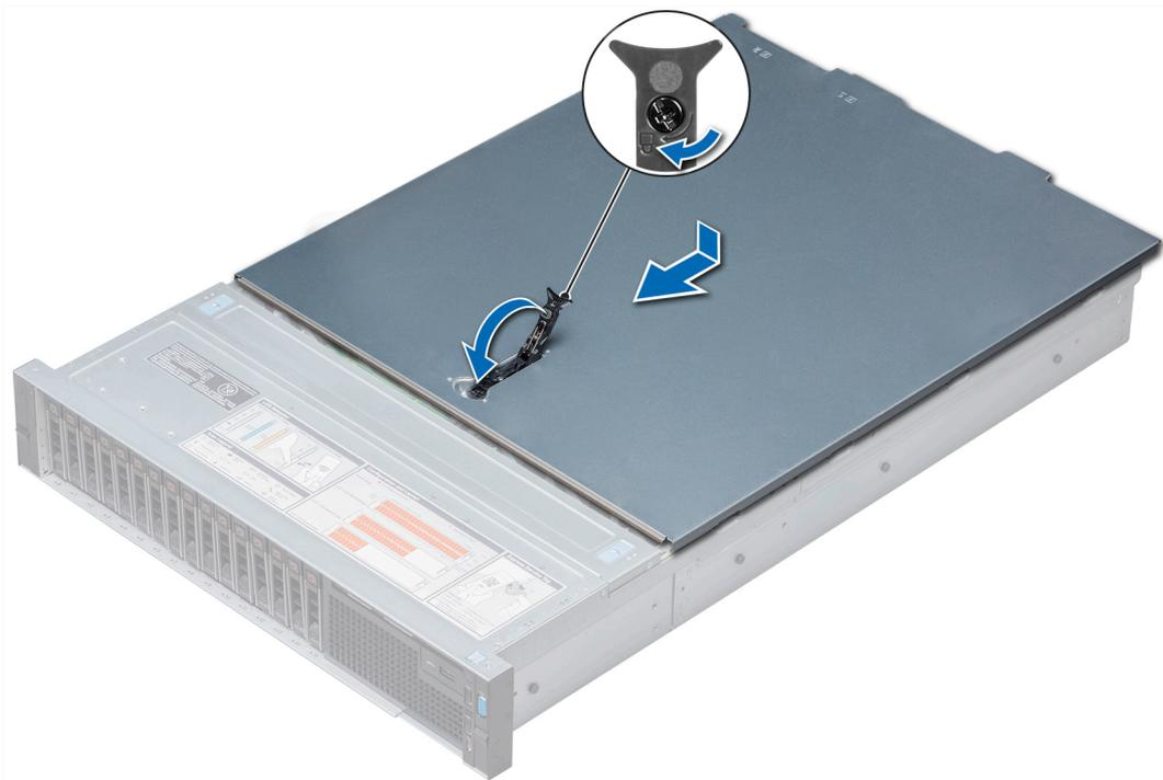
Figure 27. Installation du capot du système
