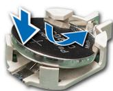
Figure 122. Installation de la pile du système
