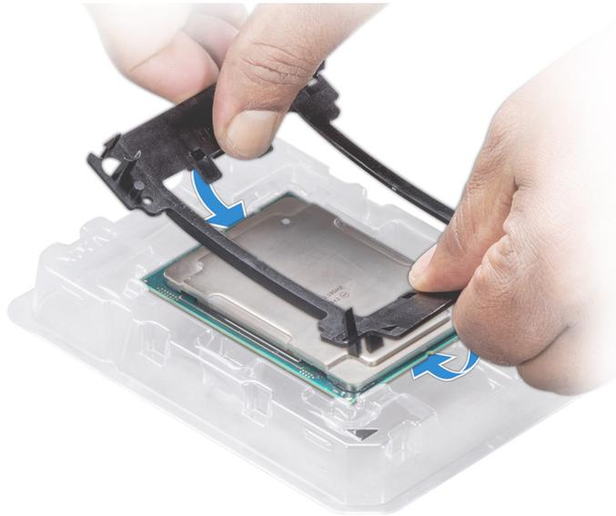
**Figure 61. Installation du support de processeur**
