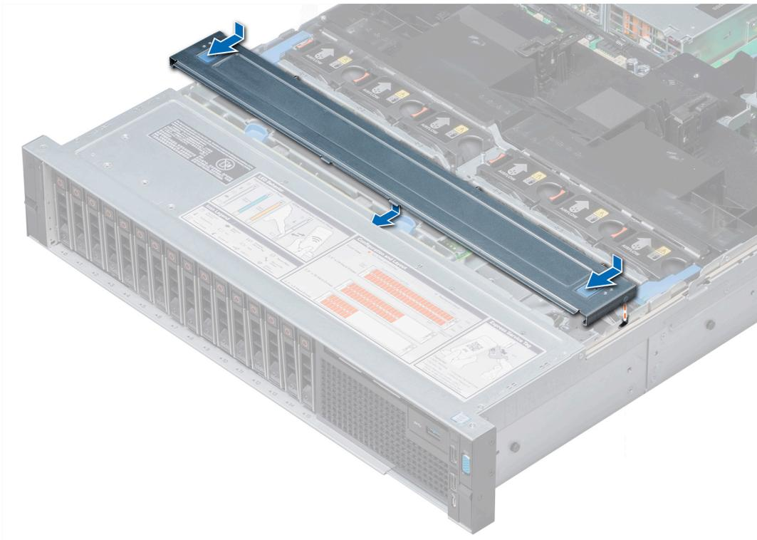
Figure 29. Installation du cache de fond de panier
