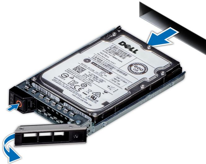
Figure 48. Retrait d'un support de disque
