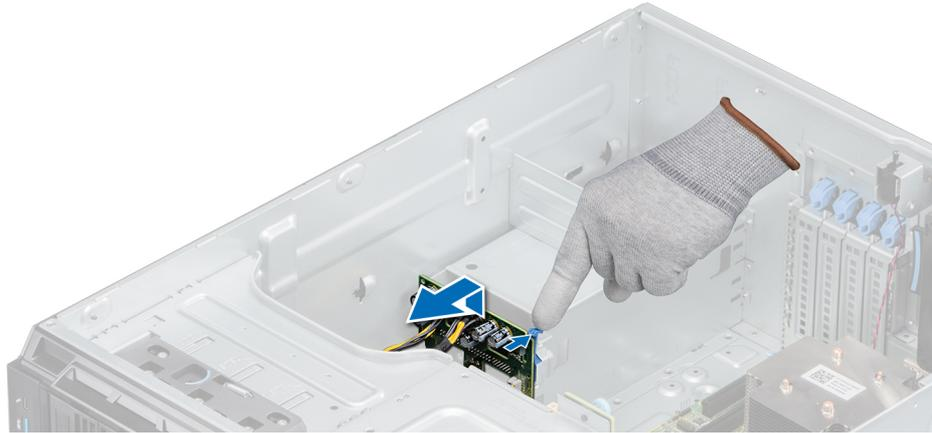
Abbildung 76. Entfernen der Stromzwischenplatte
