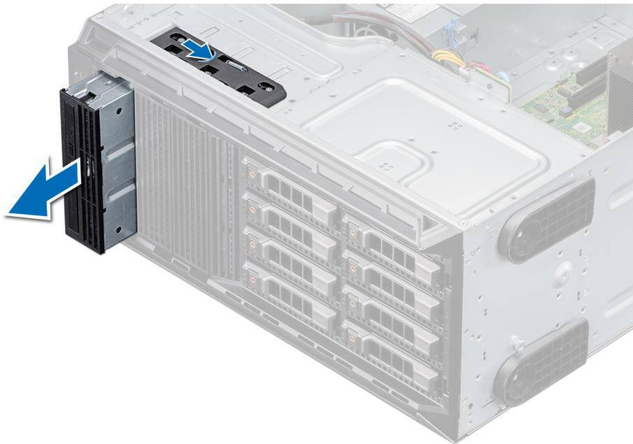
Abbildung 40. Entfernen des optischen Laufwerks
