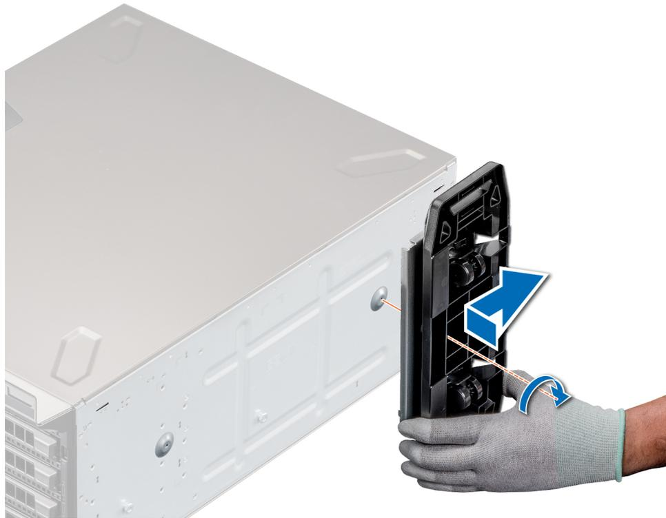
Abbildung 21. Installieren von Gleitrollen
