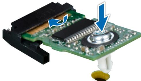
Abbildung 83. Installieren des TPM-Moduls
