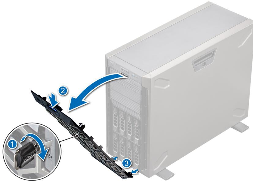
Abbildung 17. Entfernen der Frontverkleidung
