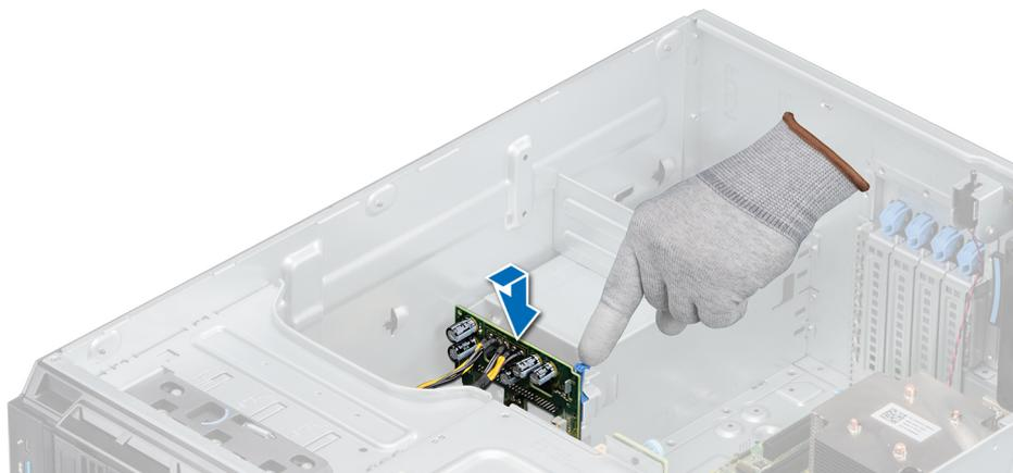
Abbildung 77. Installieren der Stromzwischenplatte
