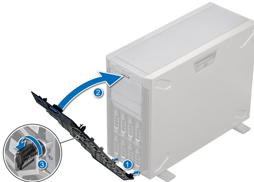
Abbildung 18. Installieren der Frontverkleidung
