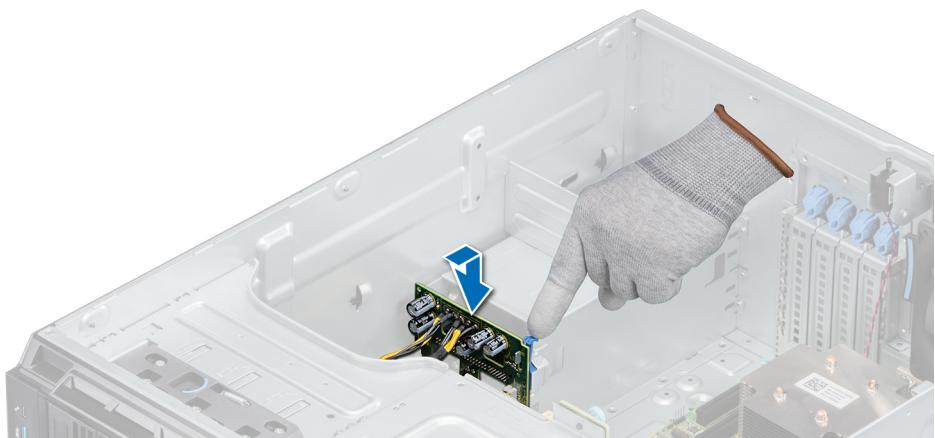
Abbildung 77. Installieren der Stromzwischenplatine
