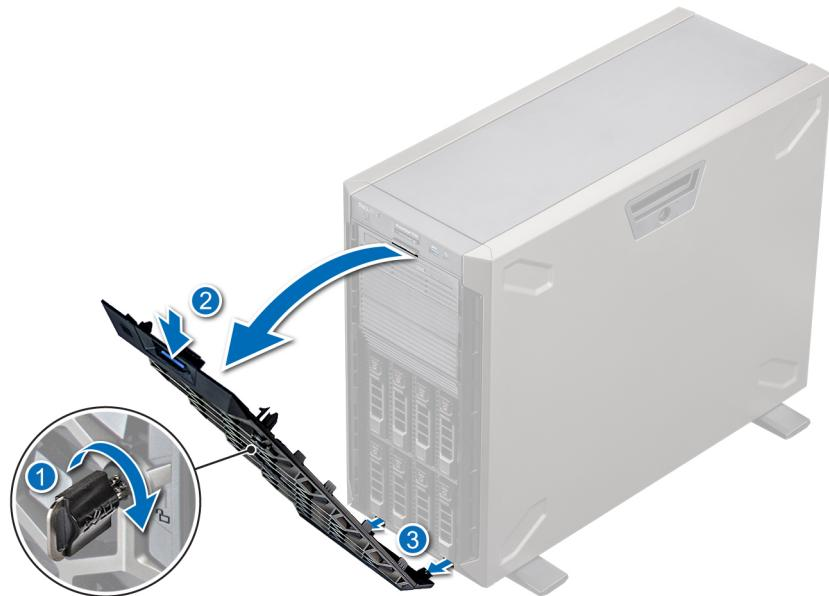
Abbildung 17. Entfernen der Frontverkleidung
