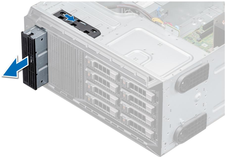
**Abbildung 40. Entfernen des optischen Laufwerks**
