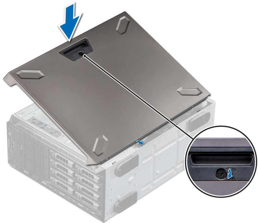
**Abbildung 23. Installieren der Systemabdeckung**
