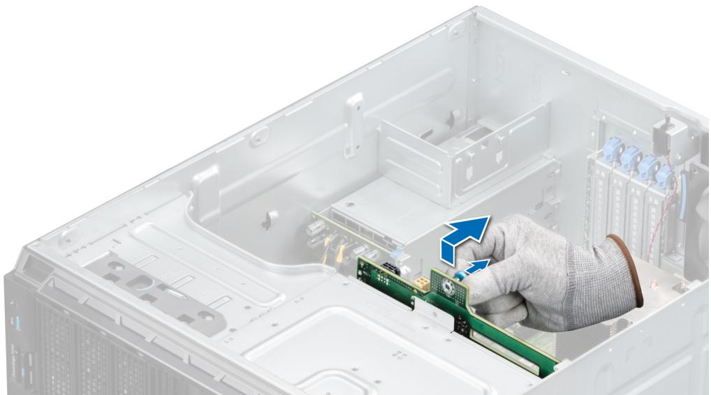
**Abbildung 45. Entfernen der Laufwerkrückwandplatine**
