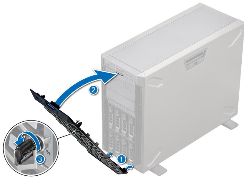
Abbildung 18. Installieren der Frontverkleidung
