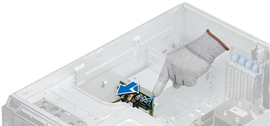
Abbildung 76. Entfernen der Stromzwischenplatine
