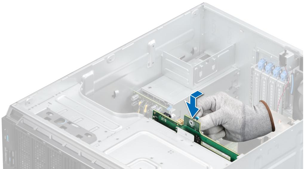
Abbildung 46. Installieren der Laufwerkrückwandplatine
