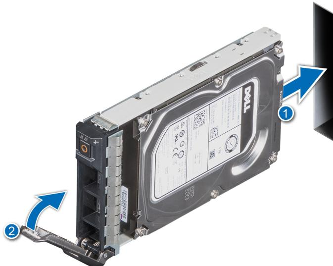
Abbildung 31. Installieren eines Laufwerkträgers
