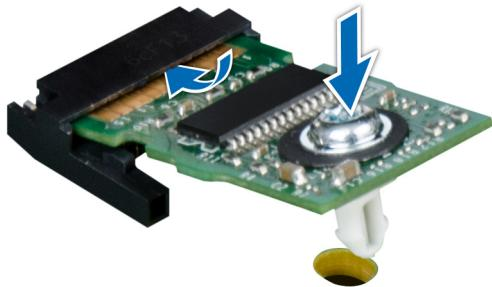
**Abbildung 83. Installieren des TPM-Moduls**
