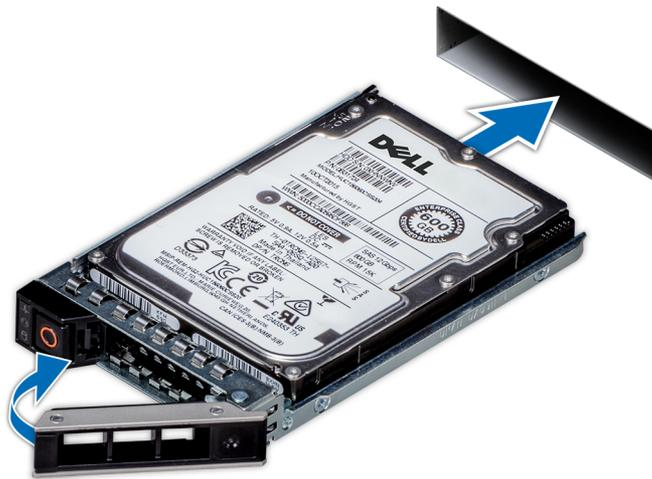
Figura 49. Instalación de un portaunidades
