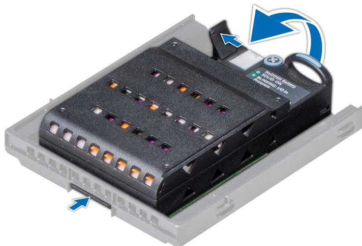
Figura 44. Extracción de la batería NVDIMM-N del soporte
