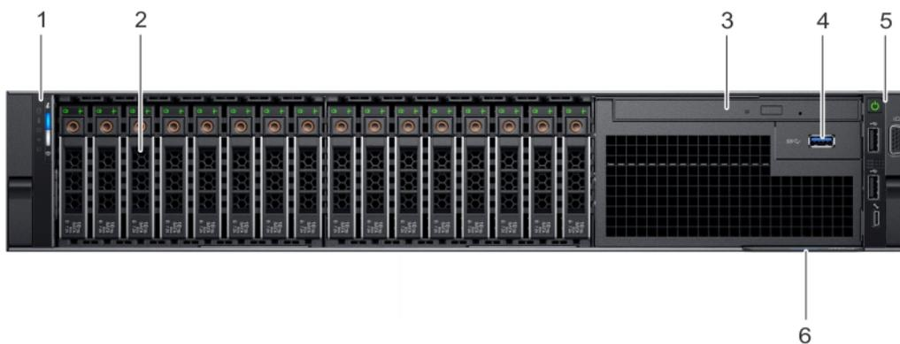
**Figura 2. Vista frontal del sistema de unidades de 16 x 2.5 pulgadas**
