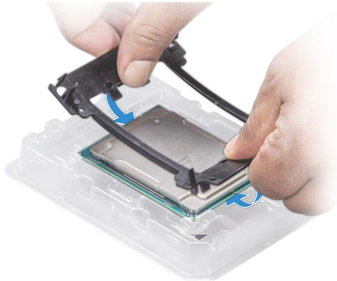
Figura 61. Instalación del soporte del procesador
