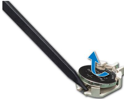
**Figura 121. Extracción de la batería del sistema**
