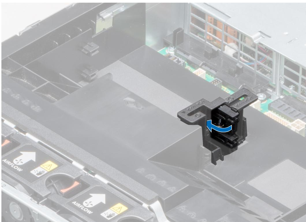
**Figura 66. Cierre del pestillo del soporte de tarjeta PCIe**
