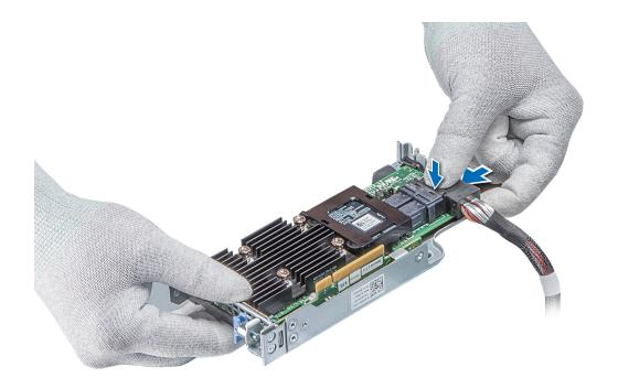
Figure 71. Connexion du câble à la carte de montage PERC interne
