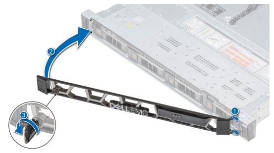
Figure 18. Installation du cadre avant avec le panneau LCD
