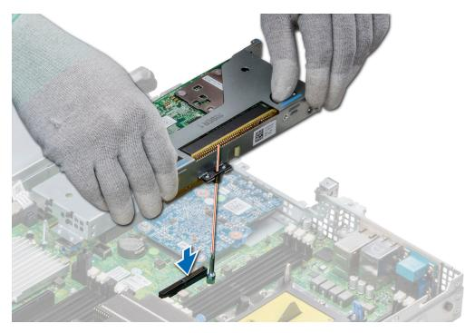
Figure 56. Installation d'une carte de montage pour carte d'extension 1
