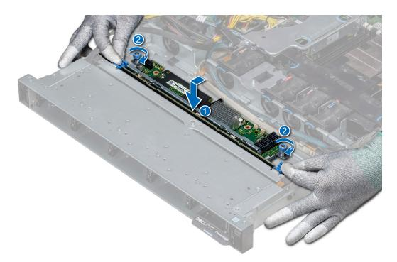
Figure 85. Installation du fond de panier de disque dur
