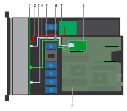
Figure 89. Acheminement des câbles : backplane de 8 disques durs de 2,5 pouces avec carte PERC
