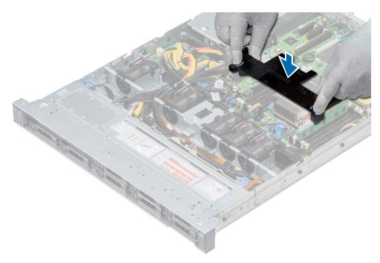
Figure 25. Installation du carénage d'aération
