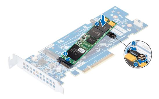
Figure 75. Installation du module SSD M.2
