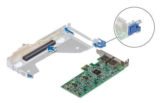
Figure 67. Installation d'une carte d'extension sur la carte de montage 2
