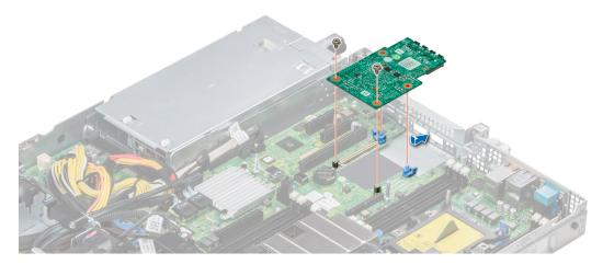
Figure 80. Installation de la carte de montage LOM
