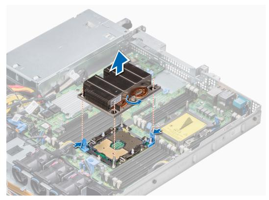
Figure 43. Retrait du module du processeur et du dissipateur de chaleur
