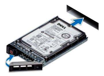
Figure 37. Installation d'un disque dur
