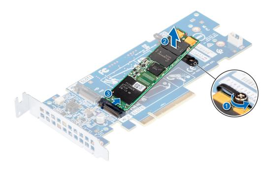
Figure 76. Retrait du module SSD M.2
