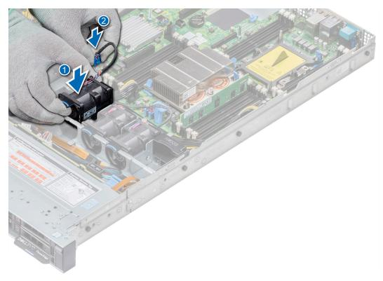
Figure 27. Installation du ventilateur de refroidissement
