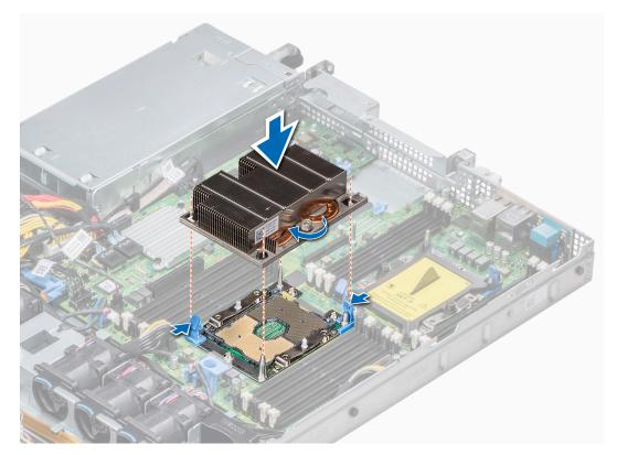
Figure 44. Installation du module du processeur et du dissipateur de chaleur
