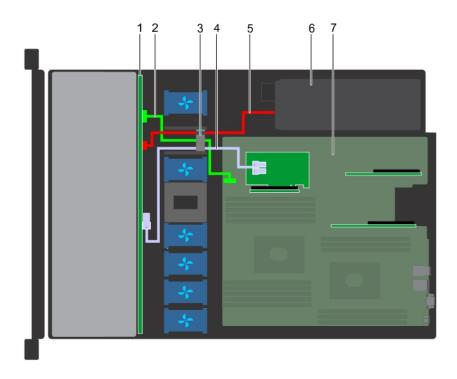
Figure 91. Acheminement des câbles : backplane de 4 disques durs de 3,5 pouces avec carte PERC
