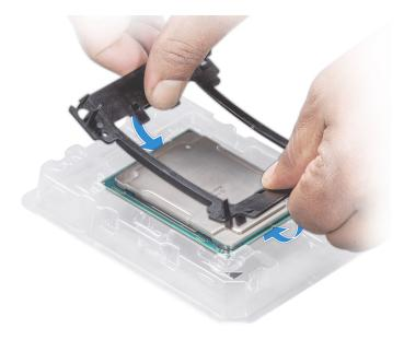
Figure 46. Installation du support de processeur
