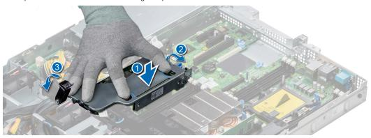
Figure 52. Installation de la carte de montage PERC interne
