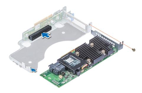
Figure 54. Installation d'une carte PERC sur une carte de montage PERC interne
