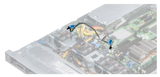
Figure 28. Retrait d'un commutateur d'intrusion
