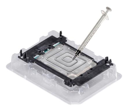
Figure 47. Application de graisse thermique sur la partie supérieure du processeur
