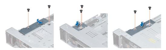
Figure 105. Installation du cache-câbles
