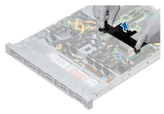
Figure 24. Retrait du carénage d'aération
