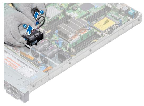
Figure 26. Retrait du ventilateur de refroidissement
