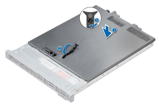
Figure 20. Installation du capot du système
