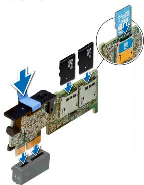
Figure 78. Installation de la carte IDSDM/vFlash (en option)
