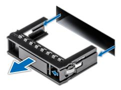
Figure 30. Retrait d'un cache de disque
