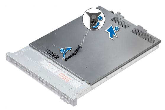
Figure 19. Retrait du capot du système
