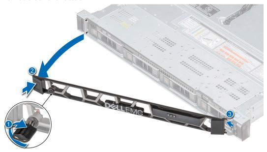
Figure 17. Retrait du cadre avant avec le panneau LCD
