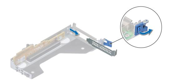
Figure 65. Retrait de la plaque de recouvrement pour la carte de montage 2
