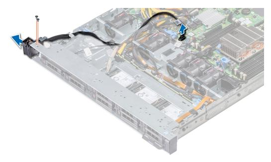
Figure 104. Retrait du panneau de commande de gauche
