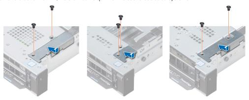
Figure 108. Installation du cache-câbles
