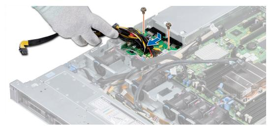
Figure 102. Installation de la carte interposeur d'alimentation
