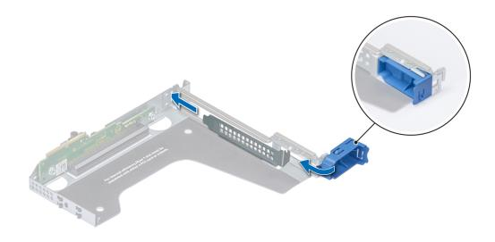
Figure 64. Installation de la plaque de recouvrement pour la carte de montage 1
