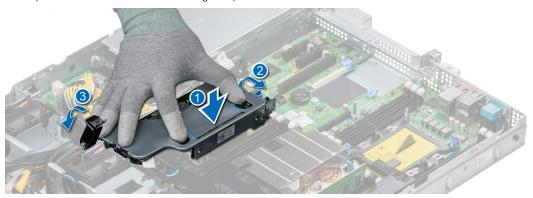
Figure 72. Installation de la carte de montage PERC interne
