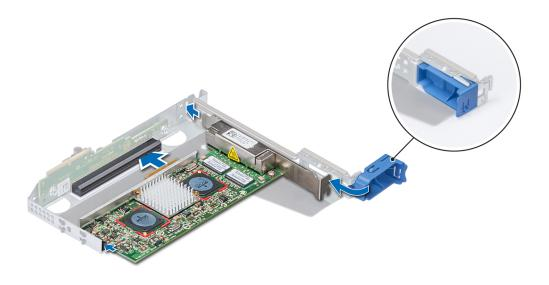
Figure 68. Installation d'une carte d'extension sur la carte de montage 1
