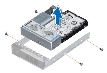
Figure 34. Retrait d'un adaptateur de disque de 3,5 pouces sur un support de disque de 3,5 pouces
