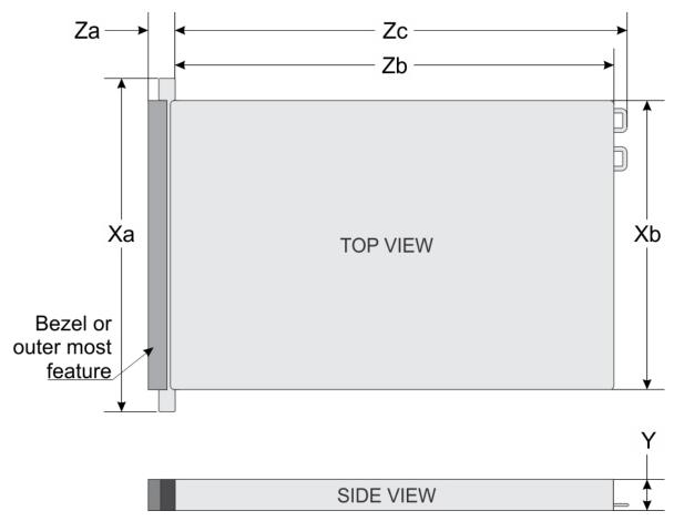
Figure 16. Dimensions du système Dell EMC PowerEdge R440
