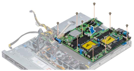
Figure 110. Installation de la carte système
