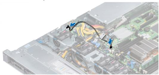
Figure 29. Installation d'un commutateur d'intrusion
