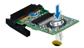
Figure 111. Installation du module TPM
