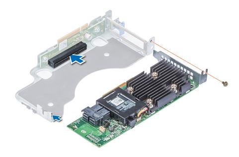
Figure 74. Installation d'une carte PERC sur une carte de montage PERC interne
