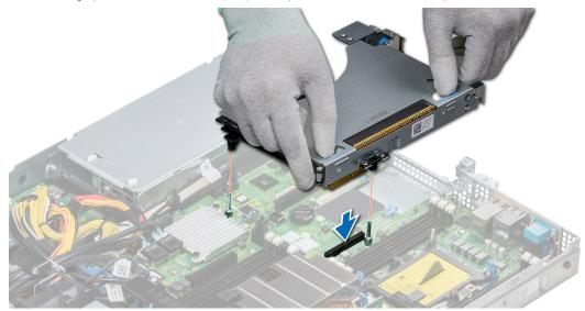
Figure 55. Installation d'une carte de montage pour carte d'extension 1A
