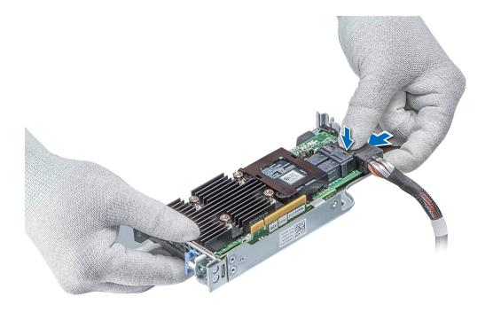
Figure 51. Connexion du câble à la carte de montage PERC interne
