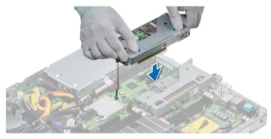
Figure 57. Installation d'une carte de montage pour carte d'extension 2
