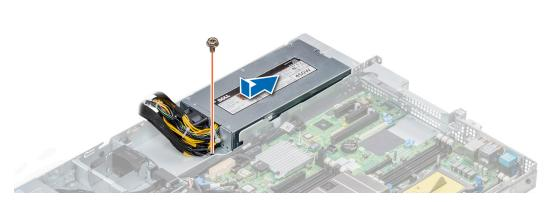
Figure 100. Installation d'un PSU secteur connecté non redondant
