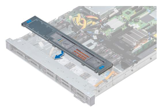
Figure 23. Installation du cache de fond de panier
