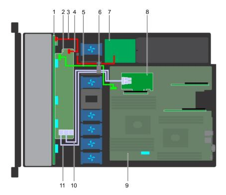
Figure 87. Acheminement des câbles : backplane de 10 disques durs de 2,5 pouces avec carte PERC
