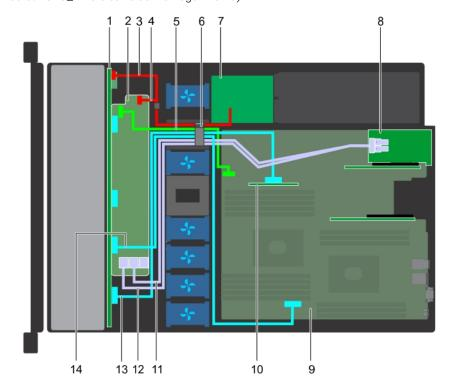
Figure 88. Acheminement des câbles : backplane de 10 disques durs de 2,5 pouces avec technologie NVMe
