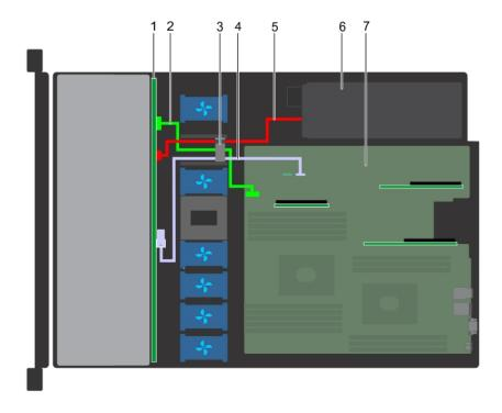
Figure 92. Acheminement des câbles : backplane de 4 disques durs de 3,5 pouces avec disque SATA
