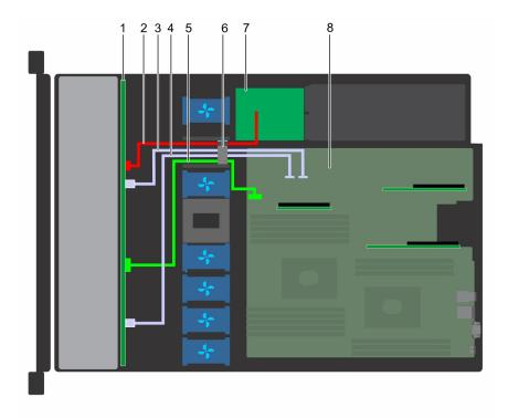
Figure 90. Acheminement des câbles : backplane de 8 disques durs de 2,5 pouces avec disque SATA intégré
