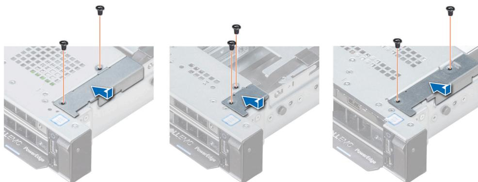
Figure 110. Installation du cache-câbles
