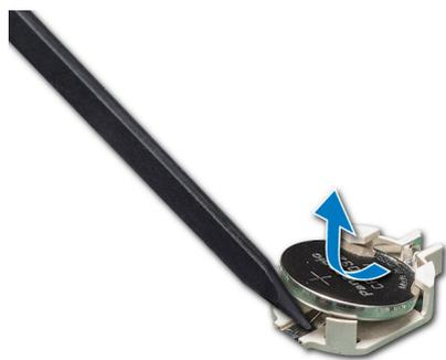
Figure 93. Retrait de la pile du système
