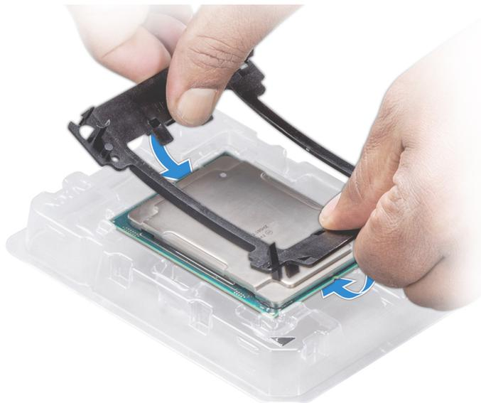
Figure 46. Installation du support de processeur
