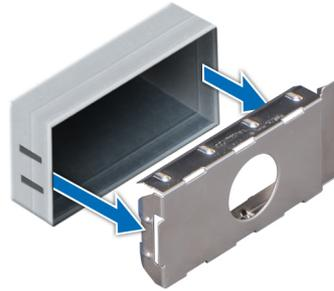
Figure 97. Retrait d'un cache de bloc d'alimentation
