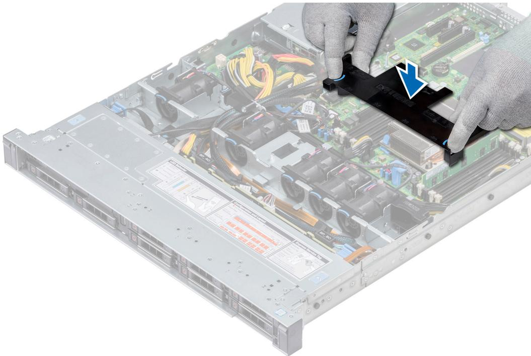
Figure 25. Installation du carénage d'aération
