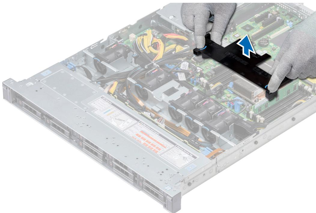
Figure 24. Retrait du carénage d'aération
