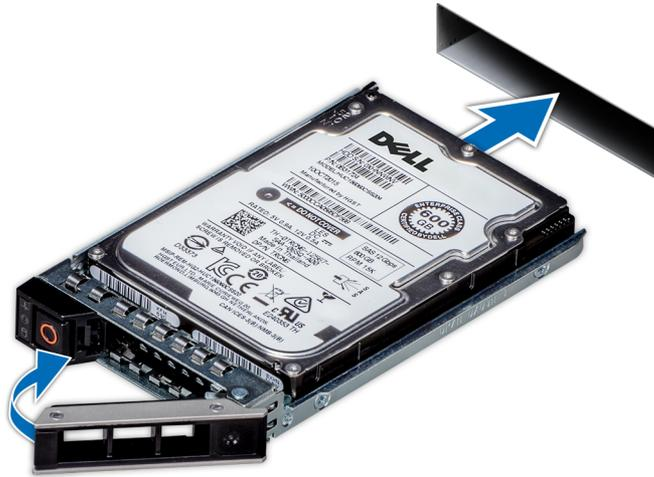
Figure 37. Installation d'un disque dur
