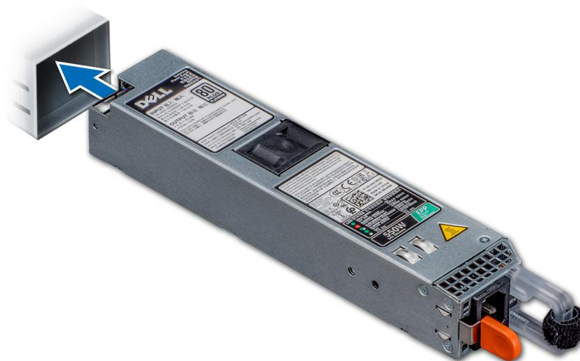
Figure 100. Installation d'une unité d'alimentation
