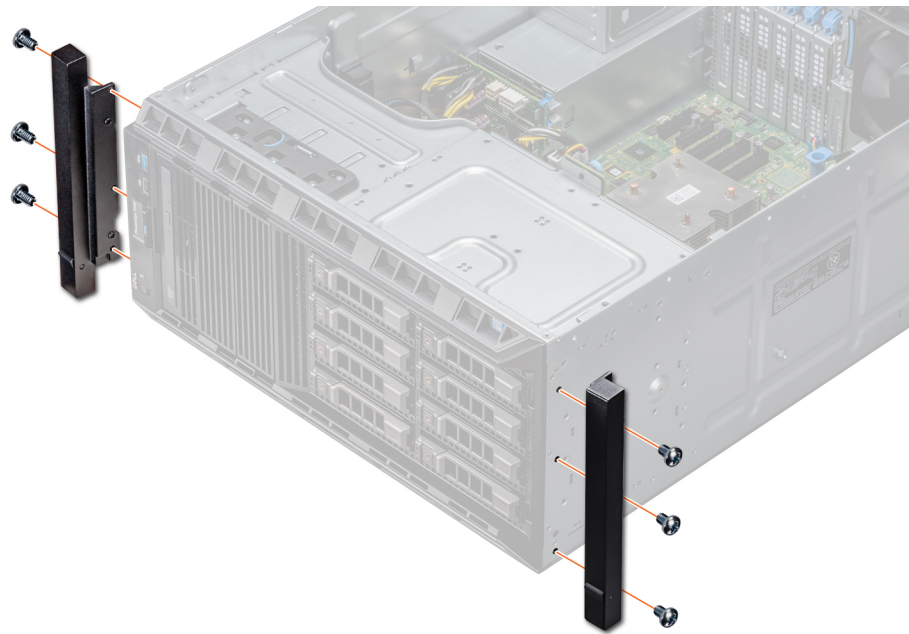
Abbildung 94. Installieren der Systemwinkel
