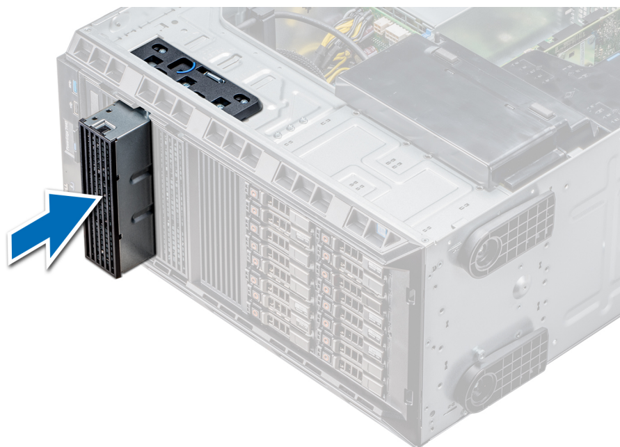
Abbildung 39. Installieren des Platzhalters für ein optisches Laufwerk oder Bandlaufwerk
