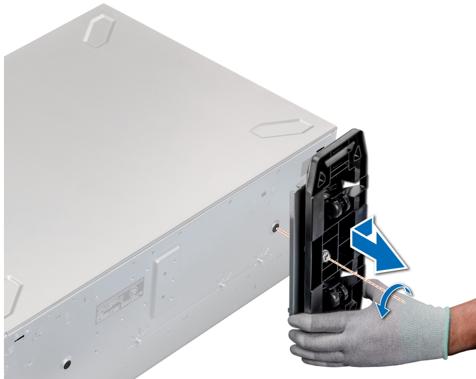
Abbildung 22. Entfernen von Gleitrollen
