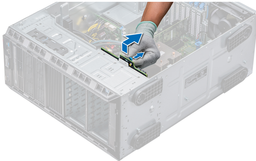
Abbildung 51. Entfernen einer Rückwandplatine
