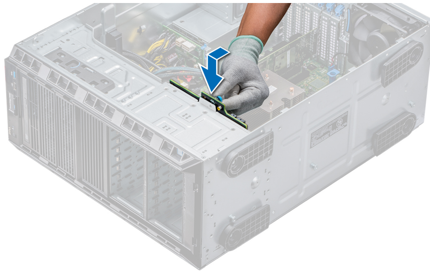
Abbildung 52. Installieren der Festplattenrückwandplatine
