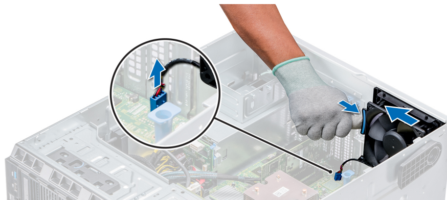
Abbildung 56. Entfernen des internen Lüfters
