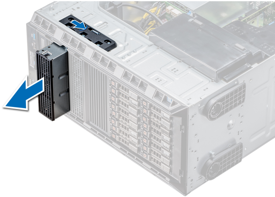
Abbildung 38. Entfernen des Platzhalters für das optische Laufwerk oder Bandlaufwerk
