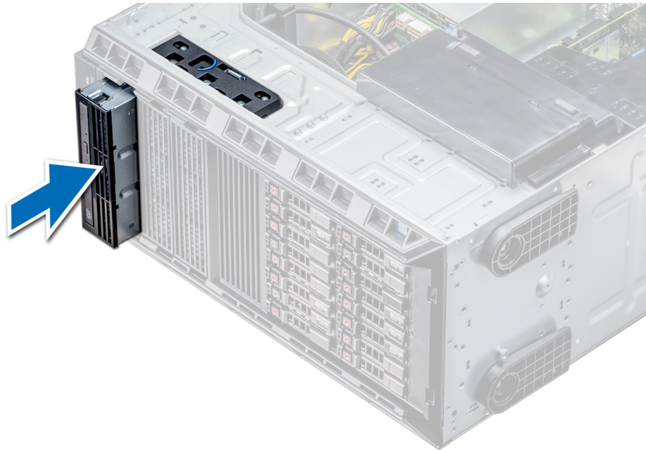
Abbildung 41. Installieren des optischen Laufwerkgehäuses oder Bandlaufwerks
