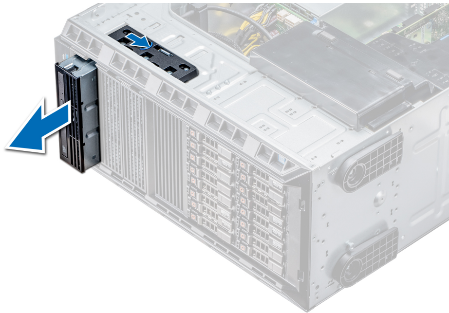
Abbildung 40. Entfernen des optischen Laufwerkgehäuses oder Bandlaufwerks
