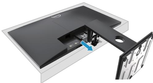
3. Desaperte o parafuso de aperto da base do suporte totalmente para remover a base do elevador.
