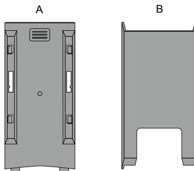
1. Alignez les pattes de (A) avec les pièces de fixation du pied.
