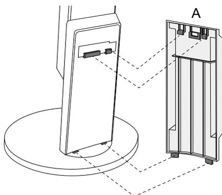
2. Faites glisser (A) vers le bas pour attacher les pattes aux éléments de fixation du pied.
