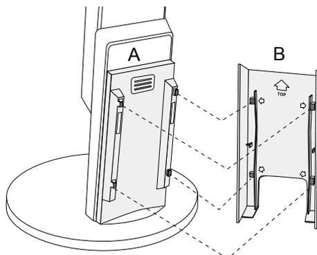
4. Passez les câbles entre (A) et (B) et alignez (B) avec (A) pour pouvoir l'insérer.
