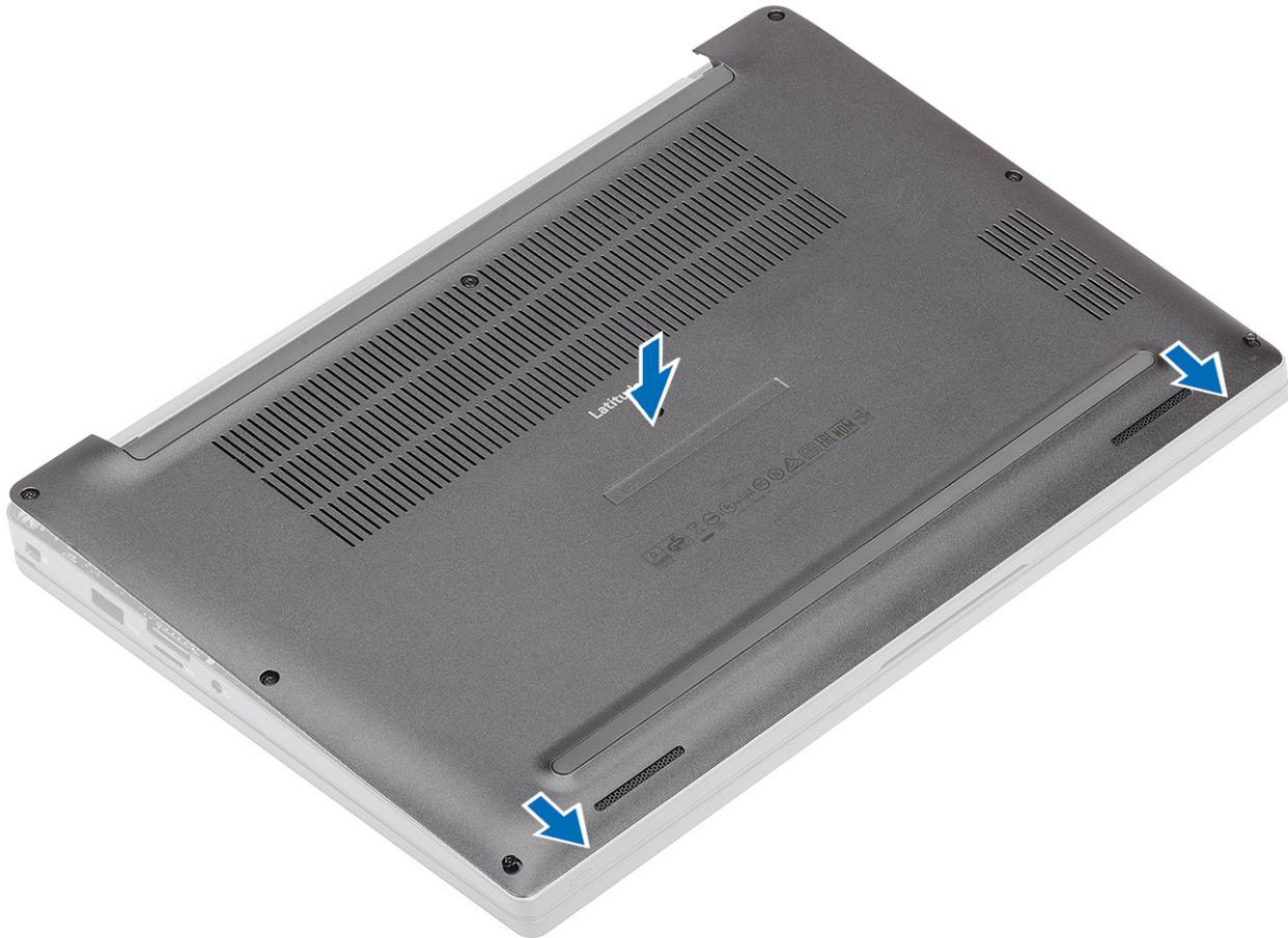
2. Drücken Sie entlang der Kanten der Bodenabdeckung, bis sie hörbar in die Handballenstützenbaugruppe einrastet.
