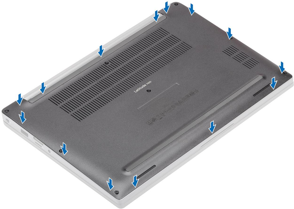
3. Ziehen Sie die acht unverlierbaren Schrauben fest, um die Bodenabdeckung am Computer zu befestigen.
