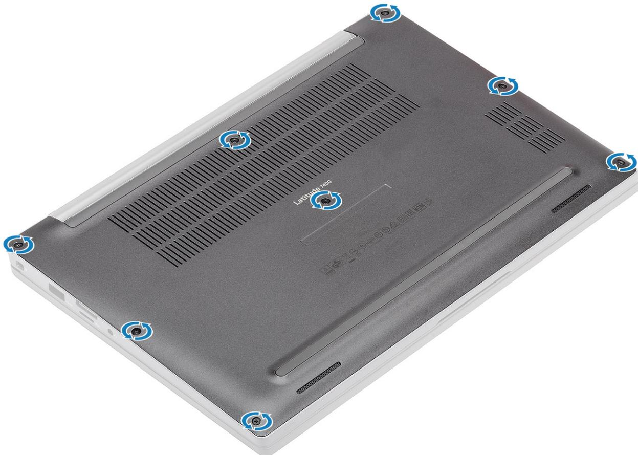
2. Verwenden Sie einen Stift aus Kunststoff, um die Bodenabdeckung an den Vertiefungen neben den Scharnieren links und rechts abzuhebeln [1].
