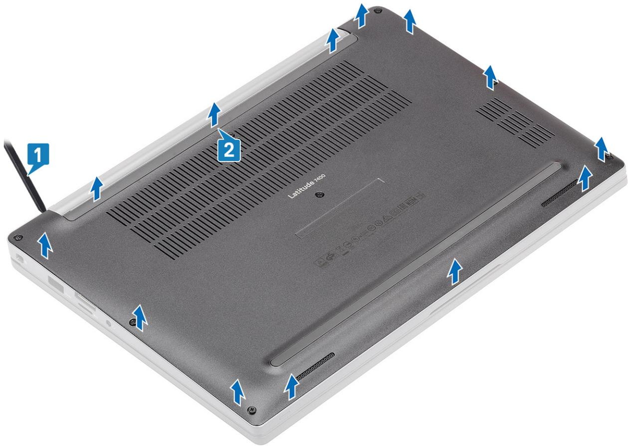
4. Heben Sie die Bodenabdeckung an und entfernen Sie sie vom Computer.
