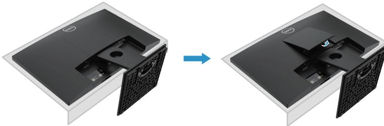
2. a. Verwenden sie einen langen und dünnen schraubendreher, um die entriegelung in einem loch direkt über dem ständer zu drücken.
