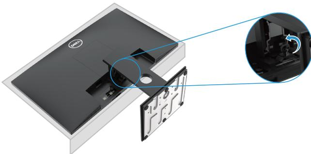
2. Schieben sie den ständer vollständig aus dem monitor.
