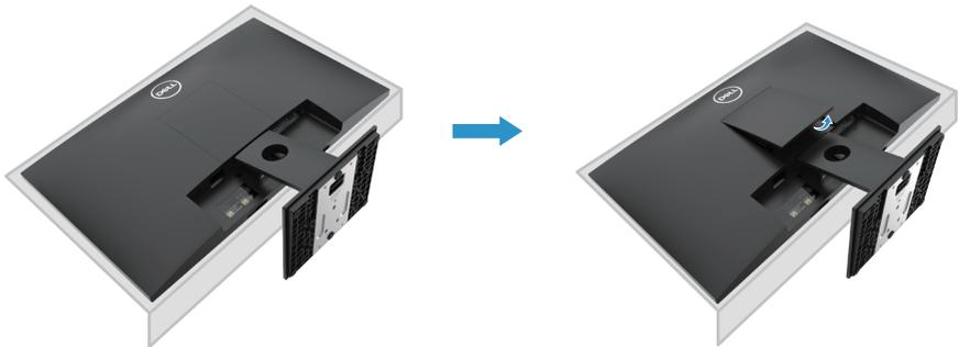
2. a. Verwenden sie einen langen und dünnen schraubendreher, um die entriegelung in einem loch direkt über dem ständer zu drücken.
