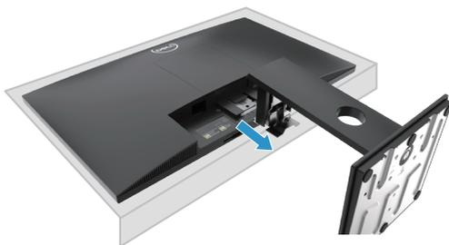
3. Lösen sie die daumenschraube der grundplatte vollständig, um die grundplatte aus der montageplatte zu entfernen.
