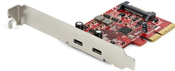
Esta tarjeta PCIe USB 3.2 Gen 2 se instala en una ranura PCI-Express disponible de su ordenador y le permite actualizar su sistema existente agregando dos puertos USB-C™ (10Gbps).
