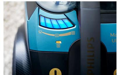
Der PowerMax-Sensor informiert Sie, wenn der Filter gereinigt werden muss, um die maximale Saugleistung zu gewährleisten.
