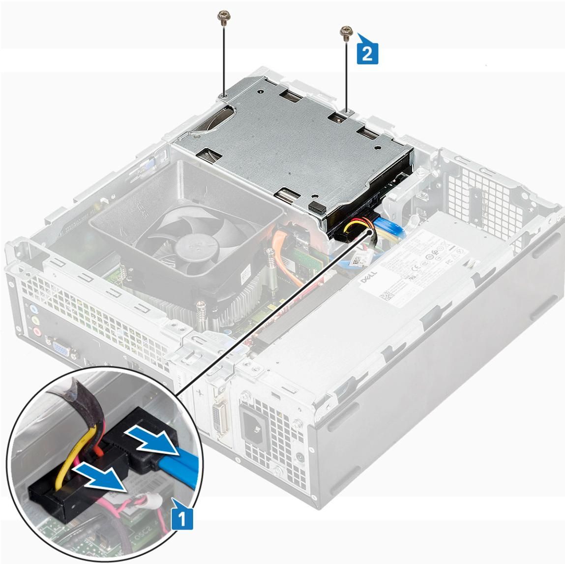
5. Heben Sie das 3,5-Zoll-Festplattengehäuse vom System ab.
