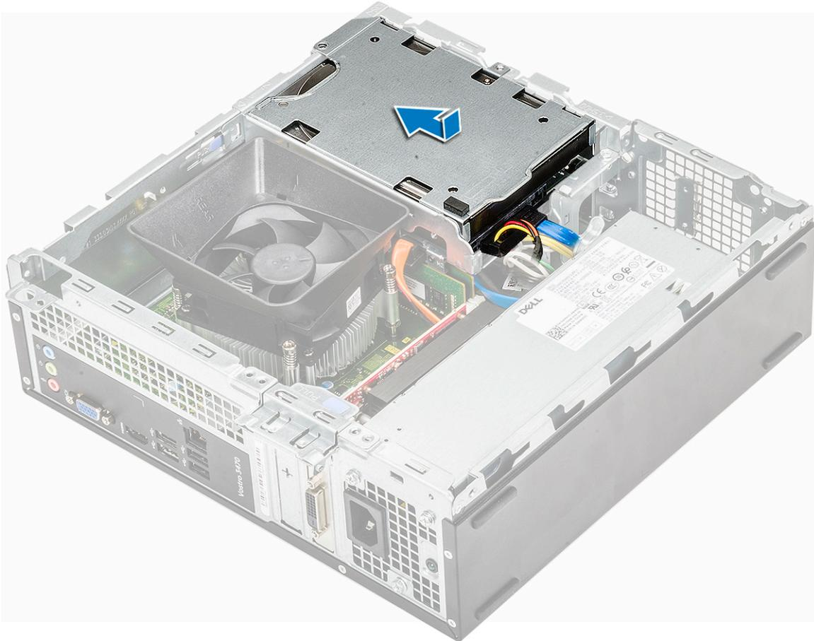
2. Setzen Sie die zwei 6-32xL35 Schrauben wieder ein, mit denen das 3,5-Zoll-Festplattengehäuse am Computer befestigt ist [1].
