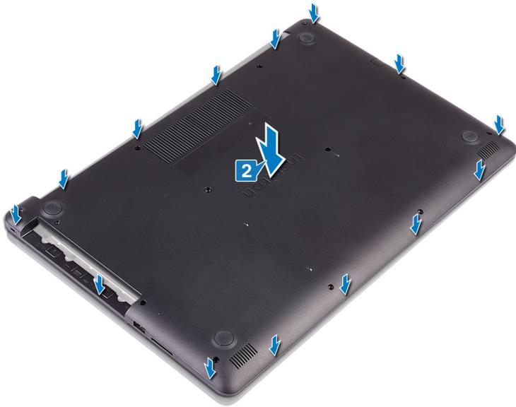
3. Reemplace los seis tornillos (M2.5x7) que fijan la cubierta de la base al ensamblaje del teclado y el reposamanos.
