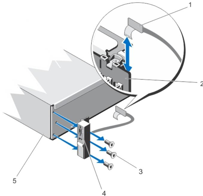
**Ilustración 49. Extracción e instalación del ensamblaje del panel de E/S**
