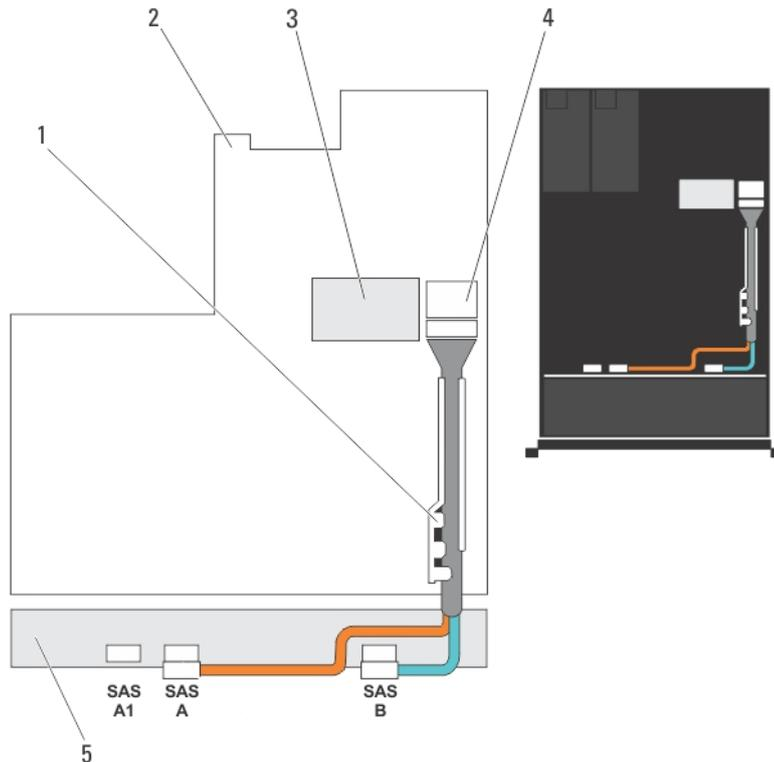
**Ilustración 45. Diagrama de cableado: plano posterior SAS/SATA (x12) de 3,5 pulgadas**
