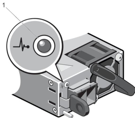
**Ilustración 6. Indicador de estado de la fuente de alimentación de CC**
