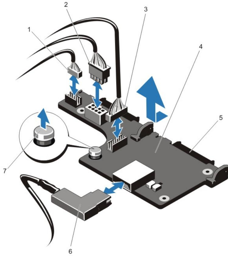
**Ilustración 46. Extracción e instalación del plano posterior de la unidad de disco duro (x2) opcional de 2,5 pulgadas**
