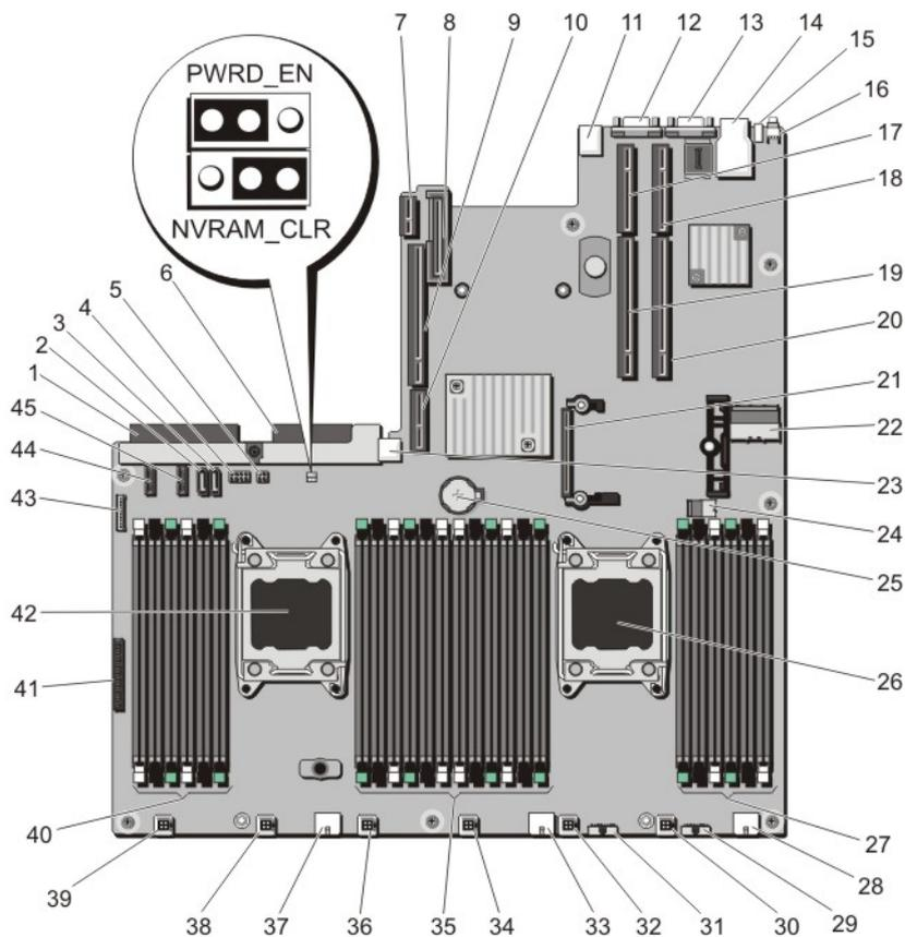
Ilustración 51. Puentes y conectores de la placa base
