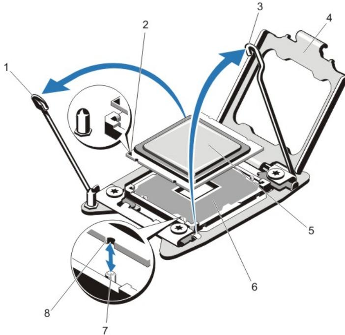
**Ilustración 37. Extracción e instalación de un procesador**
