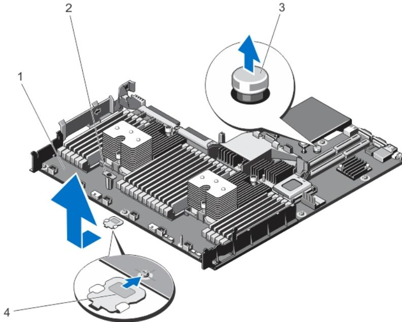
**Ilustración 50. Extracción e instalación de la placa base**
