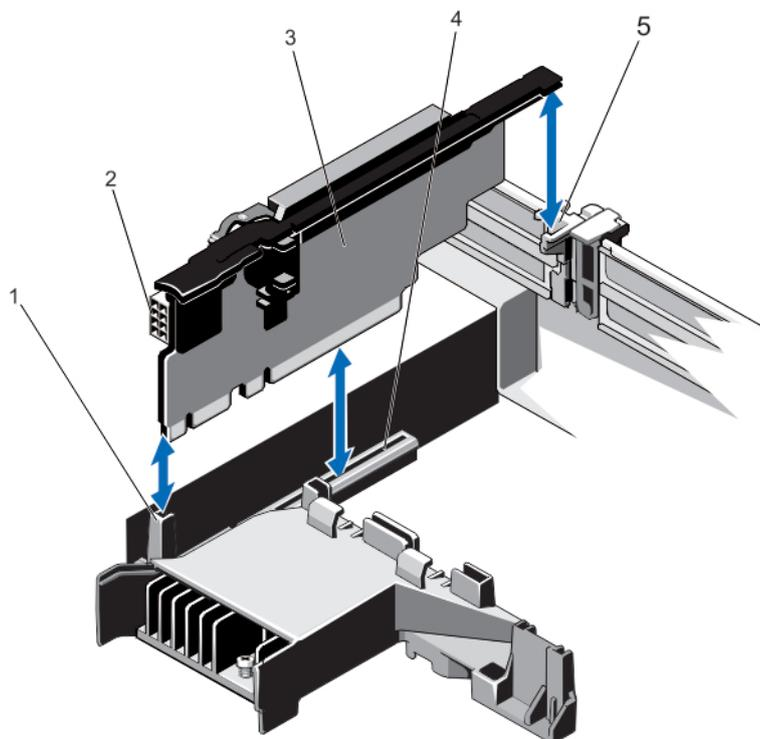
**Ilustración 28. Extracción e instalación del soporte vertical 3 para tarjetas de expansión**
