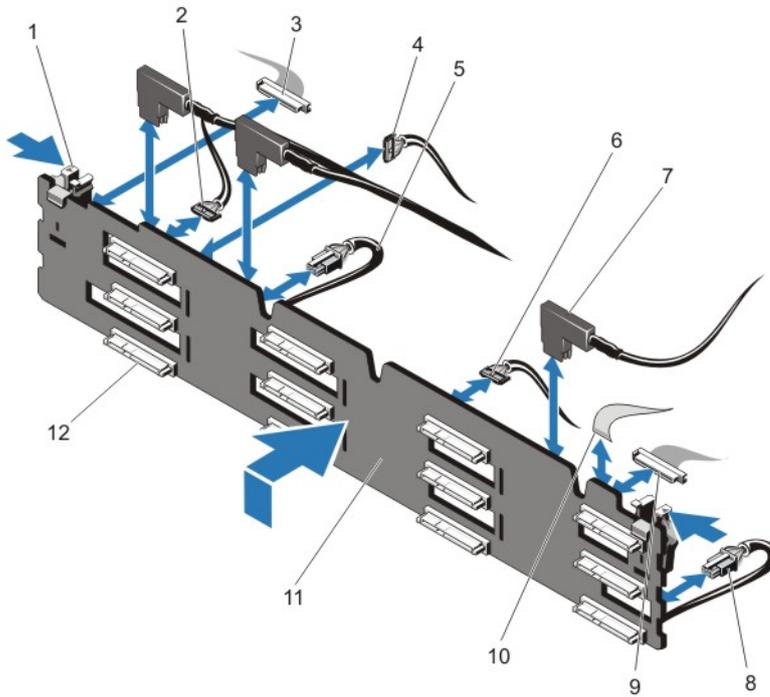
**Ilustración 44. Extracción e instalación del plano posterior SAS/SATA (x12) de 3,5 pulgadas**
