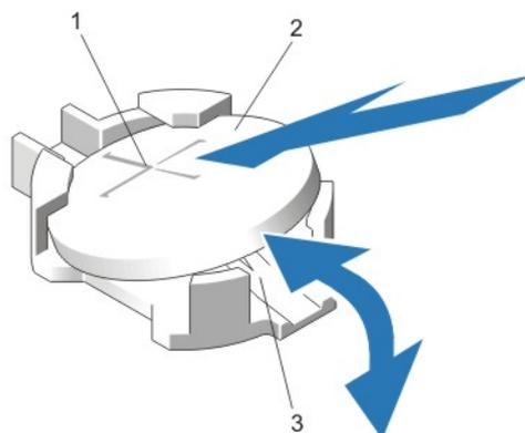
**Ilustración 43. Sustitución de la pila del sistema**
