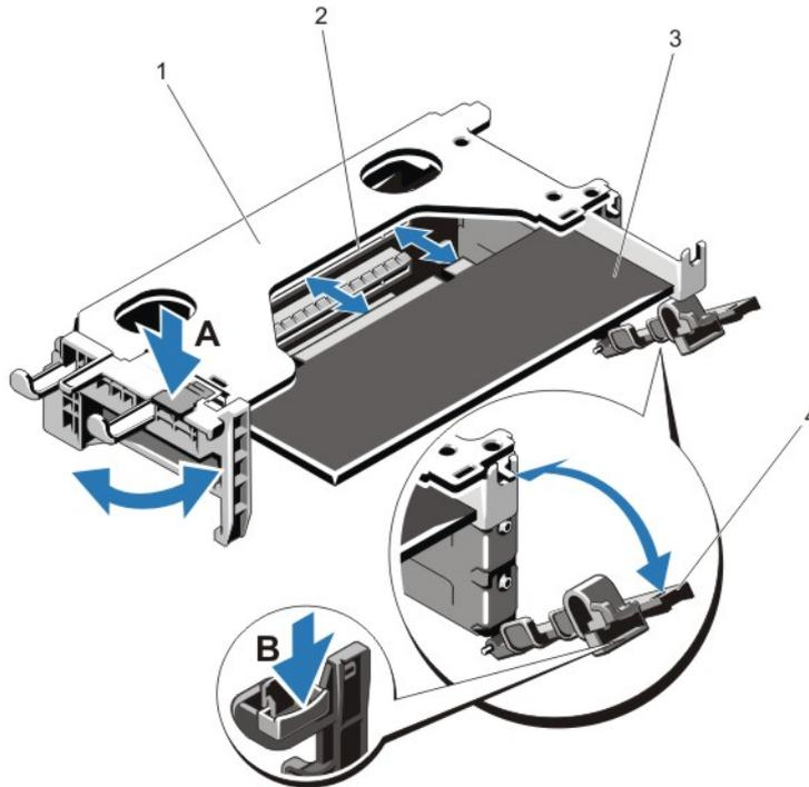
**Ilustración 23. Extracción e instalación de la tarjeta vertical de expansión 1**
