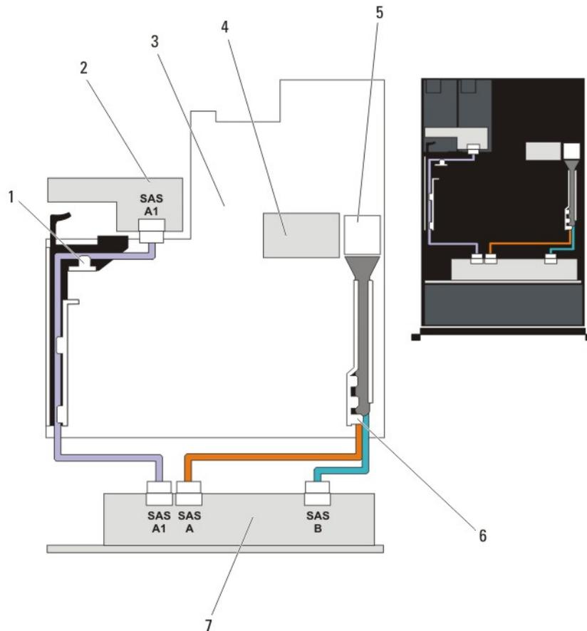
**Ilustración 47. Diagrama de cableado: plano posterior de la unidad de disco duro (x2) opcional de 2,5 pulgadas (atrás)**
