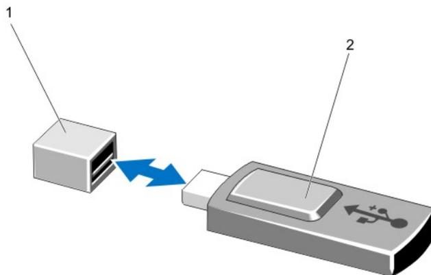
**Ilustración 18. Sustitución de la memoria USB interna**
