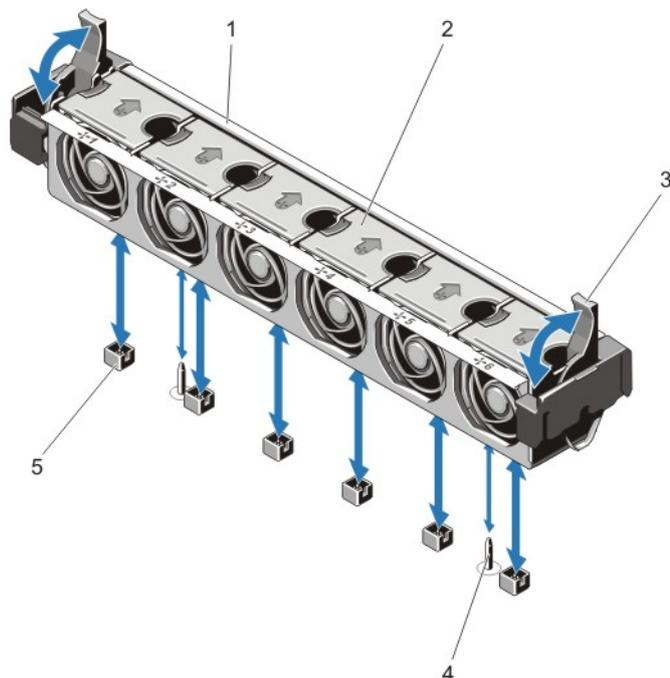
**Ilustración 17. Extracción e instalación del conjunto de ventiladores de refrigeración**
