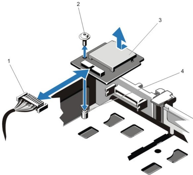
**Ilustración 31. Extracción e instalación de una unidad multimedia vFlash**
