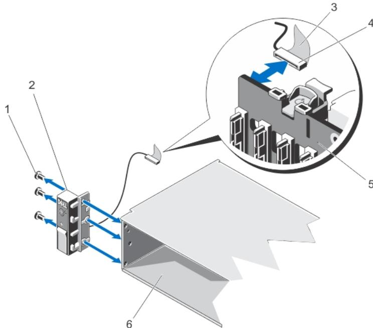
**Ilustración 48. Extracción e instalación del panel de control**
