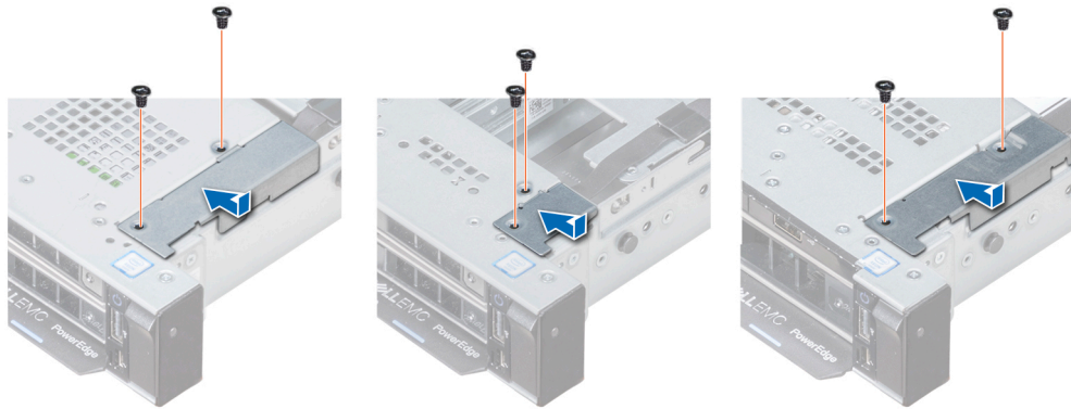
Figura 110. Instalación de la cubierta de cables
