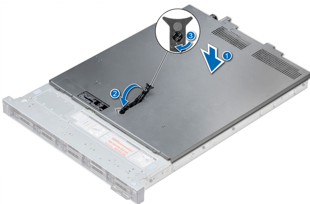
Figura 20. Instalación de la cubierta del sistema
