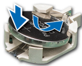
Figura 94. Instalación de la batería del sistema
