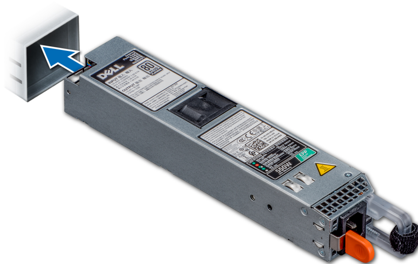
Figura 100. Instalación de una unidad de fuente de alimentación
