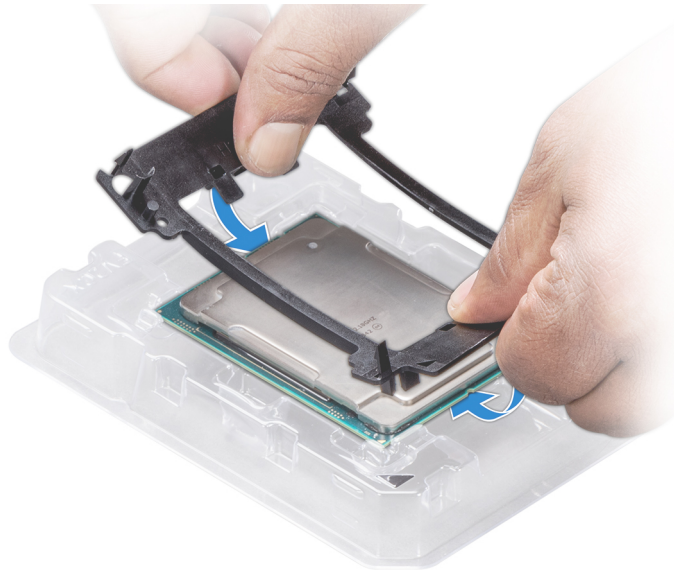
Figura 46. Instalación del soporte del procesador
