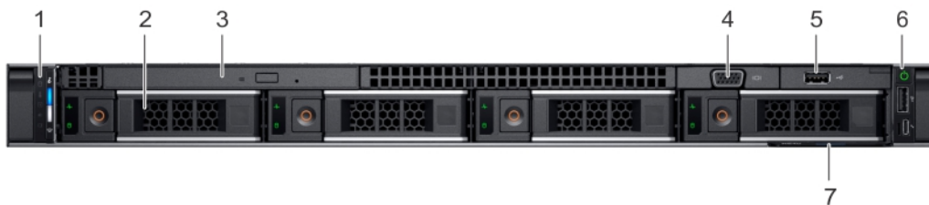
Figura 2. Vista frontal del sistema de 4 unidades de 3,5 pulgadas
