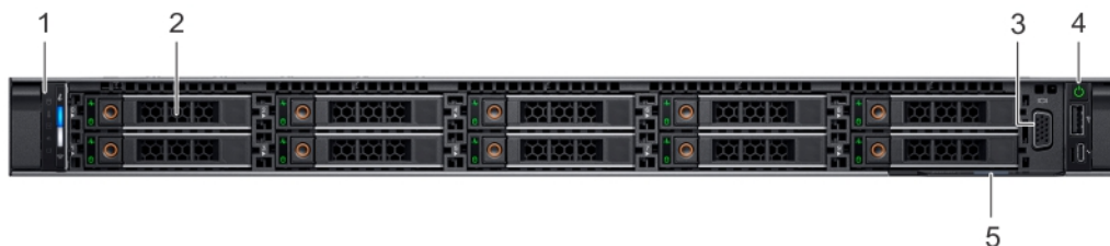
Figura 3. Vista frontal del sistema de 10 unidades de 2,5 pulgadas
