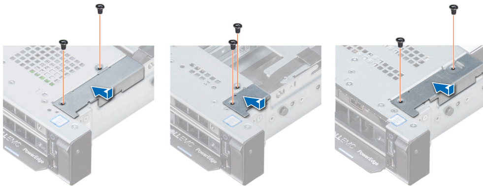
Abbildung 111. Installieren der Kabelabdeckung
