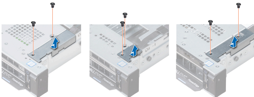
Abbildung 109. Entfernen der Kabelabdeckung
