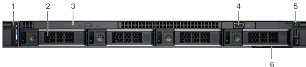
Abbildung 2. Frontansicht eines Systems mit 4 x 3,5-Zoll-Laufwerken
