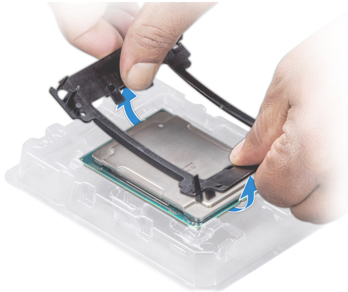
Abbildung 44. Entfernen der Prozessorhalterung
