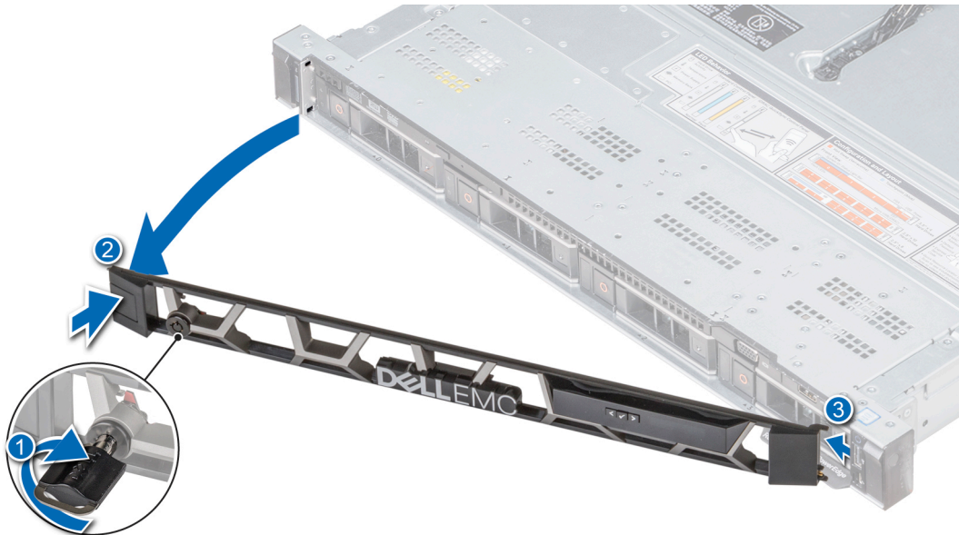
Abbildung 16. Entfernen der Frontblende mit LCD-Display
