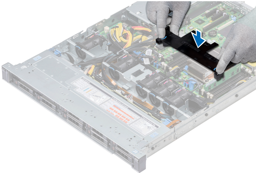
Abbildung 24. Installieren des Kühlgehäuses
