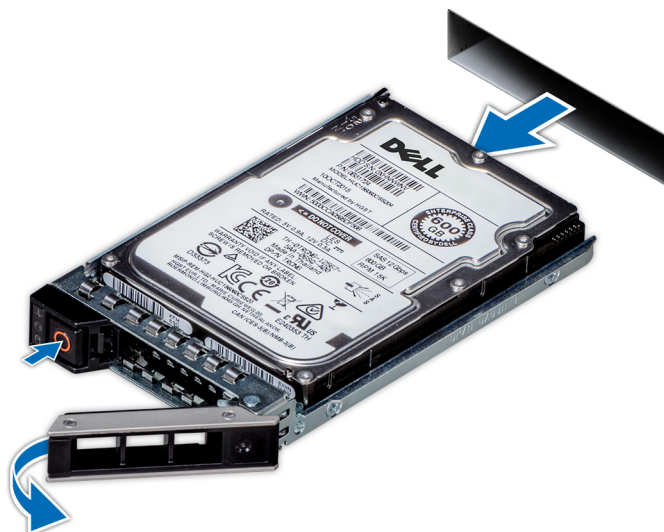
Ilustración 35. Extracción de una unidad de disco duro
