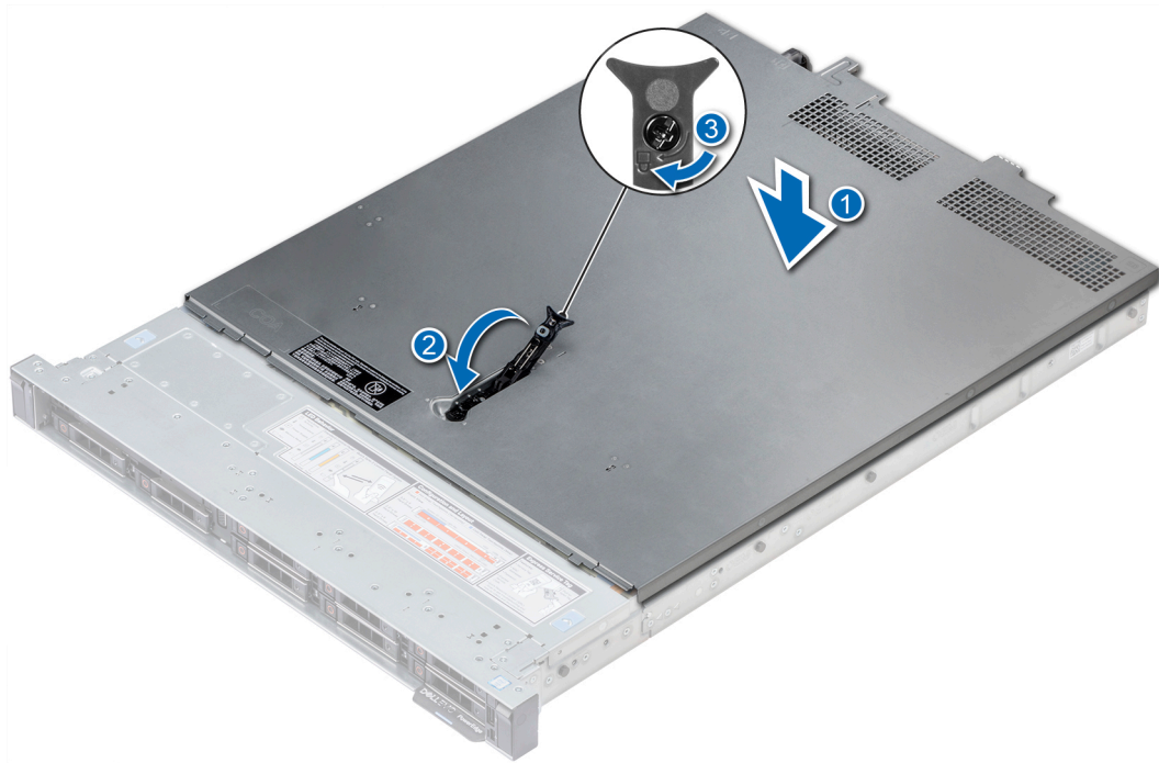
Ilustración 19. Instalación de la cubierta del sistema
