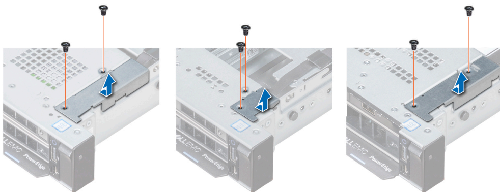
Ilustración 109. Extracción de la cubierta de cables
