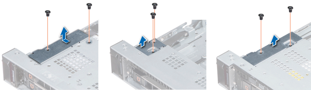
Ilustración 106. Extracción de la cubierta de cables
