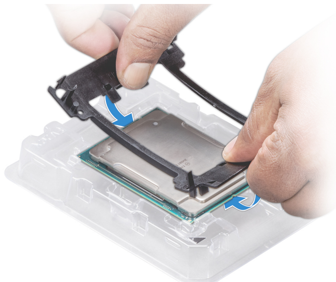
Ilustración 45. Instalación del soporte del procesador
