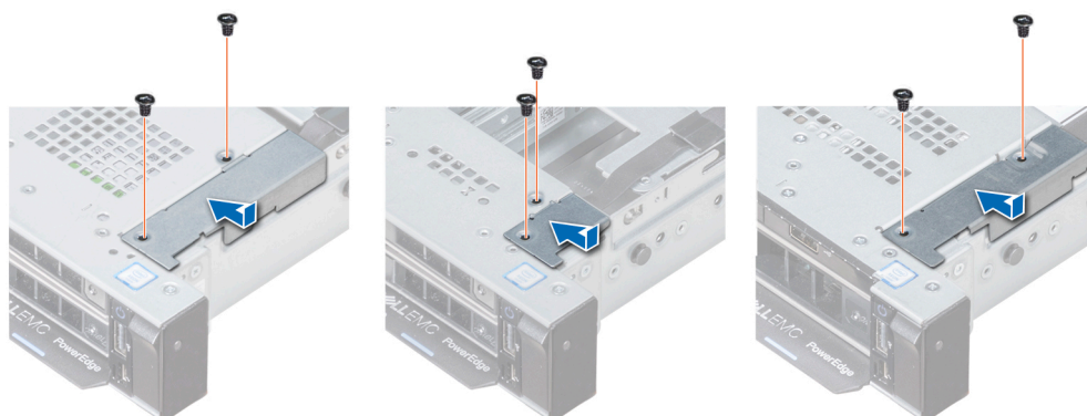
Ilustración 111. Instalación de la cubierta de cables
