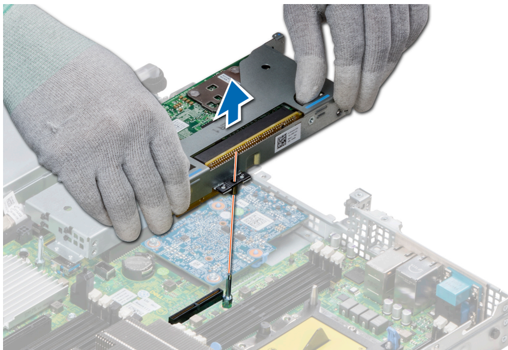
Ilustración 58. Extracción de un soporte vertical para tarjetas de expansión 1
