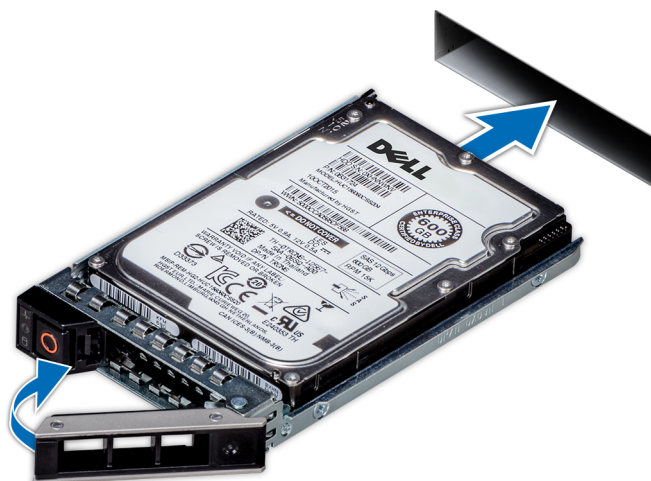
Ilustración 36. Instalación de una unidad de disco duro
