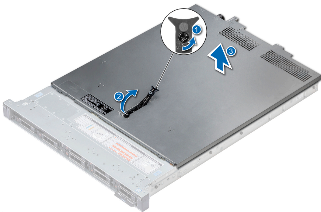
Ilustración 18. Extracción de la cubierta del sistema
